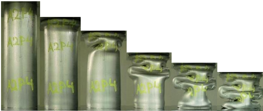
Εικόνα 88: Διαδοχικές όψεις κατάρρευσης πειράματος
