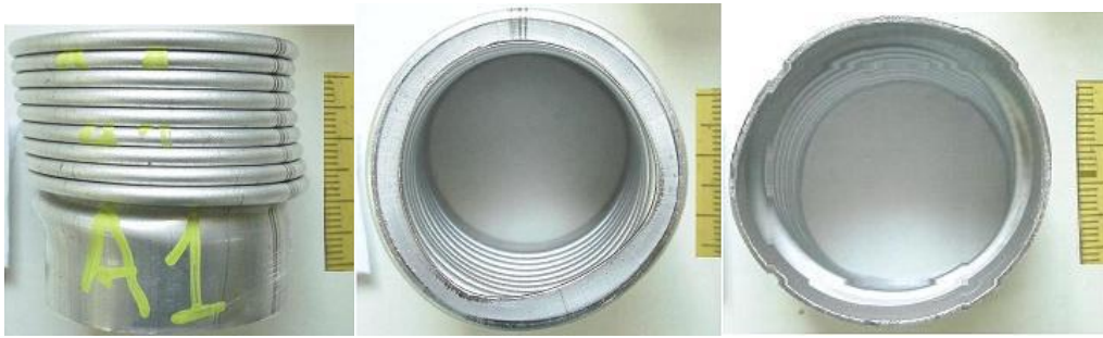
Εικόνα 20: Τελικές όψεις κατάρρευσης πειράματος(πρόσωση, κάτοψη και άνοψη).
