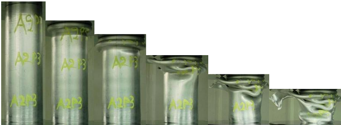
Εικόνα 80: Διαδοχικές όψεις κατάρρευσης πειράματος
