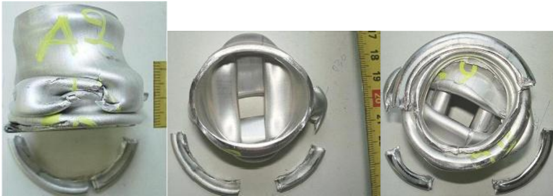
Εικόνα 60: Τελικές όψεις κατάρρευσης πειράματος(πρόσωση, κάτοψη και άνοψη).
