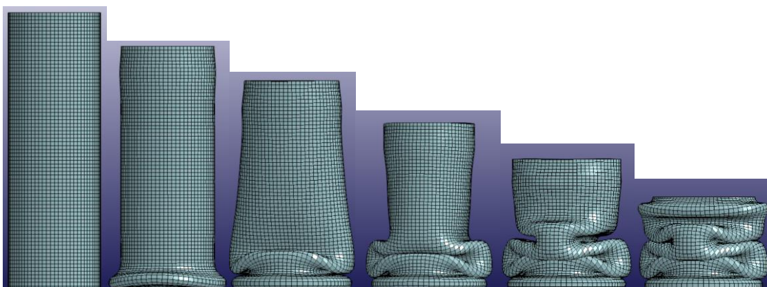
Εικόνα 82: Διαδοχικές όψεις κατάρρευσης προσομοίωσης με solid elements.
