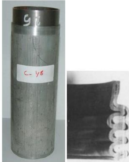
Εικόνα 4: Κυλινδρικά κελύφη αποτελούμενα από δύο επάλληλα υλικά πριν και μετά την κατάρρευση [3].
