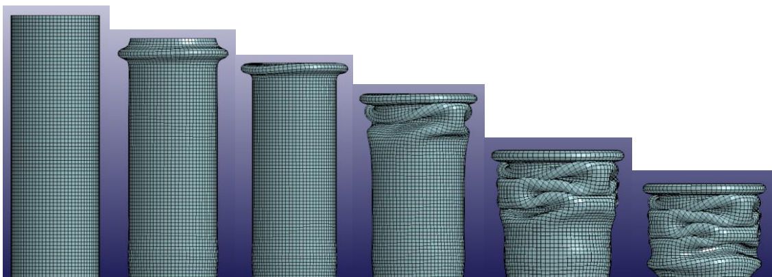
Εικόνα 43: Διαδοχικές όψεις κατάρρευσης προσομοίωσης με solid elements.
