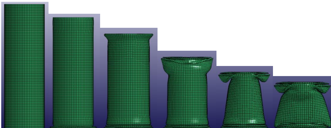
Εικόνα 89: Διαδοχικές όψεις κατάρρευσης προσομοίωσης με shell elements.
