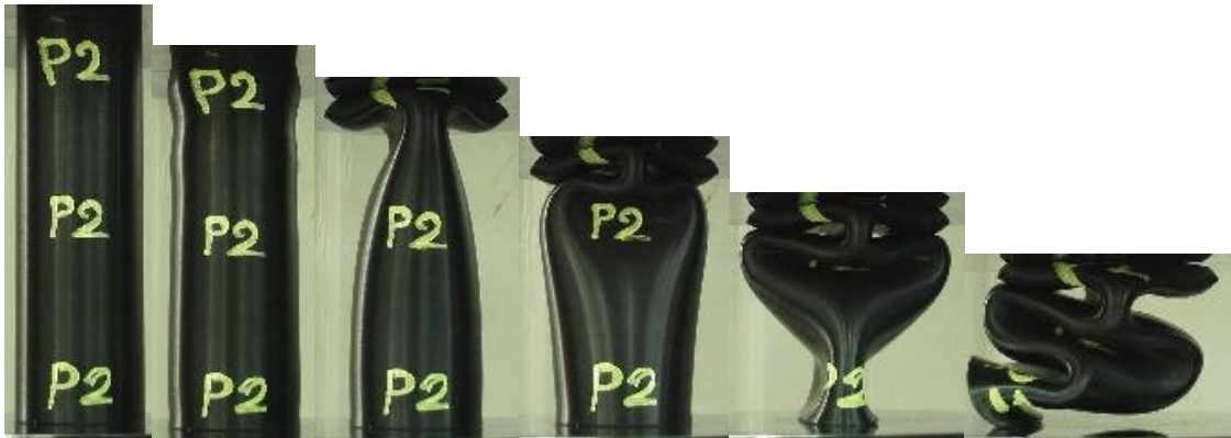
Εικόνα 33: Διαδοχικές όψεις κατάρρευσης πειράματος.
