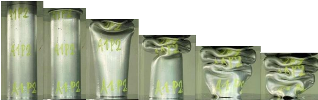
Εικόνα 49: Διαδοχικές όψεις κατάρρευσης πειράματος.
