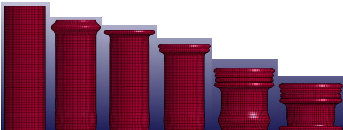
Εικόνα 59: Διαδοχικές όψεις κατάρρευσης προσομοίωσης με solid elements.
