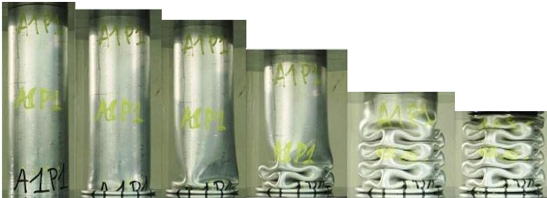
Εικόνα 41: Διαδοχικές όψεις κατάρρευσης πειράματος.
