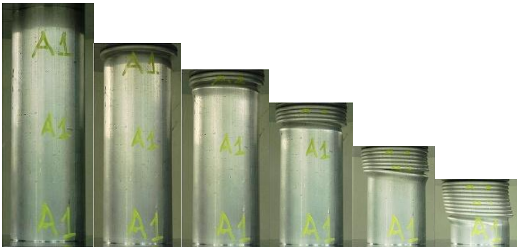
Εικόνα 17: Διαδοχικές όψεις κατάρρευσης πειράματος.
