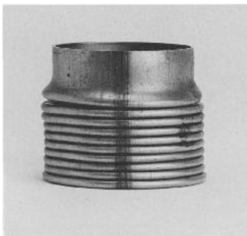
Εικόνα 1: Αξονοσυμμετρικός τρόπος κατάρρευσης
