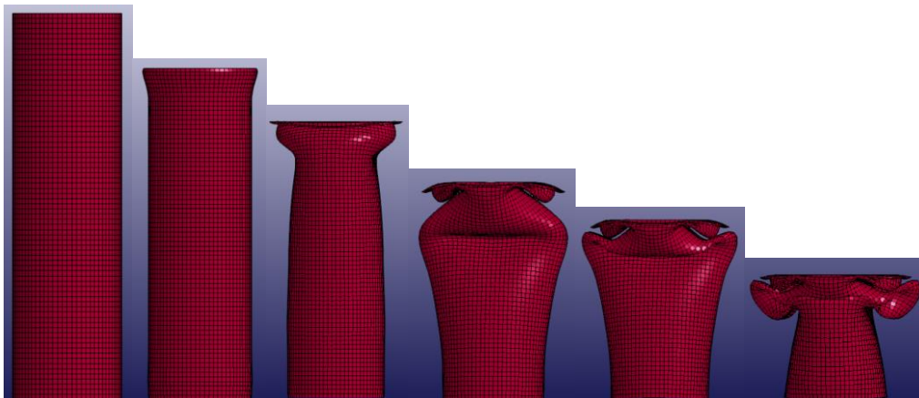
Εικόνα 74: Διαδοχικές όψεις κατάρρευσης προσομοίωσης με shell elements.
