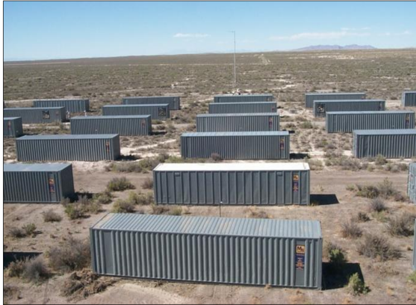
Σχήμα 4.2. : Απεικόνιση της γεωμετρικής διάταξης των κοντέινερ κατά τη διάρκεια του πειράματος MUST. (Ευθυμίου Γ.Χ, 2012)
