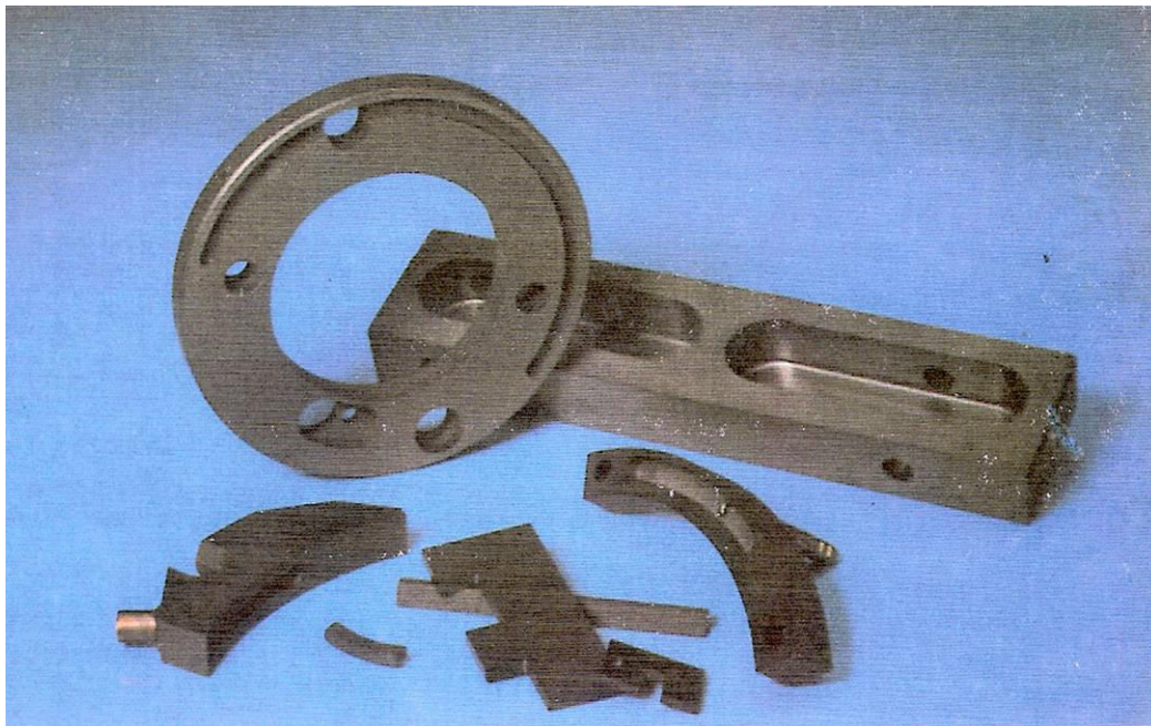
Σχήμα 6.4: Πτερύγια αντλιών-συμπιεστών και διανομείς αέρος
