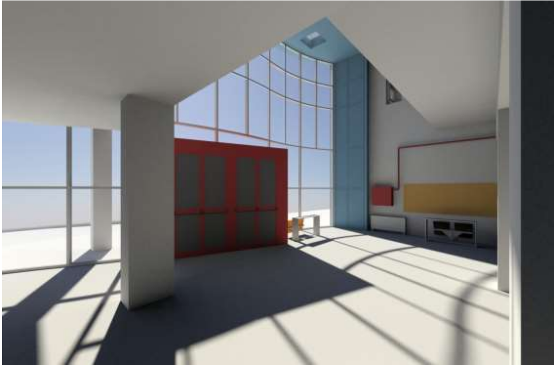
Εικόνα 99: Προσομοίωση του ηλιασμού του κεντρικού πυρήνα στις 21/4 (ώρα 15:30), όπως είναι σήμερα
