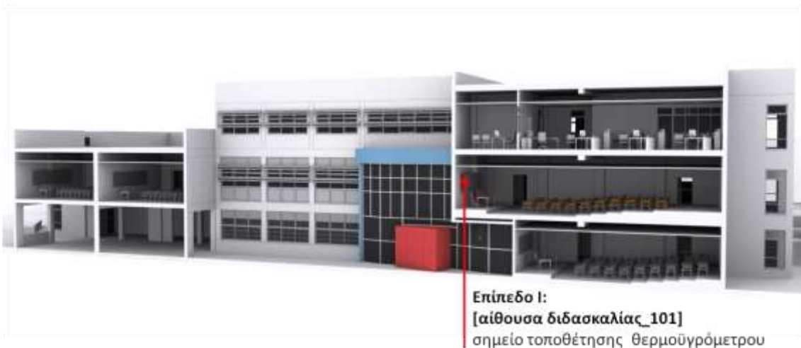
Εικόνα 52: Επίπεδο I_αίθουσα διδασκαλίας [101]: σημείο τοποθέτησης θερμοϋγρόμετρου
