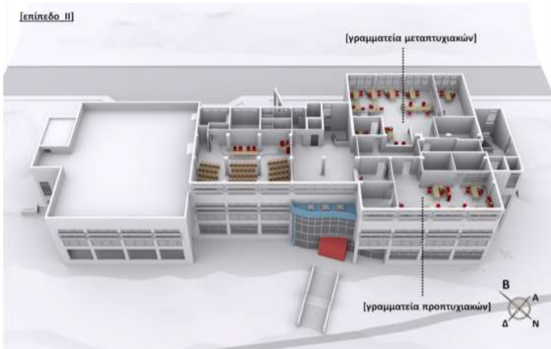
Εικόνα 65: [Επίπεδο_II]: Τρισδιάστατη κάτοψη των χώρων διοίκησης [ΝΔ χώρος: τμήμα προπτυχιακών] & [ΒΑ χώρος: τμήμα μεταπτυχιακών σπουδών]
