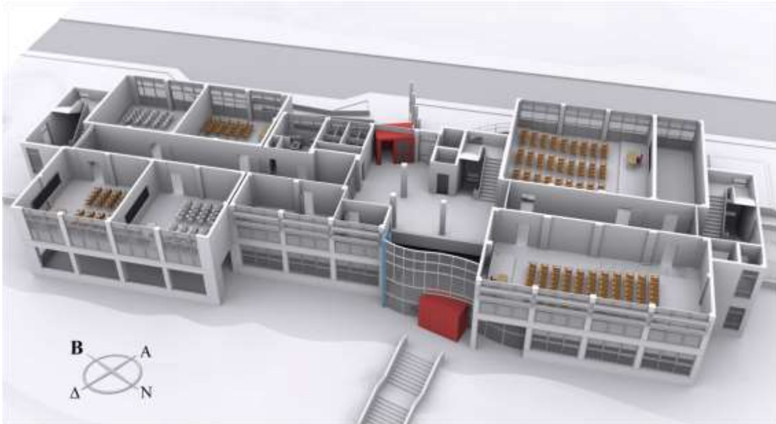
Εικόνα 49: [Επίπεδο_I]: Χώροι τοποθέτησης θερμοϋγρόμετρων
