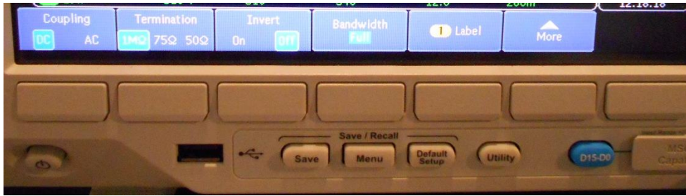
ΕΙΚΟΝΑ 4- 17 : ΜΕΝΟΥ ΡΥΘΜΙΣΕΩΝ ΓΙΑ ΤΑ ΚΑΝΑΛΙΑ ΤΟΥ ΠΑΛΜΟΓΡΑΦΟΥ.
