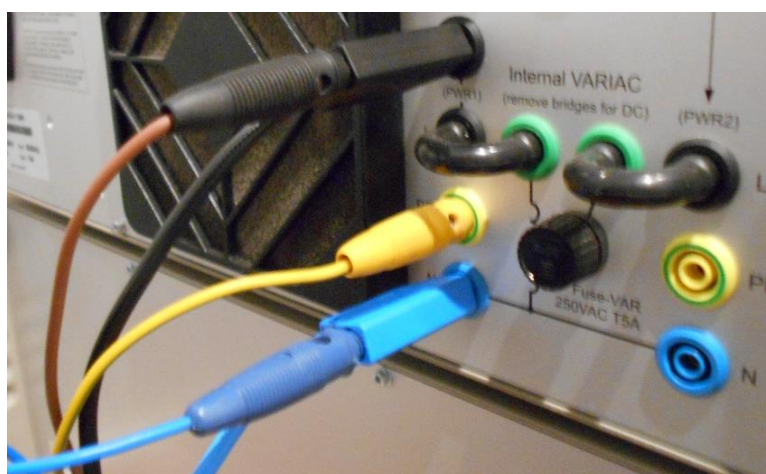
ΕΙΚΟΝΑ 4- 6 : ΣΥΝΔΕΣΗ ΚΑΤΑΜΕΡΙΣΤΗ ΣΤΟ ΠΙΣΩ ΜΕΡΟΣ ΤΗΣ ΓΕΝΝΗΤΡΙΑΣ.
