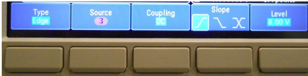
ΕΙΚΟΝΑ 4- 19 : ΜΕΝΟΥ ΡΥΘΜΙΣΕΩΝ ΓΙΑ ΤΟΝ ΕΞΩΤΕΡΙΚΟ ΣΚΑΝΔΑΛΙΣΜΟ (TRIGGER).
