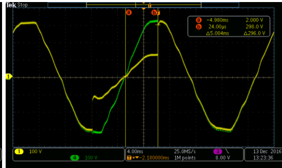
ΕΙΚΟΝΑ 4- 47 : ΚΥΜΑΤΟΜΟΡΦΗ ΔΟΚΙΜΗΣ ΑΠΟ 40% ΣΕ 100% ΣΤΙΣ 90°.
