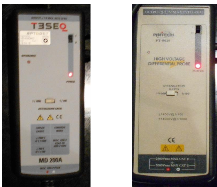
ΕΙΚΟΝΑ 4-9 : ΟΙ ΚΑΤΑΜΕΡΙΣΤΕΣ ΠΟΥ ΧΡΗΣΗΜΟΠΟΙΗΘΗΚΑΝ ΓΙΑ ΤΗ ΔΙΕΞΑΓΩΓΗ ΤΗΣ ΔΟΚΙΜΗΣ.
