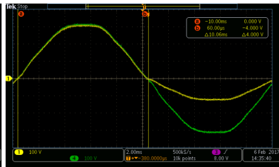
ΕΙΚΟΝΑ 4- 49 : ΚΥΜΑΤΟΜΟΡΦΗ ΔΟΚΙΜΗΣ ΑΠΟ 40% ΣΕ 100% ΣΤΙΣ 270°.
