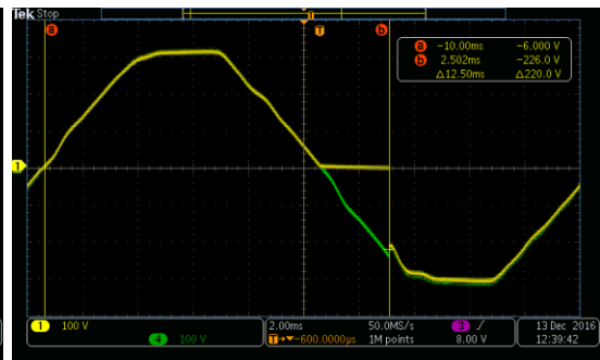
ΕΙΚΟΝΑ 4- 43 : ΚΥΜΑΤΟΜΟΡΦΗ ΔΟΚΙΜΗΣ ΑΠΟ 0% ΣΕ 100% ΣΤΙΣ 225°.
