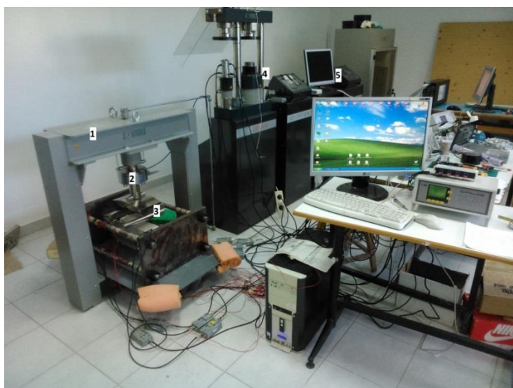
Σχήμα 7.5: (1) Πλαίσιο κάμψης της CONTROLS, (2) Κελί φορτίου συσκευής κάμψης, (3) Κύλιστρα φόρτισης, (4) Πλαίσιο φόρτισης για δοκιμές χαρακτηρισμού μονοαξονικής θλίψης και δοκιμές αντιδιαμετρικής θλίψης, (5) Κεντρική μονάδα ελέγχου.
