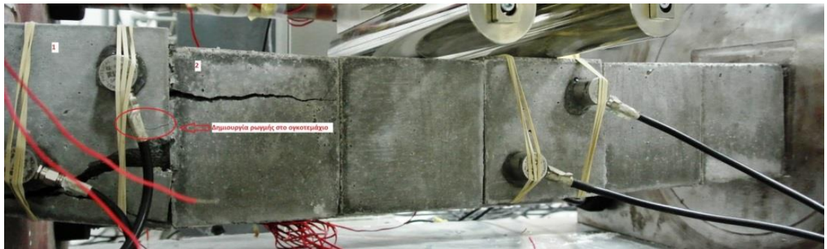
Σχήμα 7.56.Δημιουργία ρωγμής στο ογκοτεμάχιο 1.
