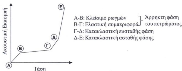
Σχήμα 3.19. Γενική σχέση εφαρμοζόμενης τάσης και ακουστικής εκπομπής του πετρώματος και συσχέτισή της με τη διαδικασία καταστροφής κατά την δοκιμή μονοαξονικής θλίψης. Στη μηχανική των πετρωμάτων το φαινόμενο της ΑΕ παρουσιάζει ιδιαίτερο ενδιαφέρον («Πρόγραμμα ενίσχυσης βασικής έρευνας Π.Ε.Β.Ε.-Ε.Μ.Π.», Μάϊος 2012).
