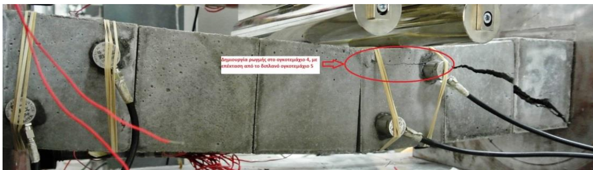
Σχήμα 7.69.Δημιουργία ρωγμής στο ογκοτεμάχιο 4 πάνω από τον αισθητήρα και περαιτέρω άνοιγμα των προϋπαρχουσών ρωγμών στα ογκοτεμάχια 5 και 6.
