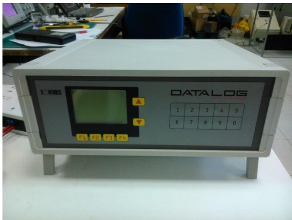
Σχήμα 7.18.Το οκτακάναλο καταγραφικό (Datalogger) της εταιρείας CONTROLS.
