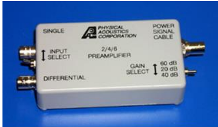
Σχήμα 3.9. Ένας εκ των προενισχυτών 2/4/6 που διαθέτει το εργαστήριο Τεχνολογίας Διάνοιξης Σηράγγων, οι οποίοι χρησιμοποιήθηκαν στις εργαστηριακές δοκιμές («Πρόγραμμα ενίσχυσης βασικής έρευνας Π.Ε.Β.Ε.-Ε.Μ.Π.», Μάιος 2012).
