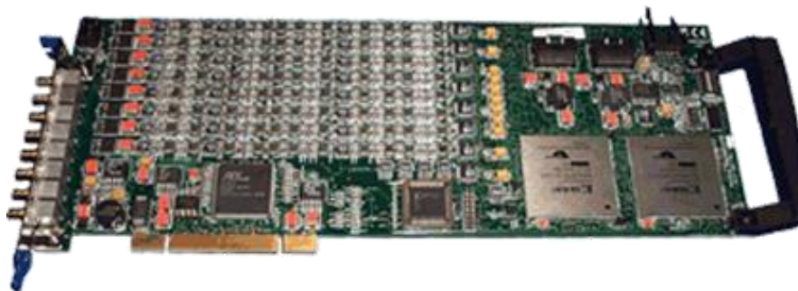
Σχήμα 3.11. Ψηφιακό σύστημα καταγραφής δεδομένων ΑΕ οκτώ (8) καναλιών PCI-8, διαθέσιμο στο Εργαστήριο Τεχνολογίας Διάνοιξης Σηράγγων («Πρόγραμμα ενίσχυσης βασικής έρευνας Π.Ε.Β.Ε.-Ε.Μ.Π.»), Μάϊος 2012).
