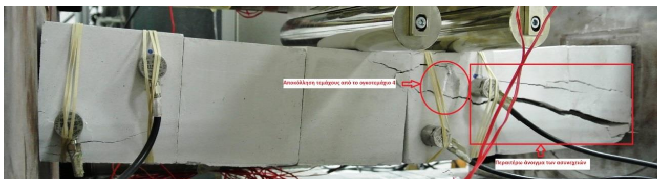
Σχήμα 7.48. Περαιτέρω άνοιγμα ρωγμών στα ογκοτεμάχια 5 και 6, επέκταση ρωγμών και αποκόλληση τεμάχους από ογκοτεμάχιο 4.
