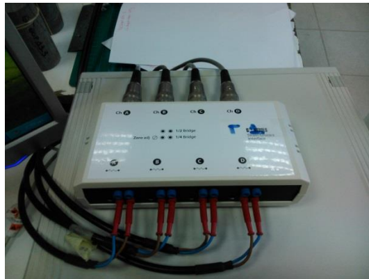
Σχήμα 7.17.Τετρακάναλη γέφυρα της Controls.
