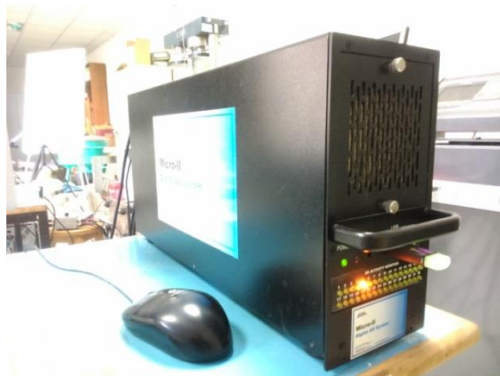
Σχήμα 7.23. Το καταγραφικό Micro-II, που χρησιμοποιείται για την συλλογή των δεδομένων ακουστικής εκπομπής.
