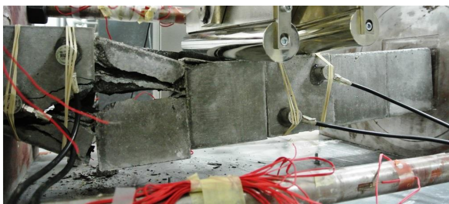
Σχήμα 7.63.Η τελική μορφή της δοκού μετά την αστοχία.
