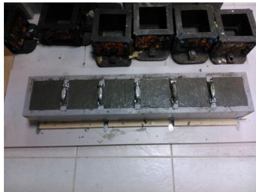
Σχήμα 6.10.Διακρίνεται το ίδιο καλούπι, από το οποίο παρασκευάσαμε τα δοκίμια γύψου,να χρησιμοποιείται για παρασκευή δοκιμών τσιμέντου.
