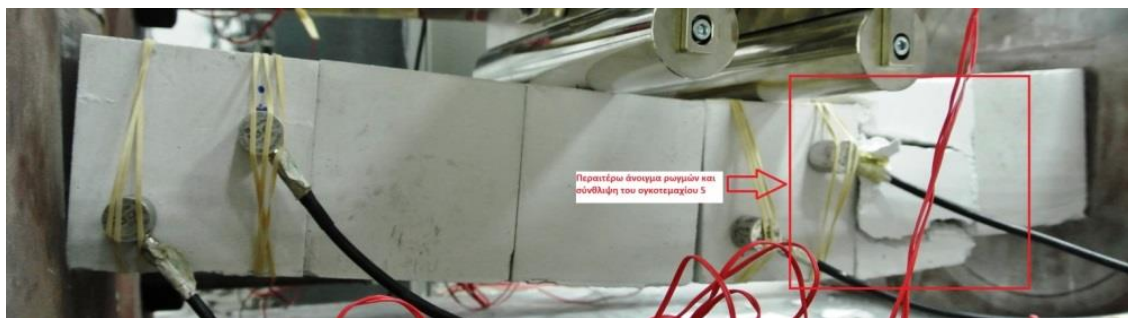
Σχήμα 7.38. Περαιτέρω άνοιγμα ρωγμών και σύνθλιψη του ογκοτεμαχίου 5.
