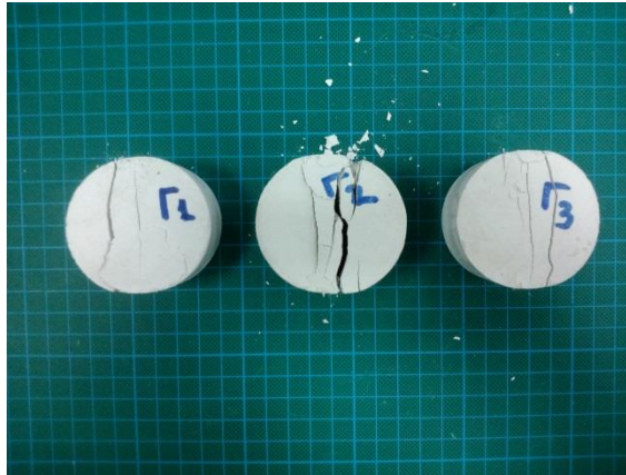
Σχήμα 6.8.Τα δοκίμια γύψου μετά την αστοχία τους.
