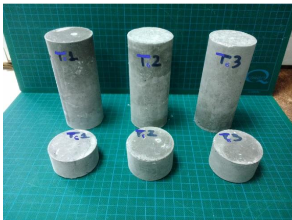
Σχήμα 6.11. Διακρίνονται πίσω τα 3 μεγάλα κυλινδρικά δοκίμια που θα χρησιμοποιηθούν για δοκιμή μονοαξονικής θλίψης και μπροστά τα 3 δοκίμια για δοκιμή Brazilian.
