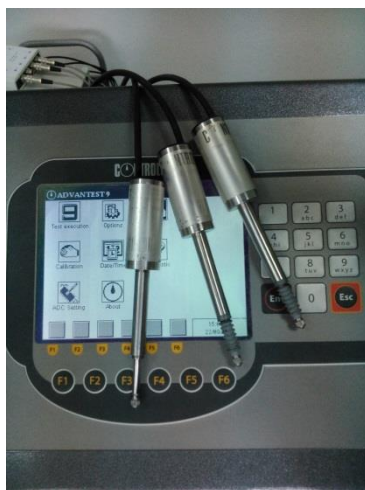
Σχήμα 6.5. Τα 3 βελόμετρα που χρησιμοποιήθηκαν για την μέτρηση της αξονικής τροπής.
