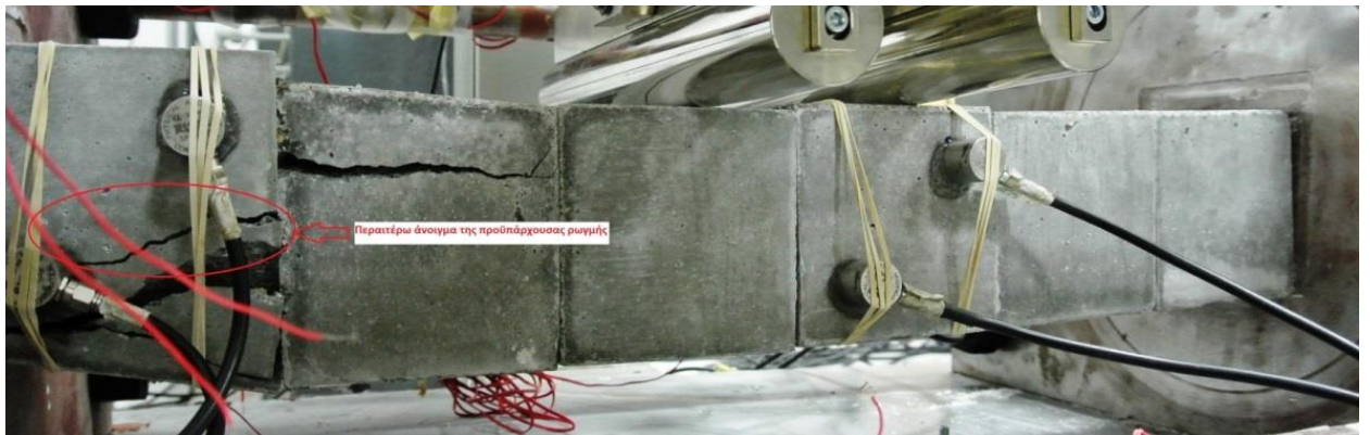
Σχήμα 7.59. Δημιουργία ρωγμής στο κάτω τμήμας του ογκοτεμαχίου 1 και περαιτέρω μετατόπιση του.
