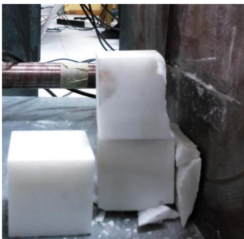
Σχήμα 7.79. Διακρίνονται τα ογκοτεμάχια 11 και 12. Το 12 έσπασε σε τρία κομμάτια και στο 11 αποκολλήθηκε ένα πολύ μικρό κομμάτι στο κάτω μέρος.
