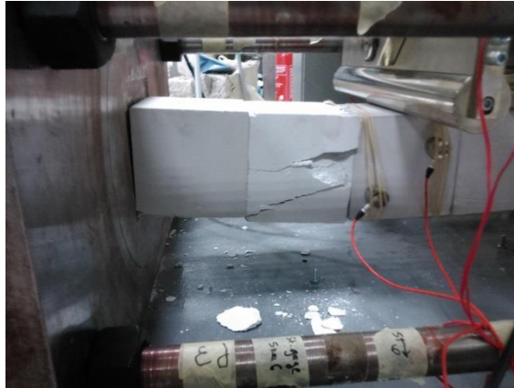
Σχήμα 7.31. Επέκταση των 2 ρωγμών και στην πίσω πλευρά και απόσπαση 2 κομματιών.
