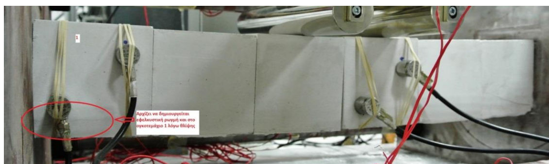
Σχήμα 7.41. Διακρίνεται η δημιουργία εφελκυστικής ρωγμής στο ογκοτεμάχιο 1.
