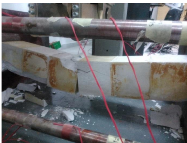
Σχήμα 7.9. Η δοκός μετά το πέρας του πειράματος όπου φαίνονται οι περιοχές αστοχίας, στο πάνω μέρος της κεντρικής ασυνέχειας και στο κάτω μέρος των άκρων.
