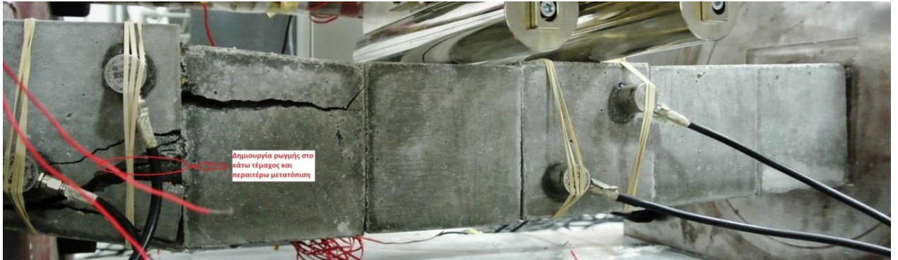
Σχήμα 7.58. Δημιουργία ρωγμής στο κάτω τμήμας του ογκοτεμαχίου 1 και περαιτέρω άνοιγμα της προηγούμενης ρωγμής του σχήματος 7.57.
