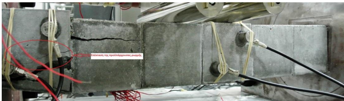
Σχήμα 7.57.Επέκταση της προϋπάρχουσας ρωγμής
