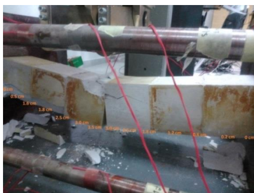
Σχήμα 7.16.Διακρίνονται τα βέλη κάμψης των τεμαχίων της δοκού voussoir.
