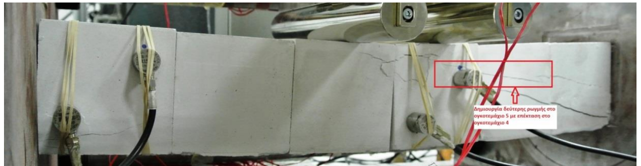
Σχήμα 7.46. Δημιουργία δεύτερης ρωγμής στο ογκοτεμάχιο 5, και επέκτασή της στο ογκοτεμάχιο 4.
