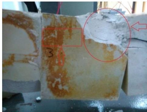
Σχήμα 7.12.Ογκοτεμάχιο γύψου 3, αριστερά της κεντρικής ασυνέχειας.
