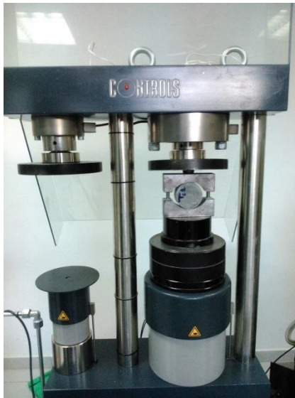
Σχήμα 6.16.Αριστερά το πλαίσιο φόρτισης και δεξιά διακρίνονται οι σιαγόνες φόρτισης που συγκρατούν το δοκίμιο.
