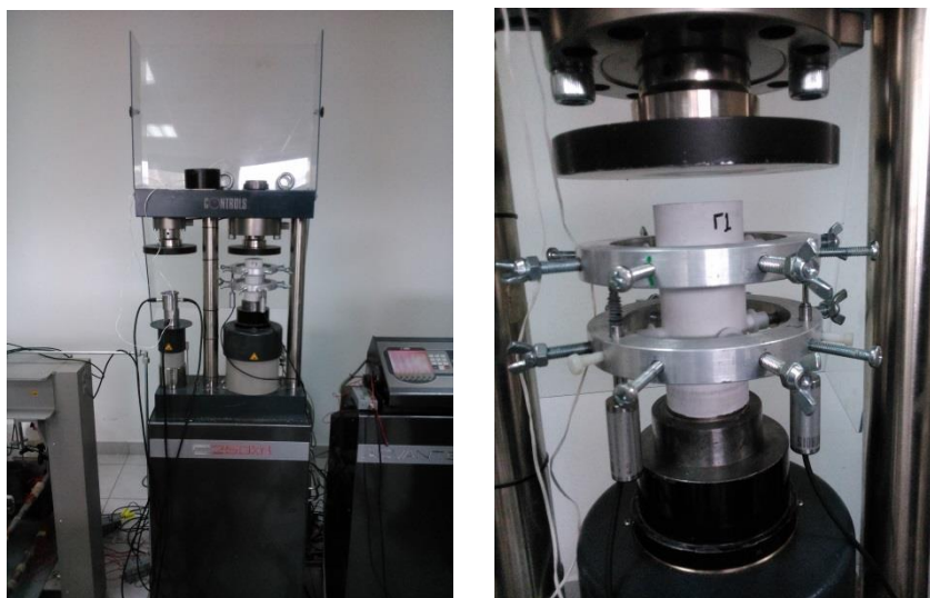
Σχήμα 6.4. (α) Αριστερά, το πλαίσιο φόρτισης για την εκτέλεση της δοκιμής, (β) Η ειδική διάταξη σχεδιασμένη από τον κ.Κοτσάνη Δημήτριο.
