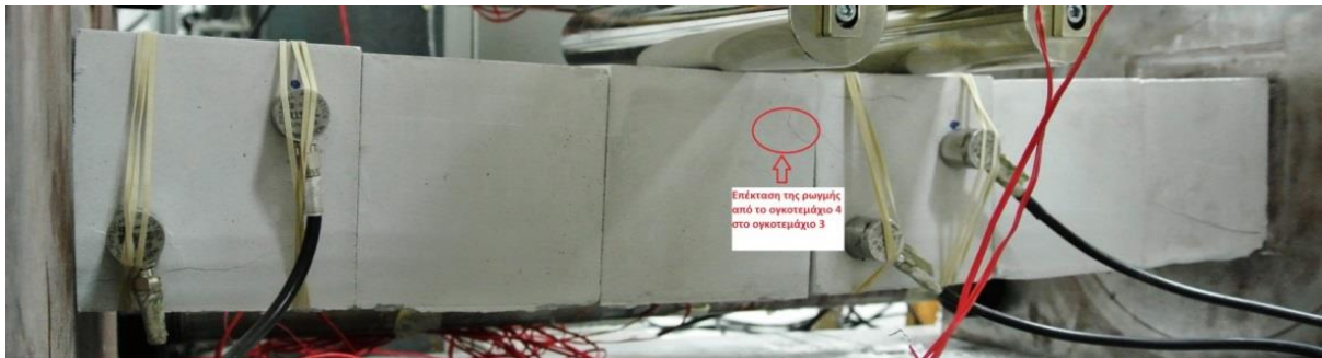
Σχήμα 7.43.Επέκταση της εφελκυστικής ρωγμής στο ογκοτεμάχιο 3, από το ογκοτεμάχιο 4.
