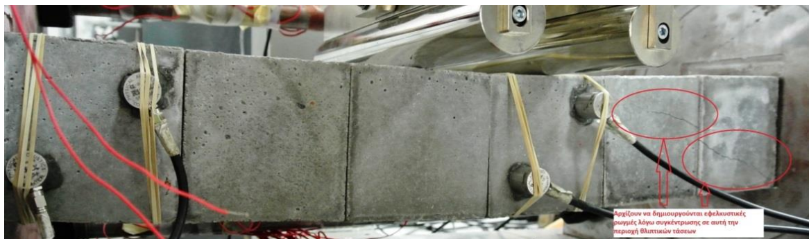
Σχήμα 7.66. Αρχίζουν να δημιουργούνται εφελκυστικές ρωγμές στα ογκοτεμάχια 5 και 6.
