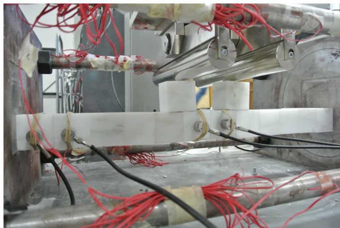
Σχήμα 7.77. Διακρίνονται τα 2 κυβικά ογκοτεμάχια κάτω από τα κύλινδρα φόρτισης.
