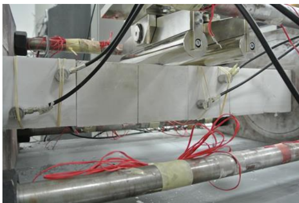
Σχήμα 7.24. Η ρωγματοωμένη δοκός τοποθετημένη στην πειραματική διάταξη μαζί με τους αισθητήρες.
