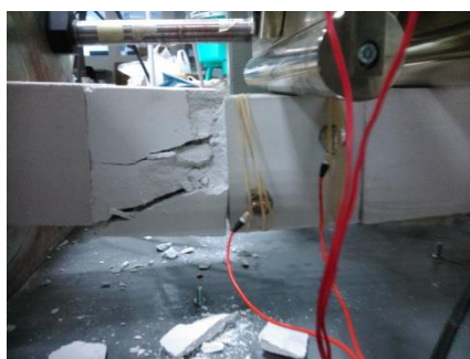
Σχήμα 7.33. Αποκόλληση κομματιού από την πίσω πλευρά του ογκοτεμαχίου 5.
