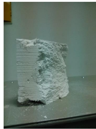
Σχήμα 7.39(α) Τελική κατάσταση της δοκού μετά την κατάρρευση, (β) Διακρίνεται η επιφάνεια ολίσθησης του πάνω τεμαχίου, που διέρρευσε πλαστικά για την δημιουργία σκαλοπατιού.
