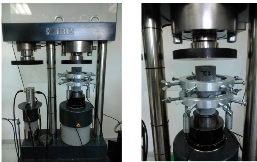
Σχήμα 6.13.(α) Αριστερά, το πλαίσιο φόρτισης για την εκτέλεση της δοκιμής, (β) Η ειδική διάταξη σχεδιασμένη από τον κ.Κοτσάνη Δημήτριο.
