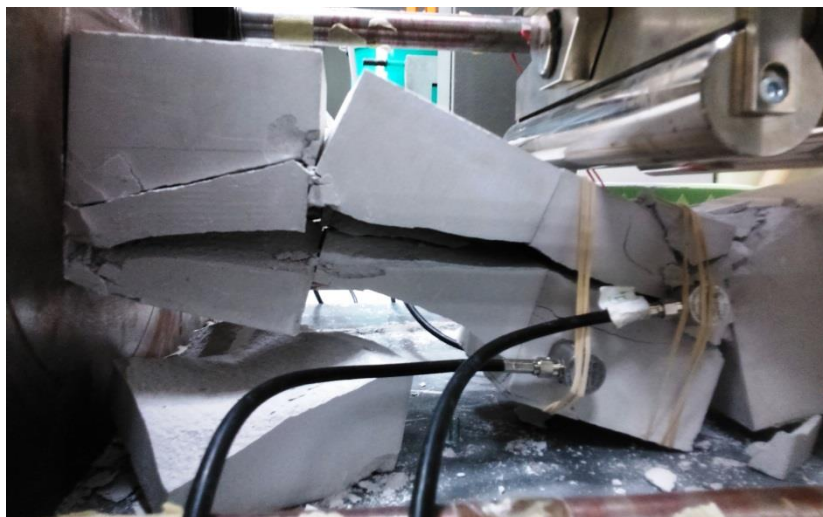
Σχήμα 7.51. Η μορφή της αστοχίας της δοκού στα ογκοτεμάχια 4,5 και 6 από την πίσω πλευρά.
