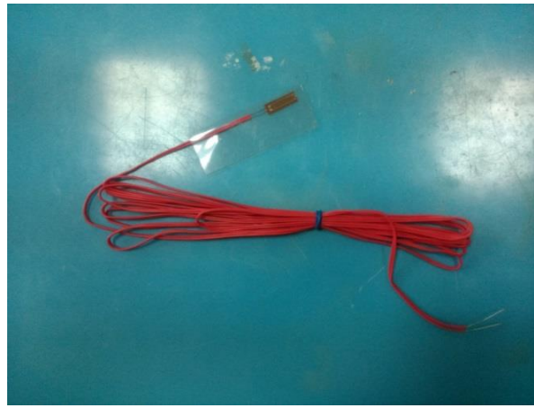
Σχήμα 7.3. Strain gauge αλουμινίου της εταιρείας Tokyo Sokki Kenkyujo, που χρησιμοποιήθηκε για την μέτρηση της καμπτικής καταπόνησης και στις 4 μεταλλικές ράβδους της πειραματικής διάταξης.
