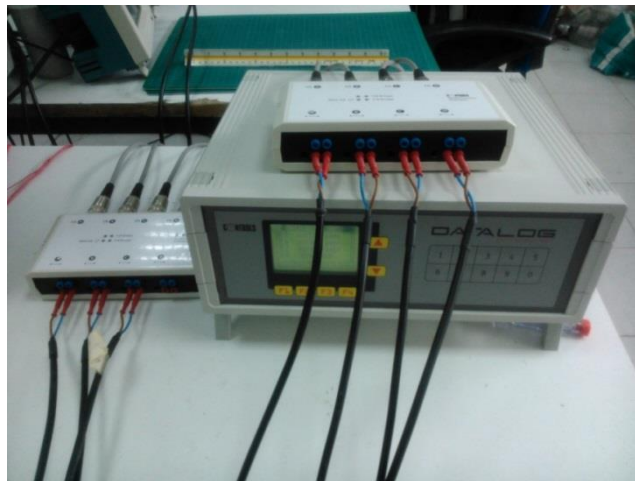
Σχήμα 7.7. Απεικονίζονται οι δύο γέφυρες Wheatstone αριστερά και πάνω στο καταγραφικό (Datalogger) της CONTROLS.
