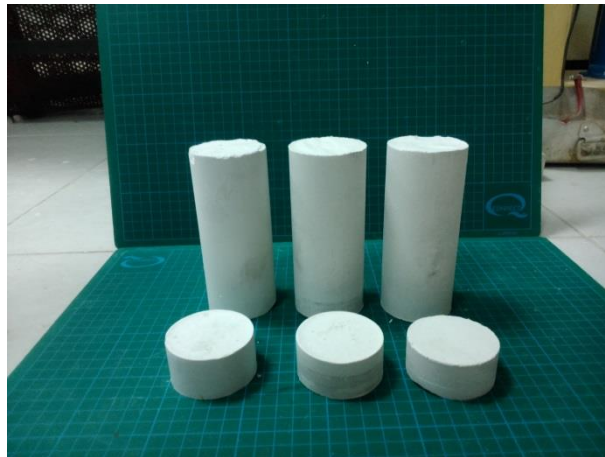
Σχήμα 6.3.3 Κυλινδρικά δοκίμια γύψου στο βάθος για δοκιμή χαρακτηρισμού μονοαξονικής θλίψης και 3 κυλινδρικά δοκίμια γύψου (μπροστά) για Brazilian test.
