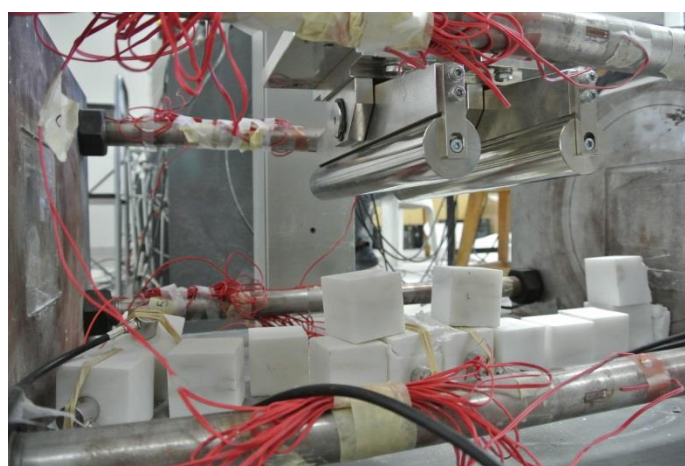
Σχήμα 7.78. Η τελική εικόνα της δοκού μετά την κατάρρευση.
