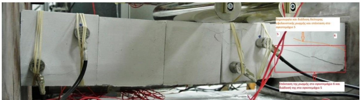
Σχήμα 7.45.Δημιουργία δεύτερης ρωγμής στο ογκοτεμάχιο 6, και επέκταση ρωγμής στο ογκοτεμάχιο 5, με αντίστοιχη επέκταση και διάδοση προϋπαρχουσών ρωγμών.
