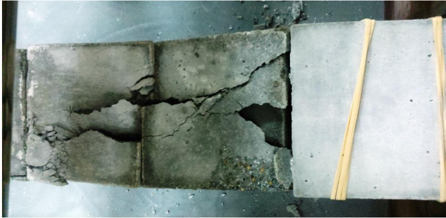
Σχήμα 7.64. Διακρίνεται το πάνω μέρος της δοκού και τα ογκοτεμάχια 3,2 και 1 από αριστερά προς δεξιά.
