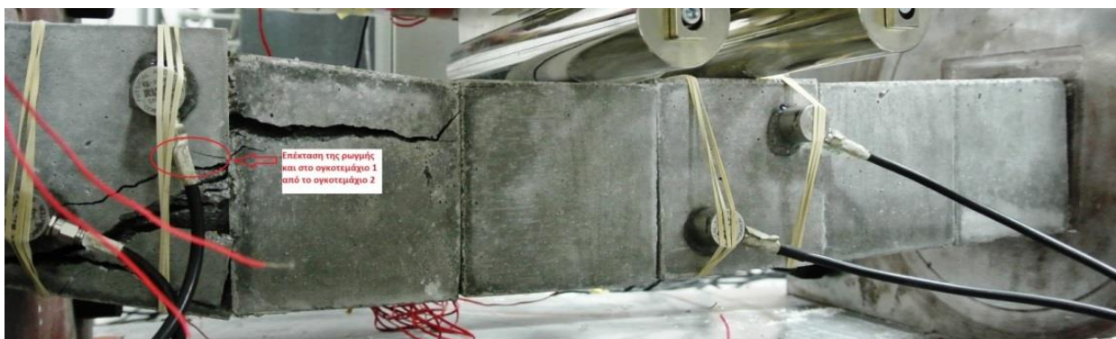
Σχήμα 7.61.Επέκταση της ρωγμής και στο ογκοτεμάχιο 1 από το ογκοτεμάχιο 2.
