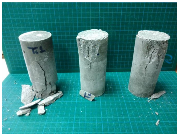
Σχήμα 6.15. Τα 3 κυλινδρικά δοκίμια τσιμέντου μετά το πέρας της δοκιμής και την αστοχία τους.
