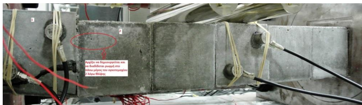
Σχήμα 7.54. Έναρξη εφελκυστικής ρωγμής στο ογκοτεμάχιο 2.
