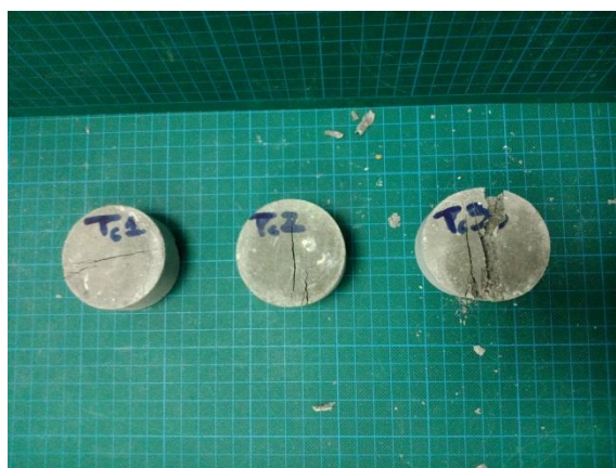
Σχήμα 6.17. Τα δοκίμια τσιμέντου μετά την αστοχία τους.
