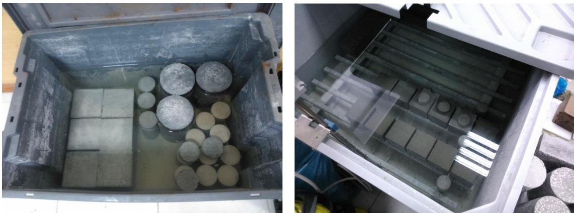
Σχήμα 6.12.(α) Διακρίνεται η μικρή δεξαμενή που διαθέτει το εργαστήριο, για την τοποθέτηση δοκιμίων τσιμέντου, για την απόκτηση της τελικής τους αντοχής.(β) Η μεγάλη δεξαμενή τοποθέτησης δοκιμίων τσιμέντου.
