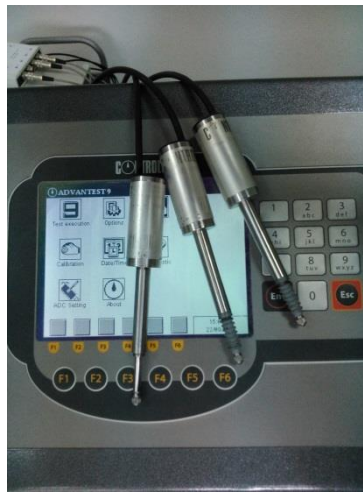
Σχήμα 6.14. Τα 3 βελόμετρα που χρησιμοποιήθηκαν για την μέτρηση της αξονικής τροπής.
