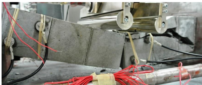
Σχήμα 7.72.Τελική μορφή αστοχίας της δοκού.
