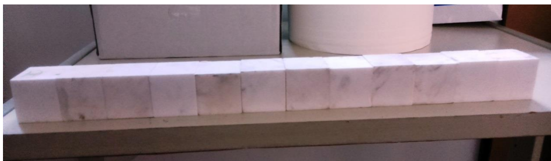
Σχήμα 6.19. Η δοκός μαρμάρου Βόλακα που θα χρησιμοποιηθεί στην δοκιμή και αποτελείται από 12 άρρηκτα κυβικά δοκίμια διαστάσεων 5cm x 5 cm 5 cm.
