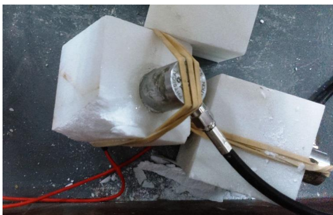
Σχήμα 7.80. Σπάσιμο του κάτω μέρους του ογκοτεμαχίου 1.
