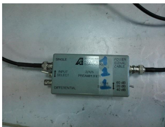
Σχήμα 7.22.Ο προενισχυτής στον οποίο συνδέεται ο αισθητήρας ακουστικής εκπομπής.
