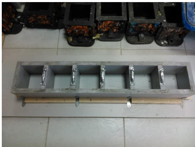
Σχήμα 6.1. Το καλούπι που χρησιμοποιήθηκε για την παρασκευή των δοκιμίων γύψου και τσιμέντου.
