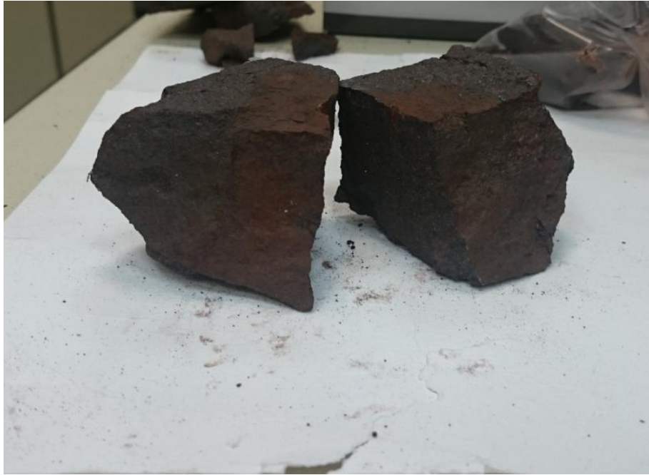
Εικόνα 5.9. Πλάγια όψη του δείγματος με αποδεκτό και εμφανή τρόπο σπασίματος κατά την αστοχία
