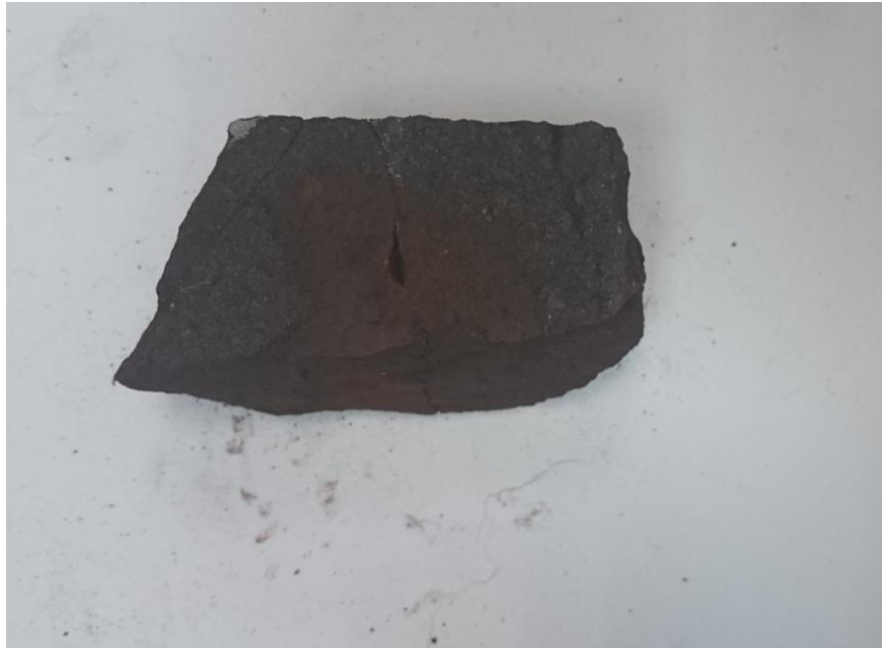
Εικόνα 5.7. Κάτοψη δείγματος με αποδεκτό τρόπο σπασίματος κατά την αστοχία
