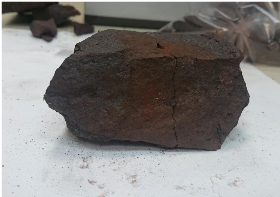
Εικόνα 5.8. Πλάγια όψη του δείγματος με αποδεκτό τρόπο σπασίματος κατά την αστοχία
