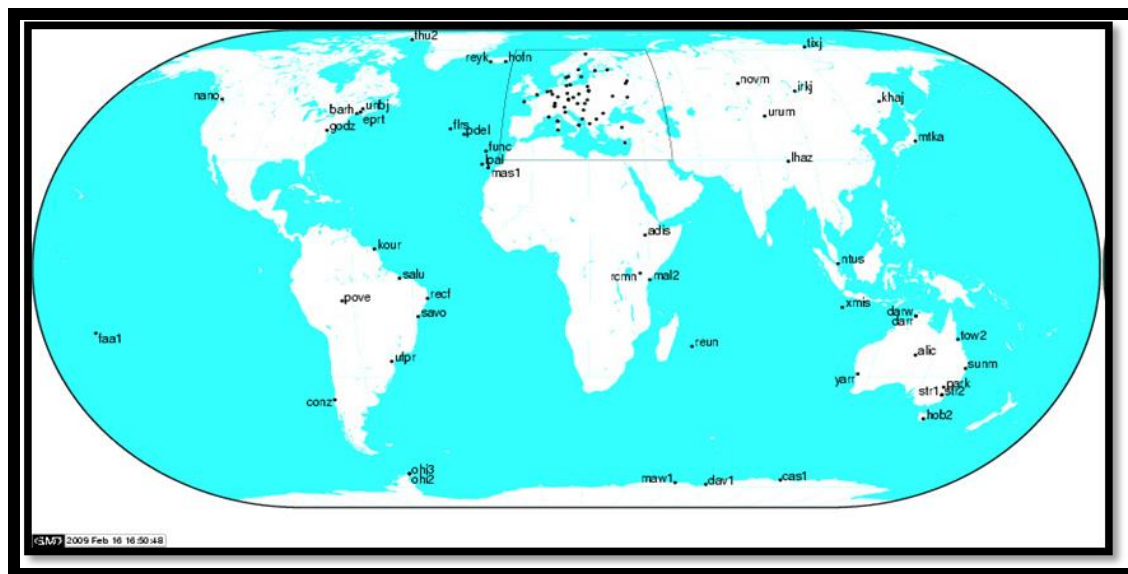
Εικόνα 2.11 Παγκόσμιο δίκτυο GPS/GLONASS του δικτύου IGS [Πηγή: igs.cb.jpl.nasa.gov ]
