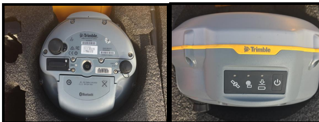
Εικόνα 4.4 Δυνατότητες σύνδεσης και επικοινωνίας δέκτη Trimble R8s
