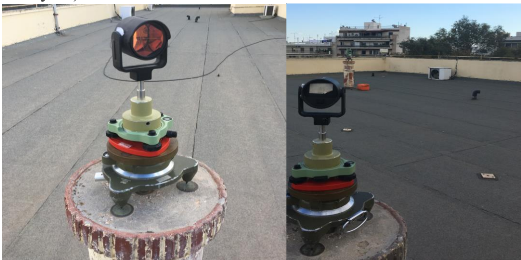
Εικόνα 4.2 Τοποθέτηση κατάφωτου για τη μέτρηση πρότυπων τιμών
