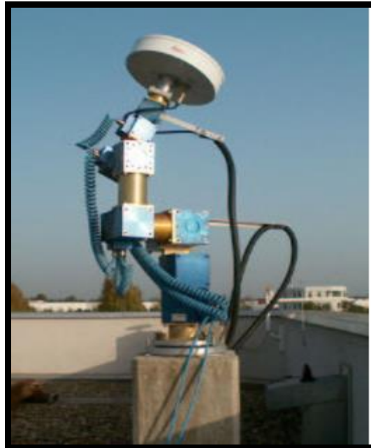
Εικόνα 3.4 Ρομποτικός μηχανισμός βαθμονόμησης δεκτών GNSS [Πηγή : ife.uni-hannover.de,2014]
