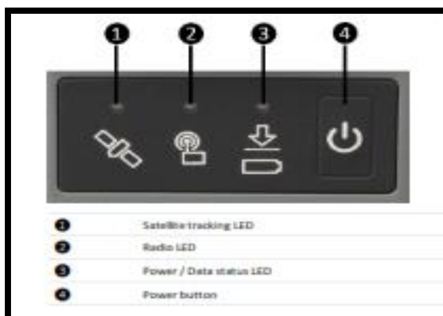
Εικόνα 4.5 Στοιχεία ελέγχου και πληροφόρησης δορυφορικού δέκτη R8s [Πηγή: Trimble.com]
