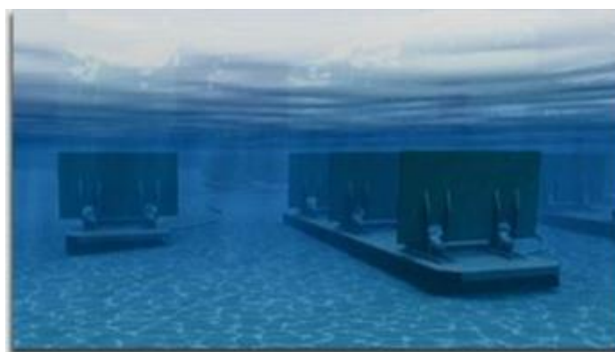
Εικόνα 3.6 Συσκευή AW-Energy Wave roller (Πηγή: A. Peiffer, 2012)
