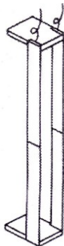
Εικόνα 3.4: Μεταλλικό στέλεχος ακίνητου αισθητήρα ανύψωσης κύματος, wave tank probe .
