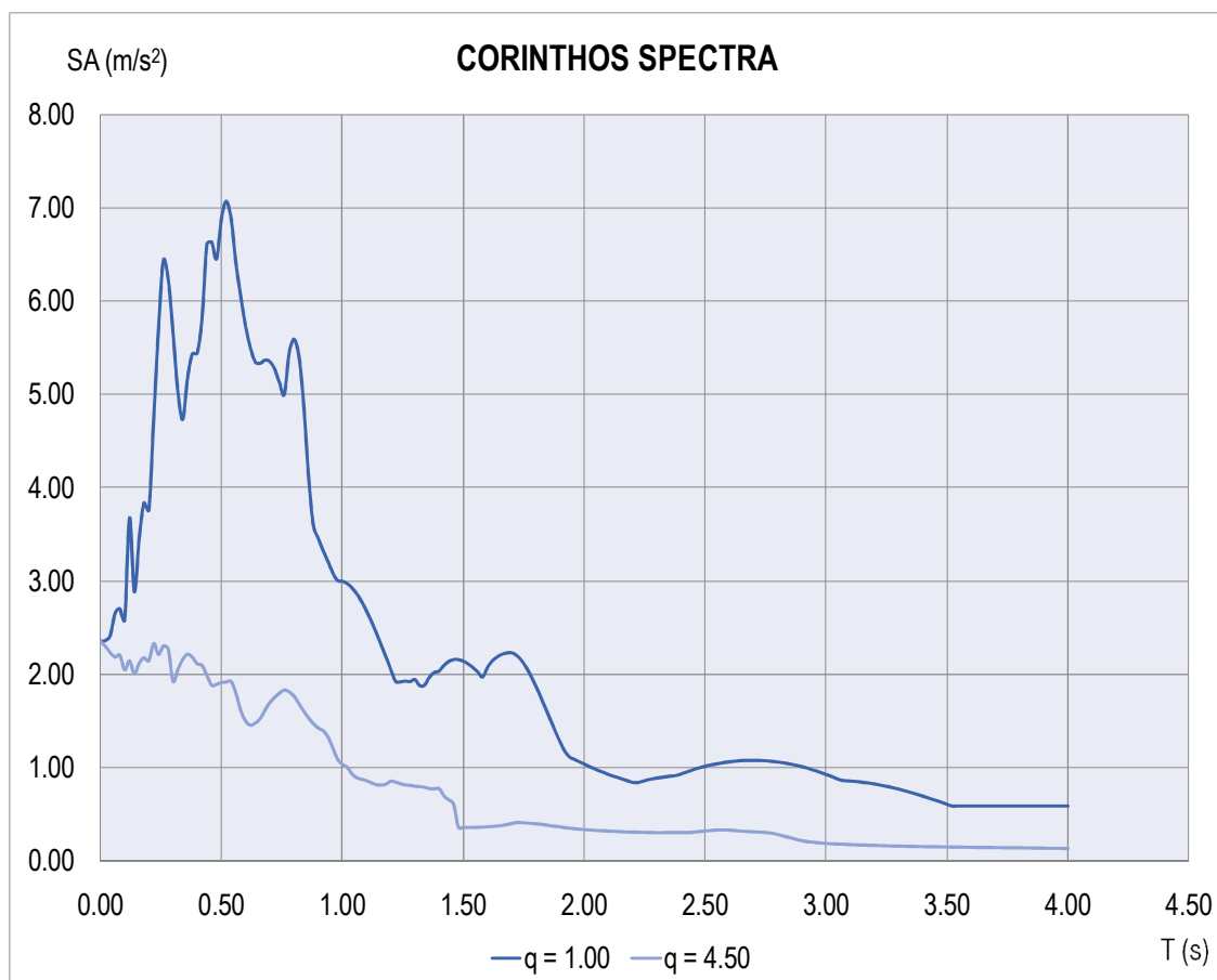
Σχήμα 4-2: φάσμα σχεδιασμού της σεισμικής διέγερσης κατά X του σεισμού της Κορίνθου
