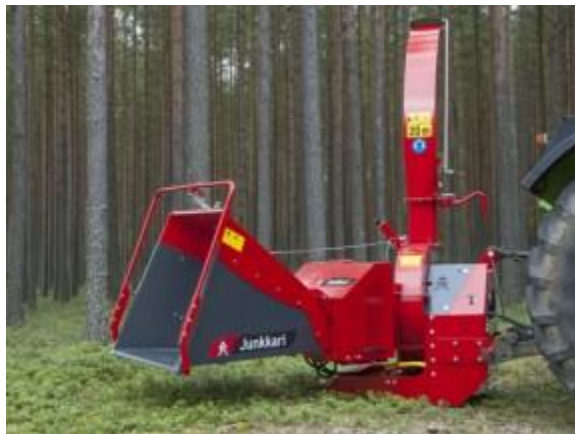
Εικόνα 14: Θρυμματιστής προσαρμοσμένος σε γεωργικό ελκυστήρα (Πηγή: Bartzos)
