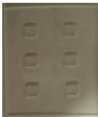
Εικόνα 4.2: Επιφάνεια PMMA με 6 πηγάδια (wells) όπως προέκυψε με τη μέθοδο της θερμής αποτύπωσης με σφραγίδα αλουμινίου.
