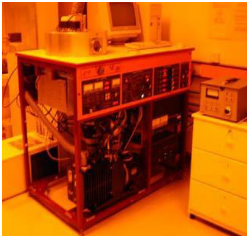
Εικόνα 3.1: Ο αντιδραστήρας πλάσματος RIE του Ινστιτούτου Νανοεπιστήμης και Νανοτεχνολογίας.
