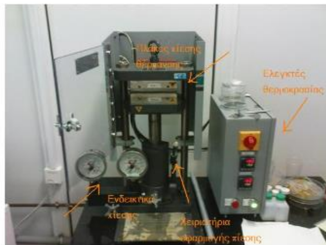
Εικόνα 3.4: Η Θερμοπρέσα της εταιρίας Carver του εργαστηρίου Νανοεπιστήμης και Νανοτεχνολογίας.
