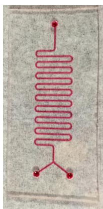
Εικόνα 4.5: Διάταξη μικροκαναλιών, σε ακατέργαστο υπόστρωμα PMMA, μετά από συγκόλληση με έλασμα, όπου έχουμε περάσει κόκκινη χρωστική ουσία.
