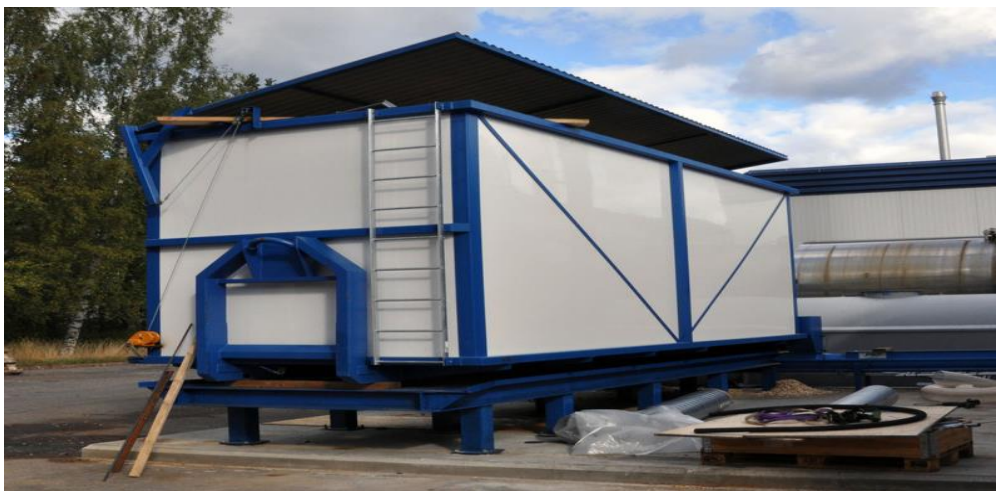
Εικόνα 21: Σύστημα ξήρανσης και αποθήκευσης της πρώτης ύλης στον αεριοποιητή Volter 40
