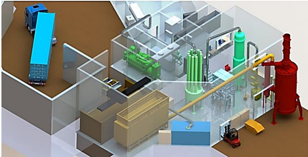
Εικόνα 69: Εργοστάσιο αεριοποίησης βιομάζας Pyrox
