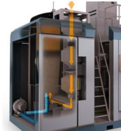
Εικόνα 59: Λειτουργία αεριοποιητή Burkhardt
