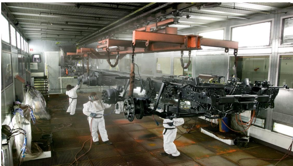
Εικόνα 2.9.1 Πλαίσιο Φορτηγού με τους άξονες τοποθετημένους στο στάδιο της βαφής
