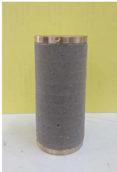
Σχήμα 4. 9 Φωτογραφία σταθεροποιημένου δοκιμίου πριν την τοποθέτησή του στην τριαξονική συσκευή.
