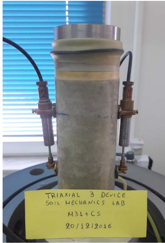
Σχήμα 4. 8 Μετρητές αξονικής παραμόρφωσης επί του δοκιμίου (LVDTs).
