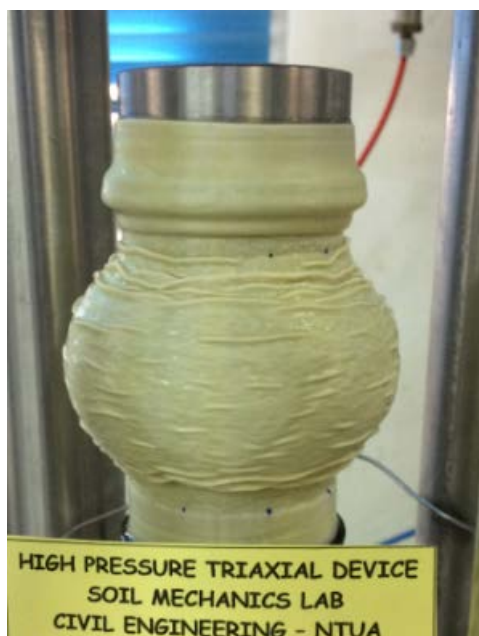
Σχήμα 4. 14 Αστοχία δοκιμίου που εκδηλώθηκε με την πλευρική διόγκωση (bulging).
