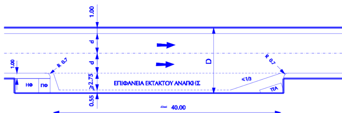
Εικόνα 5.9: Τυπική διαμόρφωση μονόπλευρης εσοχής έκτακτης στάθμευσης (ΟΜΟΕ - Τεύχος Οδικών Σηράγγων, 2002)
