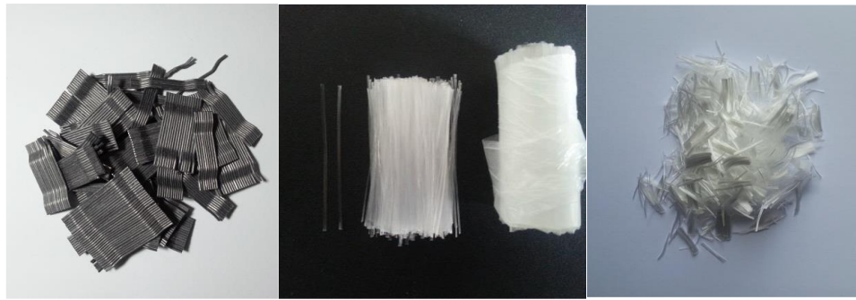
Σχήμα 4.2: α) Χαλύβδινες ίνες, β) Μακροΐνες πολυπροπυλενίου και γ) Μικροΐνες πολυπροπυλενίου (Χουμανίδης, 2016).
