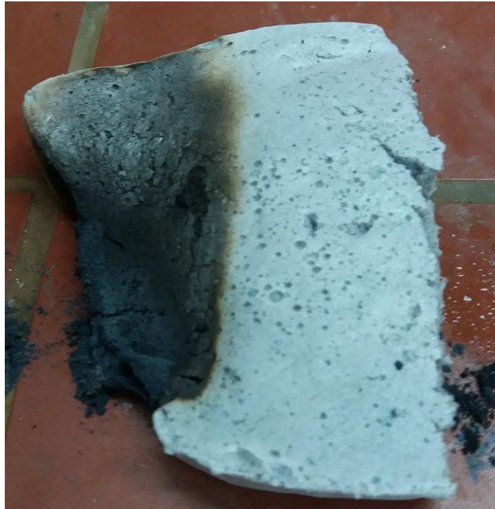
Σχήμα 5-22: Σύνθεση 1 η μετά την δοκιμή αντίστασης στη φωτιά
