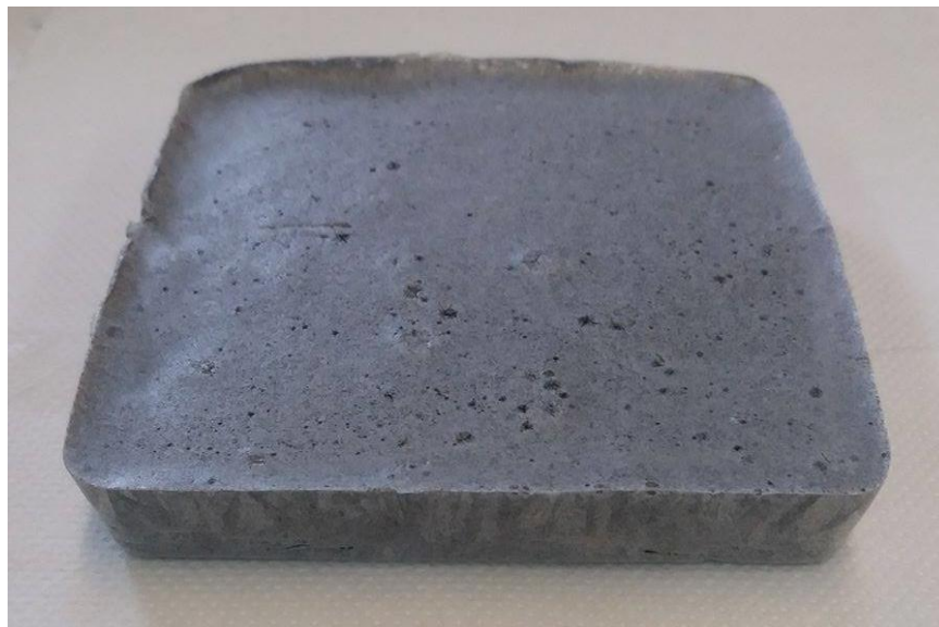
Σχήμα 5-8: Σύνθεση 8 θερμομονωτικού υλικού(2,4%/0,22M Cs/AcOH – 8% SF- 0,25% SDS)
