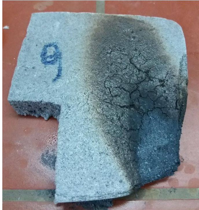
Σχήμα 5-25: Σύνθεση 9 η μετά την δοκιμή αντίστασης σε φωτιά
