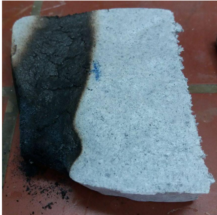
Σχήμα 5-23: Σύνθεση 4 η μετά την δοκιμή αντίστασης σε φωτιά .
