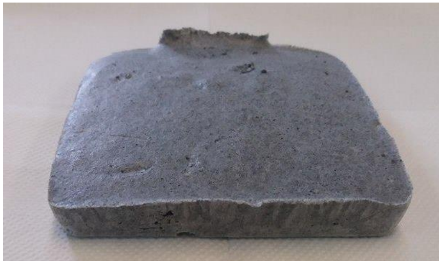
Σχήμα 5-9: Σύνθεση 9θερμομονωτικού υλικού(2,4%/0,22M Cs/AcOH – 12% SF- 0,50% SDS)
