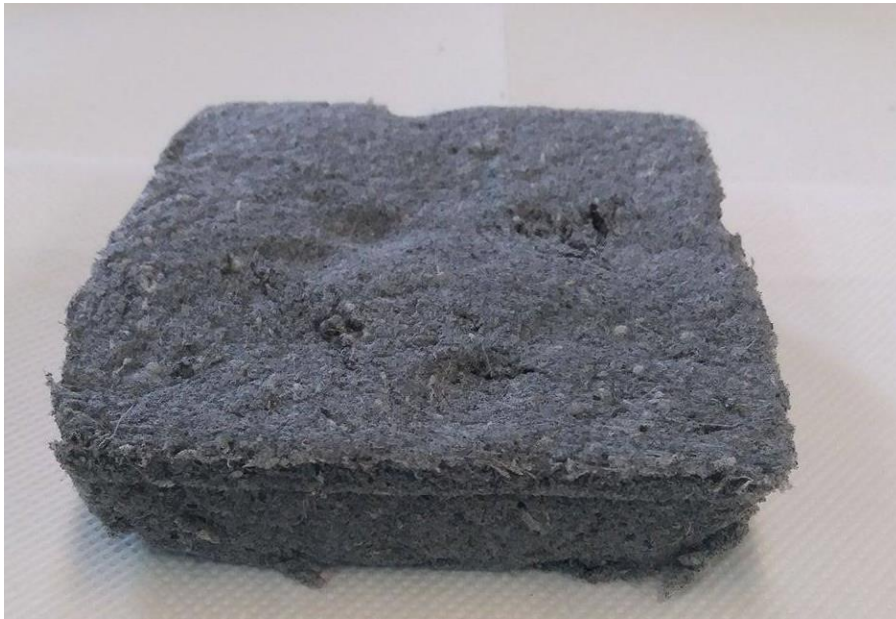
Σχήμα 5-3: Σύνθεση 3 θερμομονωτικού υλικού(1%/0,09M Cs/AcOH – 12% SF- 0,75% SDS)
