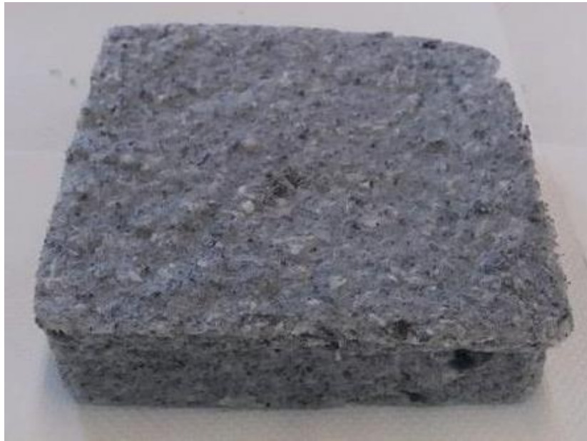
Σχήμα 5-5: Σύνθεση 5θερμομονωτικού υλικού(1,7%/0,15M Cs/AcOH – 8% SF- 0,75% SDS)
