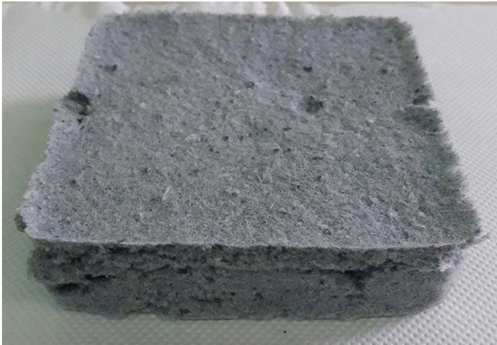
Σχήμα 5-2: Σύνθεση 2 θερμομονωτικού υλικού( 1%/0,09M Cs/AcOH – 8% SF – 0,50% SDS )
