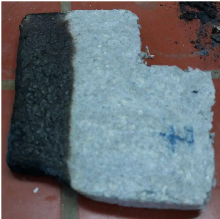
Σχήμα 5-24: Σύνθεση 7 η μετά την δοκιμή αντίστασης σε φωτιά
