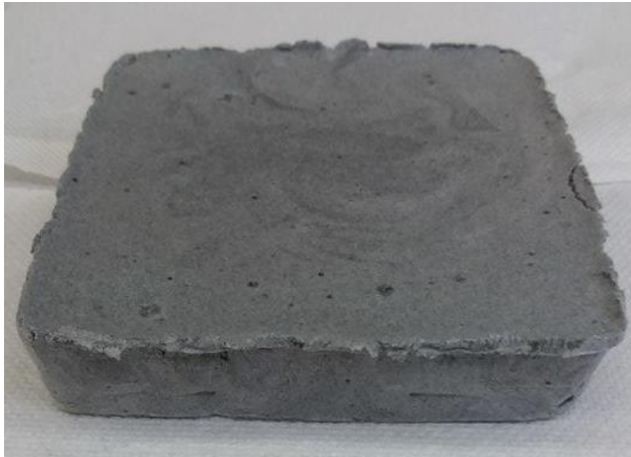
Σχήμα 5-6: Σύνθεση 6 θερμομονωτικού υλικού (1,7%/0,15M Cs/AcOH – 12% SF- 0,25% SDS)
