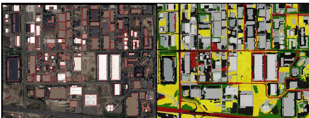
ΕΙΚΟΝΑ 3.196: ΑΞΙΟΛΟΓΗΣΗ ΤΩΝ ΕΠΙΔΟΣΕΩΝ ΤΟΥ ΑΛΓΟΡΙΘΜΟΥ «ΕΓΓΥΤΕΡΟΣ ΓΕΙΤΟΝΑΣ» ΣΕ Ο,ΤΙ ΑΦΟΡΑ ΤΗΝ ΑΝΙΧΝΕΥΣΗ ΤΩΝ ΚΤΙΡΙΩΝ
