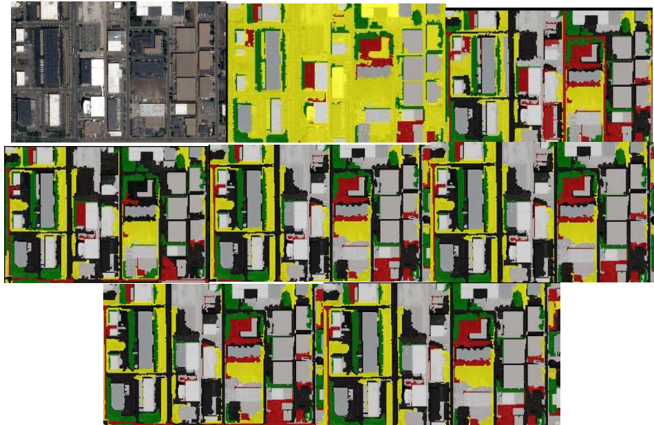
ΕΙΚΟΝΑ 3.101: : ΑΠΟ ΤΗΝ ΑΡΧΗ: 1 ο ΑΠΟΣΠΑΣΜΑ ΑΡΧΙΚΗΣ ΕΙΚΟΝΑΣ, ΓΙΑ ΤΗΝ ΤΙΜΗ 2 ΤΟΥ ΒΑΘΟΥΣ ΔΕΝΤΡΩΝ, ΓΙΑ ΤΗΝ ΤΙΜΗ 3, ΓΙΑ ΤΗΝ ΤΙΜΗ 4, ΓΙΑ ΤΗΝ ΤΙΜΗ 5, ΓΙΑ ΤΗΝ ΤΙΜΗ 25, ΓΙΑ ΤΗΝ ΤΙΜΗ 50, ΓΙΑ ΤΗΝ ΤΙΜΗ 100
