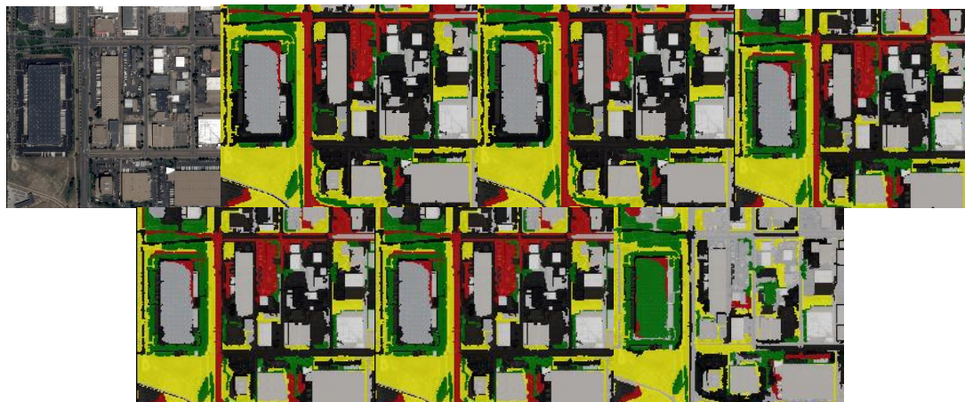
ΕΙΚΟΝΑ 3.175: ΑΠΟ ΤΗΝ ΑΡΧΗ: 3 ο ΑΠΟΣΠΑΣΜΑ ΑΡΧΙΚΗΣ ΕΙΚΟΝΑΣ ΓΙΑ ΤΙΜΕΣ ΤΗΣ ΠΑΡΑΜΕΤΡΟΥ ΑΚΡΙΒΕΙΑ ΔΑΣΟΥΣ: 0,01, 0,02, 0,05, 0,1, 0,5, 1
