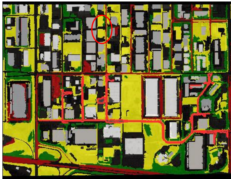
ΕΙΚΟΝΑ 3.199: ΑΠΟΤΕΛΕΣΜΑ ΤΑΞΙΝΟΜΗΣΗΣ ΜΕ ΤΟΝ ΑΛΓΟΡΙΘΜΟ ΕΓΓΥΤΕΡΟΣ ΓΕΙΤΟΝΑΣ ΕΠΕΙΤΑ ΑΠΟ ΕΦΑΡΜΟΓΗ ΤΟΥ ΚΑΝΟΝΑ ΤΗΣ ΣΥΜΠΑΓΟΤΗΤΑΣ ΣΤΗ ΘΕΜΑΤΙΚΗ ΚΑΤΗΓΟΡΙΑ ΤΩΝ ΚΤΙΡΙΩΝ
