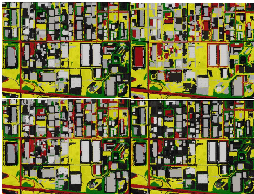
ΕΙΚΟΝΑ 3.145: ΑΠΟΤΕΛΕΣΜΑ ΕΦΑΡΜΟΓΗΣ ΤΟΥ ΑΛΓΟΡΙΘΜΟΥ ΤΩΝ ΤΥΧΑΙΩΝ ΔΑΣΩΝ ΓΙΑ ΤΙΜΕΣ ΤΗΣ ΠΑΡΑΜΕΤΡΟΥ ΕΝΕΡΓΕΣ ΜΕΤΑΒΛΗΤΕΣ 0 – ΔΗΛΑΔΗ \sqrt{9} = 3 (ΠΑΝΩ ΑΡΙΣΤΕΡΑ), 2 (ΠΑΝΩ ΔΕΞΙΑ), 5 (ΚΑΤΩ ΑΡΙΣΤΕΡΑ), 9 (ΚΑΤΩ ΔΕΞΙΑ)
