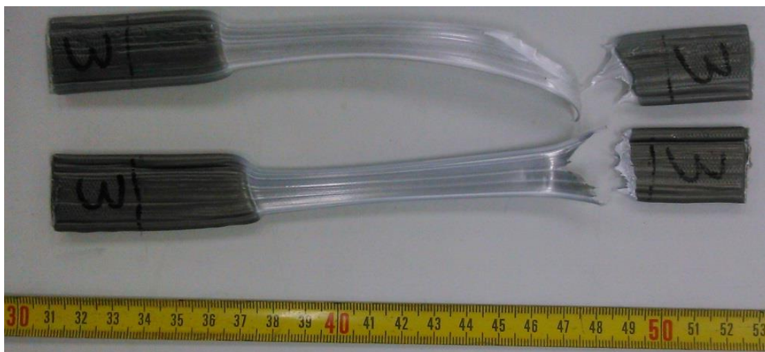
Εικόνα 5.56 Δοκίμια πολυαιθυλενίου (επαναλήψιμης συμπεριφοράς) περιεκτικότητας 3% σε φολίδες χάλυβα μετά τη δοκιμή σε εφελκυσμό
