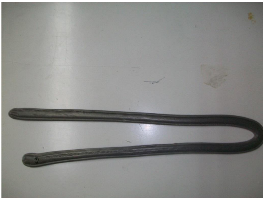
Εικόνα 4.14 Σύνθετο υλικό HDPE/SSF μετά από συμπίεση από όπου θα προκύψουν τα τελικά δοκίμια εφελκυσμού και κάμψης τριών σημείων
