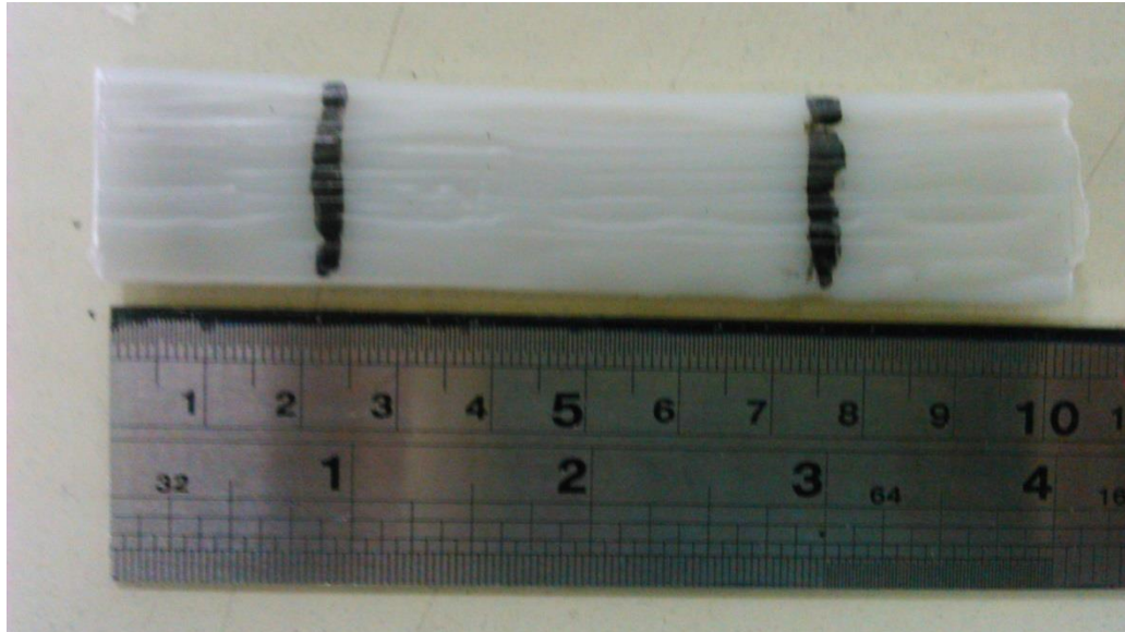
Εικόνα 5.53 Δοκίμιο πολυαιθυλενικής μήτρας στο οποίο φαίνονται τα όρια συγκράτησης (25mm) από τις δαγκάνες, σύμφωνα με το πρότυπο ASTM D882-02
