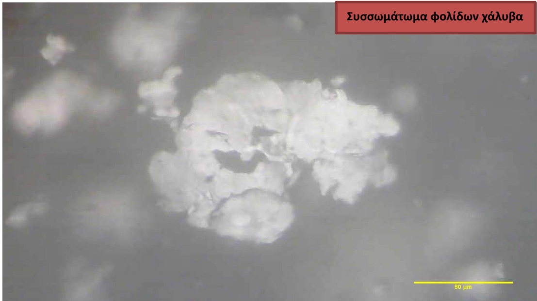
Εικόνα 5.7 Άποψη από οπτικό μικροσκόπιο (μεγέθυνση x50) δοκιμίου πολυαιθυλενίου περιεκτικότητας 4% σε φολίδες ανοξειδωτου χάλυβα
