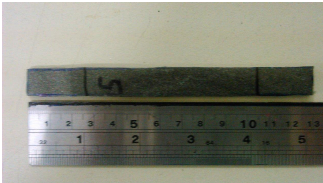
Εικόνα 5.49 Δοκίμιο μεθακρυλικής μήτρας στο οποίο φαίνονται τα όρια συγκράτησης (25mm) από τις δαγκάνες, σύμφωνα με το πρότυπο ASTM D882-02
