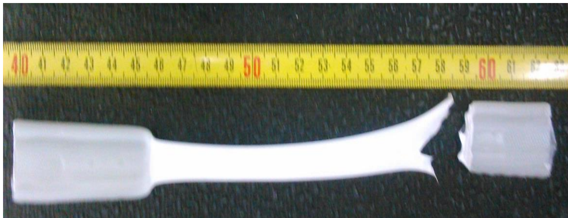
Εικόνα 5.54 Δοκίμιο πολυαιθυλενίου (μήτρα) μετά τη δοκιμή σε εφελκυσμό
