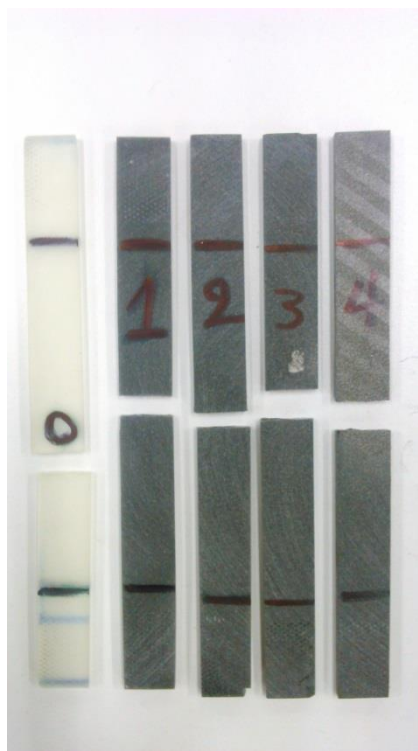
Εικόνα 5.48 Δοκίμια εποξικής ρητίνης περιεκτικότητας 0,1,2,3 και 4 % σε φολίδες χάλυβα μετά τη δοκιμή σε εφελκυσμό
