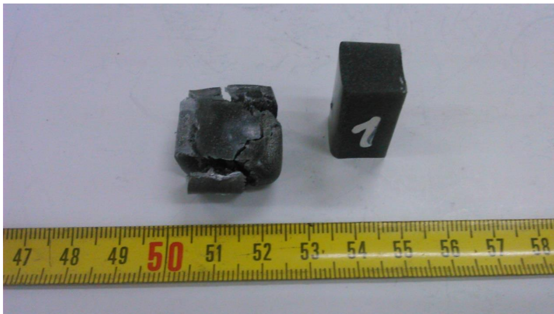
Εικόνα 5.62 Δοκίμο εποξειδικής ρητίνης περιεκτικότητας 1% σε φολίδες χάλυβα πριν και μετά τη δοκιμή σε συμπίεση
