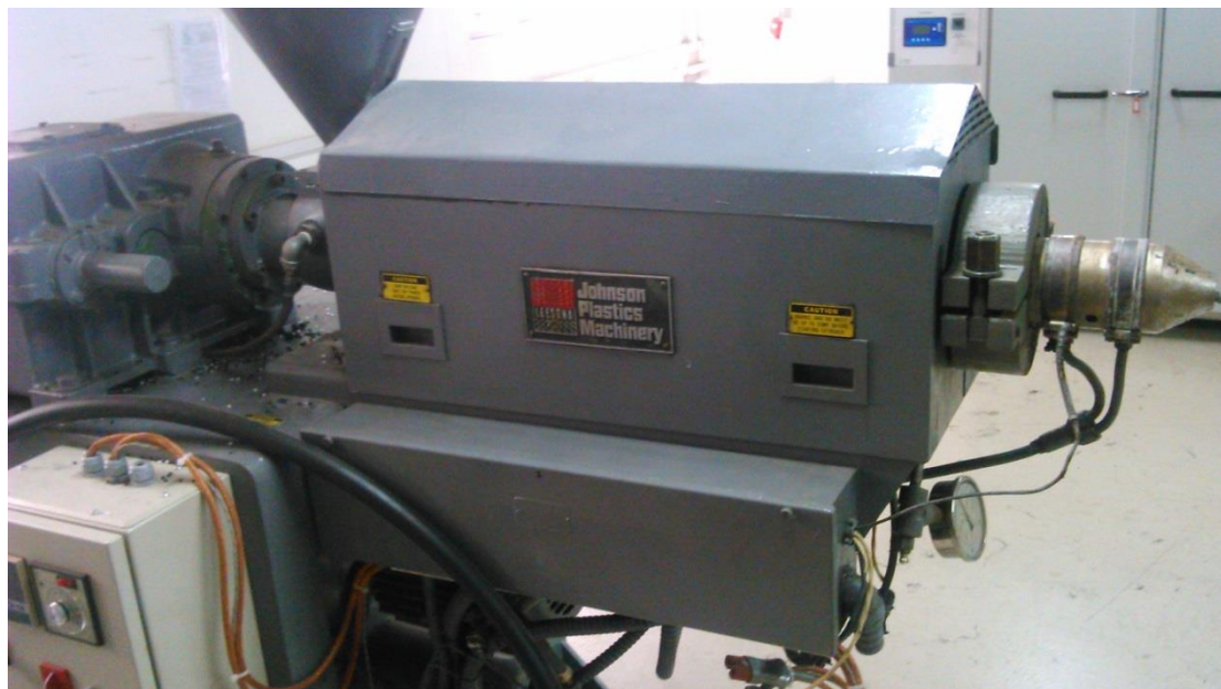
Εικόνα 4.4 Το σημείο του extruder όπου υπάρχουν οι αντιστάσεις θέρμανσης του πολυμερούς και ο κοχλίας
