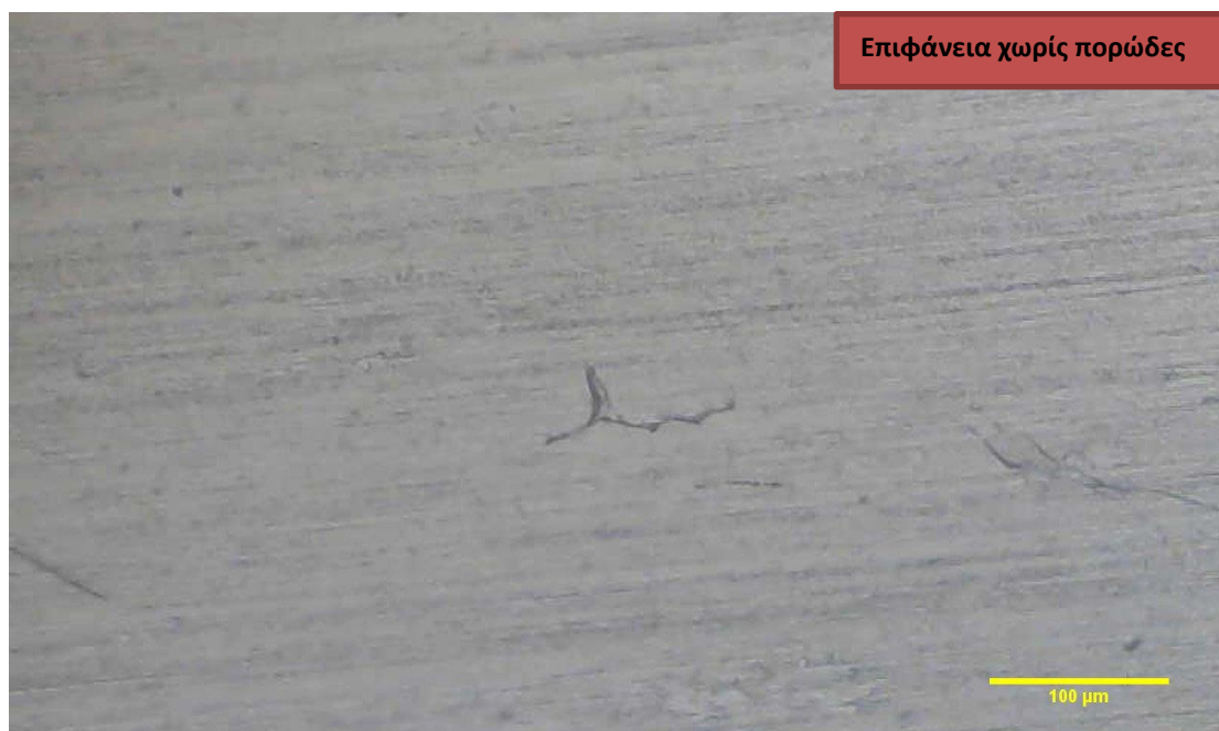
Εικόνα 5.41 Άποψη από οπτικό μικροσκόπιο (μεγέθυνση x50) δοκιμίου καθαρής μεθακρυλικής ρητίνης
