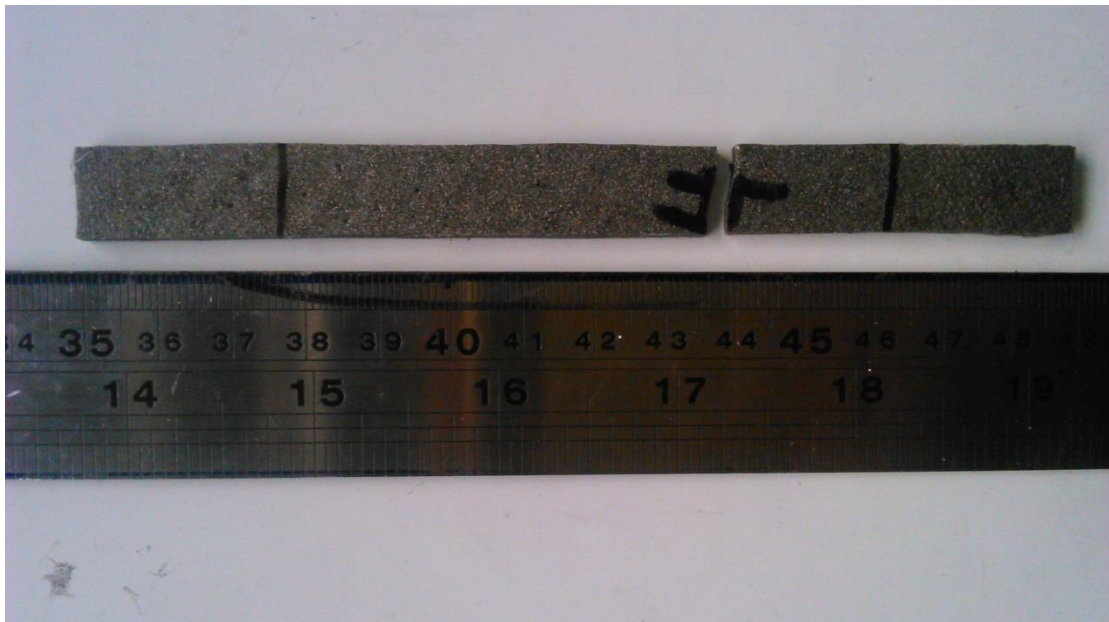
Εικόνα 5.51 Δοκίμιο μεθακρυλικής ρητίνης περιεκτικότητας 4% σε φολίδες χάλυβα μετά τη δοκιμή σε εφελκυσμό (μπορεί να παρατηρηθεί η εμφάνιση πόρων μετά το πέρας του εφελκυσμού)
