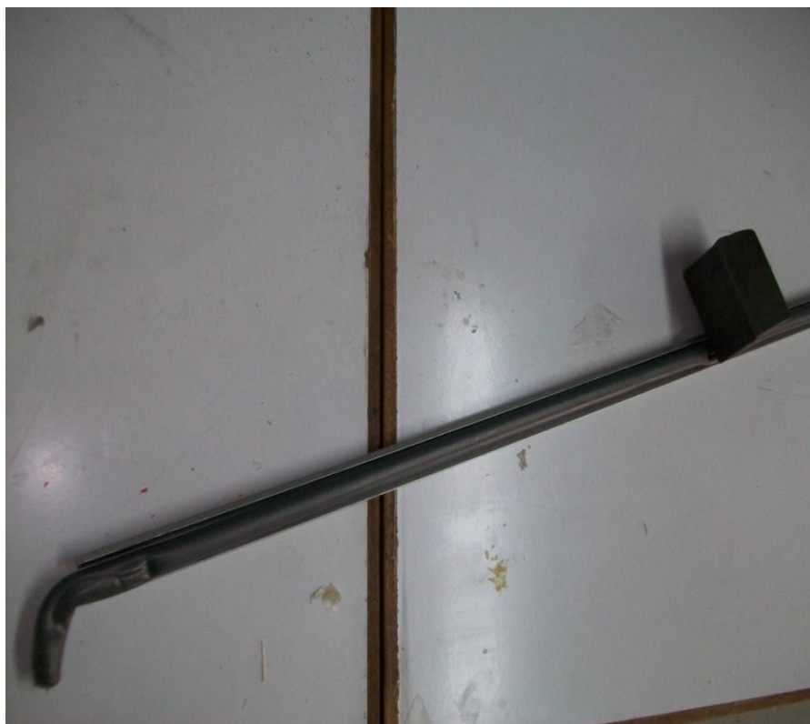
Εικόνα 4.15 Στήριξη για στερεοποίηση ράβδου πολυαιθυλενίου που θα χρησιμοποιηθεί για τεστ συμπίεσης και μεταλλογραφίας
