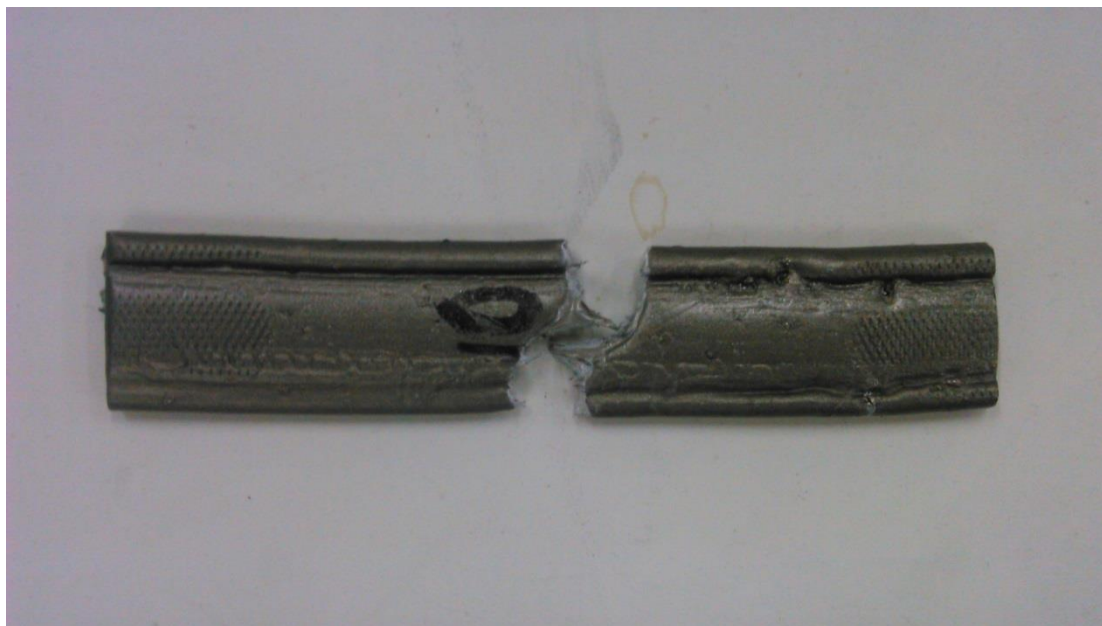
Εικόνα 5.57 Δοκίμιο πολυαιθυλενίου περιεκτικότητας 10% σε φολίδες χάλυβα μετά τη δοκιμή σε εφελκυσμό
