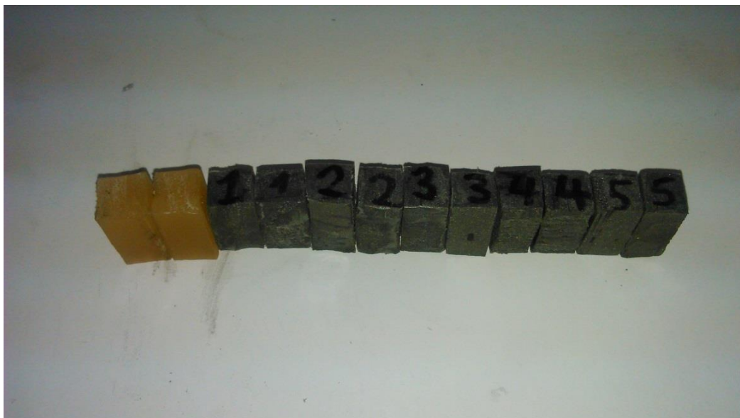
Εικόνα 4.40 Δοκίμια μεθακρυλικής ρητίνης που μετασχηματίστηκαν από κυλινδρικά σε 25.4X12.7X12.7 για τα τεστ συμπίεσης κατά πρότυπο ASTM
