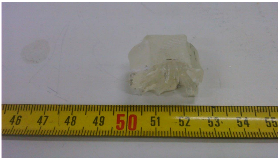
Εικόνα 5.64 Δοκίμο εποξειδικής ρητίνης μετά τη δοκιμή σε συμπίεση
