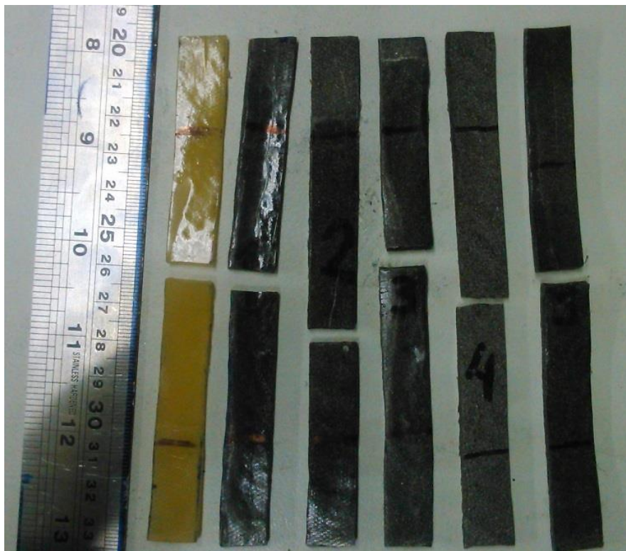
Εικόνα 5.52 Δοκίμια μεθακρυλικής ρητίνης περιεκτικότητας 0,1,2 και 3 % σε φολίδες χάλυβα μετά τη δοκιμή σε εφελκυσμό
