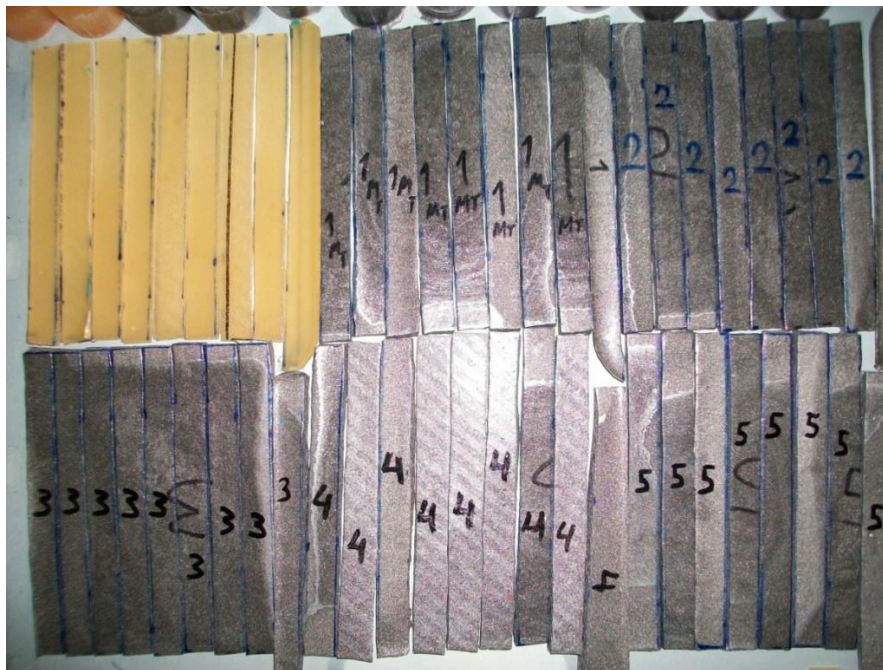
Εικόνα 4.36 Δοκίμα μεθακρυλικής ρητίνης με φολίδες ανοξειδωτου χάλυβα σε περιεκτικότητες 0,1,2,3,4 και 5%
