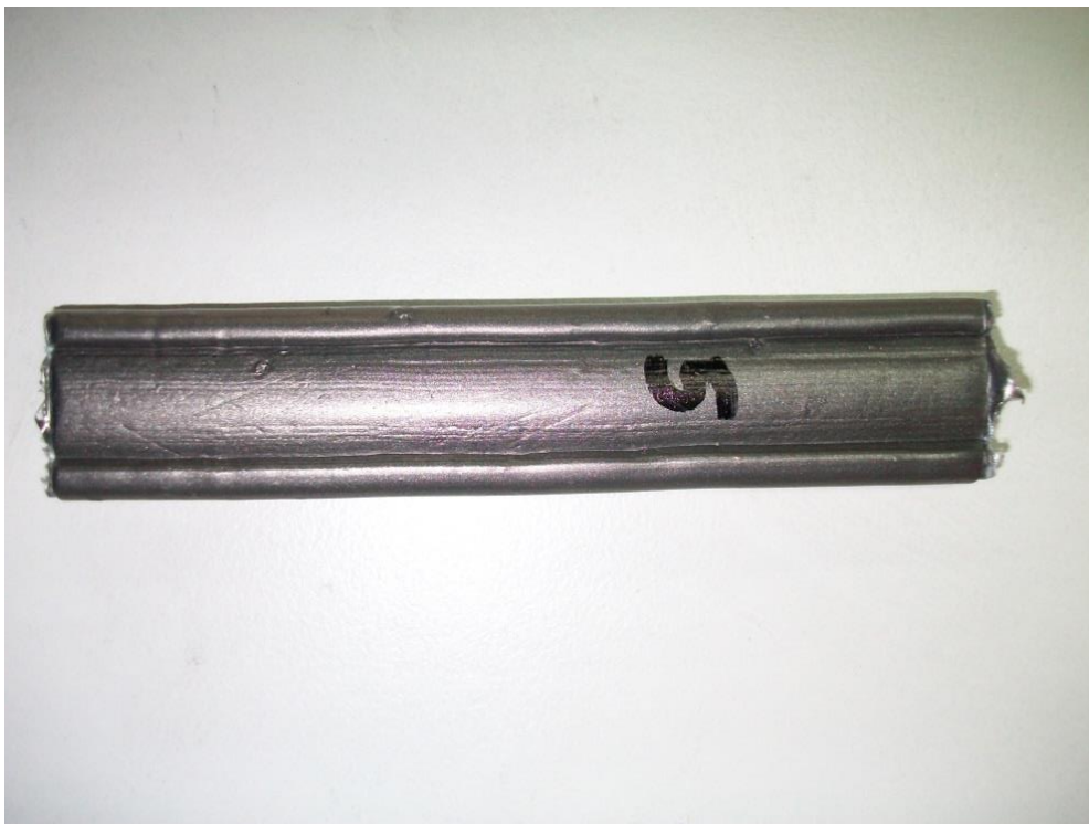
Εικόνα 4.19 Δοκίμιο καθαρού πολυαιθυλενίου διαστάσεων : 100X30x6
