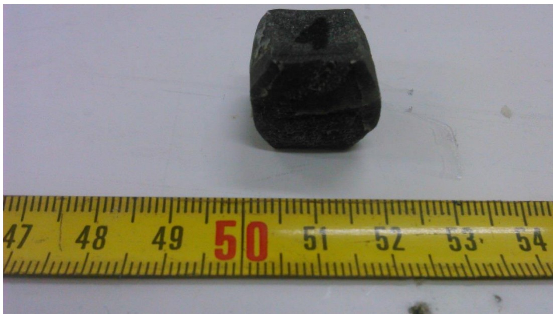
Εικόνα 5.65 Δοκίμο μεθακρυλικής ρητίνης περιεκτικότητας 1% σε φολίδες χάλυβα μετά τη δοκιμή σε συμπίεση
