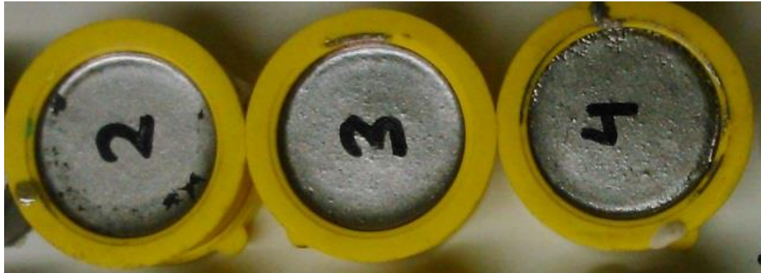
Εικόνα 4.34 Κυλινδρικά δοκίμια εποξειδικής ρητίνης πριν εξαχθούν από το καλούπι
