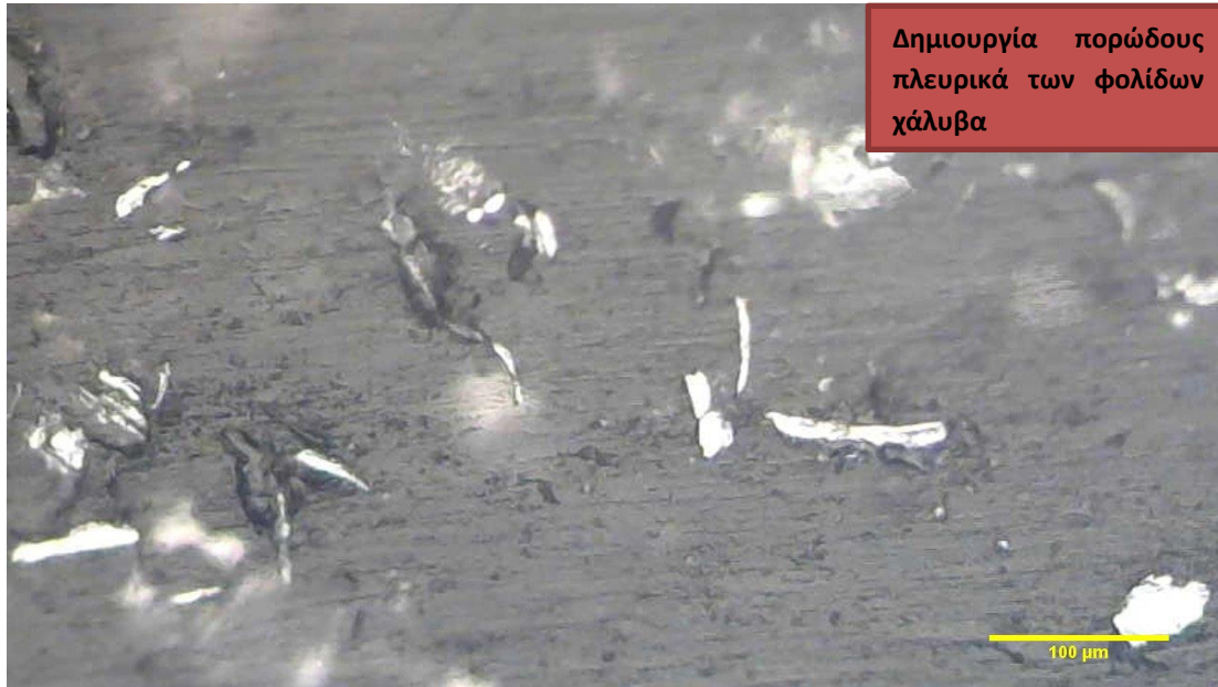
Εικόνα 5.36 Άποψη από οπτικό μικροσκόπιο (μεγέθυνση x20) δοκιμίου μεθακρυλικής ρητίνης περιεκτικότητας 5% σε φολίδες ανοξείδωτου χάλυβα
