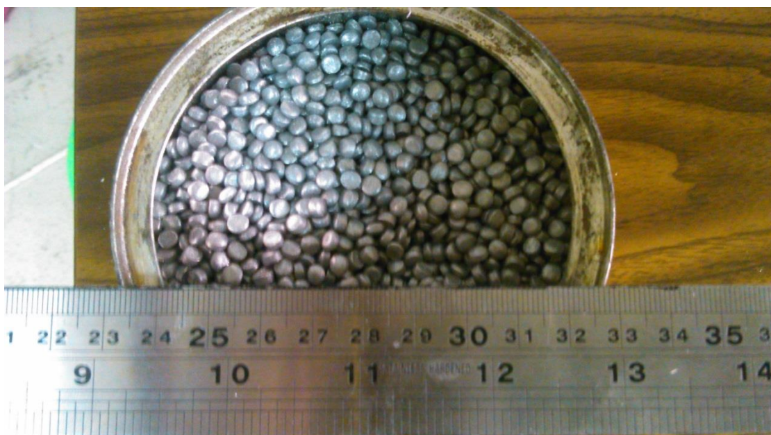
Εικόνα 4.9 Κόκκοι πολυαιθυλενίου μετά την ανάμειξη με φολίδες ανοξείδωτου χάλυβα
