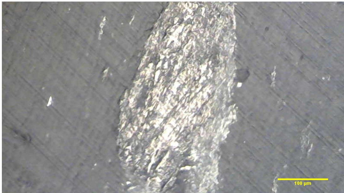
Εικόνα 5.11 Άποψη από οπτικό μικροσκόπιο (μεγέθυνση x20) εγκάρσιας τομής δοκιμίου πολυαιθυλενίου περιεκτικότητας 5% σε φολίδες ανοξειδωτου χάλυβα, παρατηρείται συσσωμάτωμα φολίδων χάλυβα
