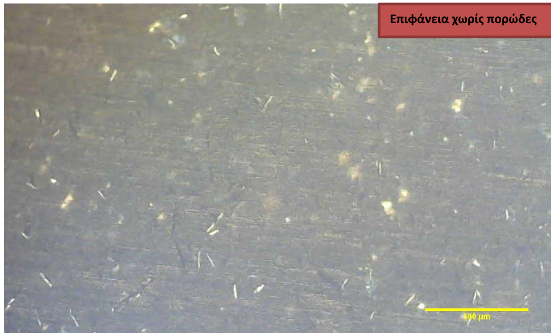
Εικόνα 5.40 Άποψη από οπτικό μικροσκόπιο (μεγέθυνση x5) δοκιμίου μεθακρυλικής ρητίνης περιεκτικότητας 2% σε φολίδες ανοξειδωτού χάλυβα
