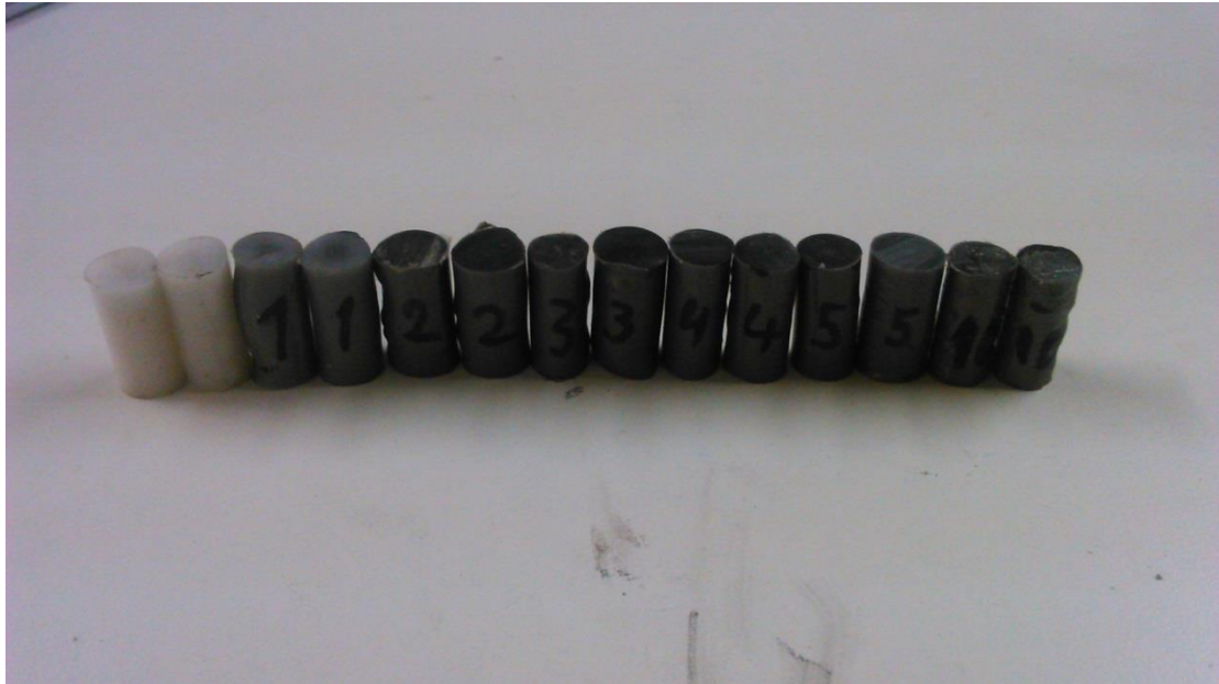
Εικόνα 4.20 Δοκίμια διαφορετικών περιεκτικότητων σε φολίδες χάλυβα, για τα τεστ συμπίεσης
