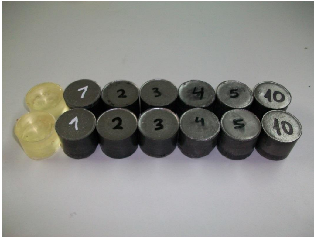
Εικόνα 4.37 Κυλινδρικά δοκίμια εποξειδικής ρητίνης με φολίδες ανοξείδωτου χάλυβα σε περιεκτικότητες 0,1,2,3,4,5 και 10%
