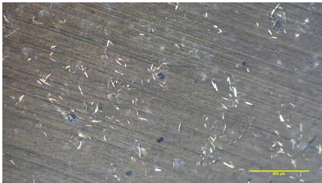
Εικόνα 5.21 Άποψη από οπτικό μικροσκόπιο (μεγέθυνση x5) εγκάρσιας τομής δοκιμίου εποξειδικής ρητίνης περιεκτικότητας 4% σε φολίδες ανοξείδωτου χάλυβα
