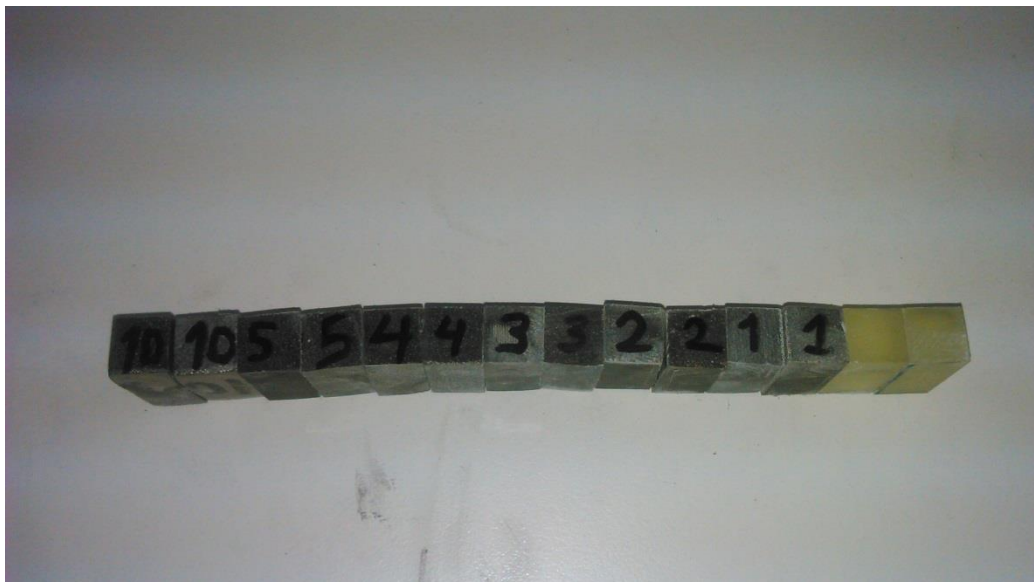
Εικόνα 4.38 Δοκίμια εποξειδικής ρητίνης που μετασηματίστηκαν από κυλινδρικά σε 25.4X12.7X12.7 για τα τεστ συμπίεσης κατά πρότυπο ASTM
