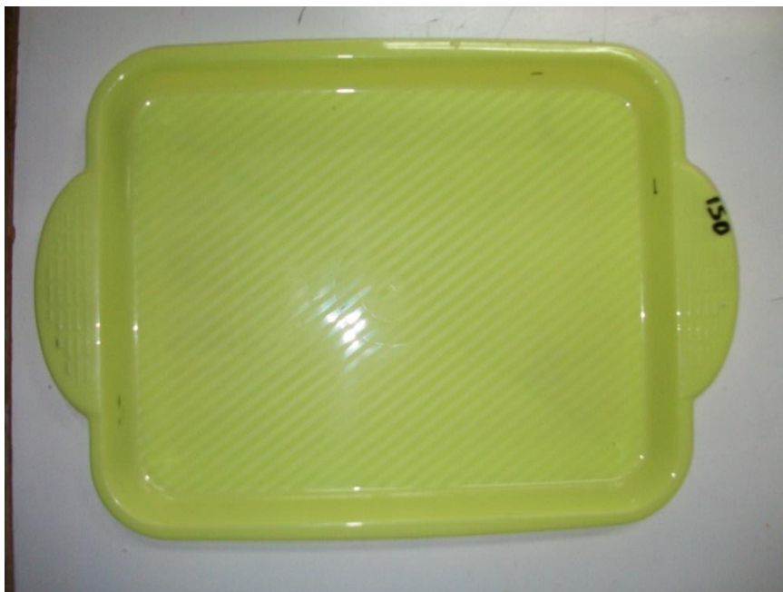
Εικόνα 4.30 Πλαστικός ορθογώνιος δίσκος ως καλούπι έγχυσης
