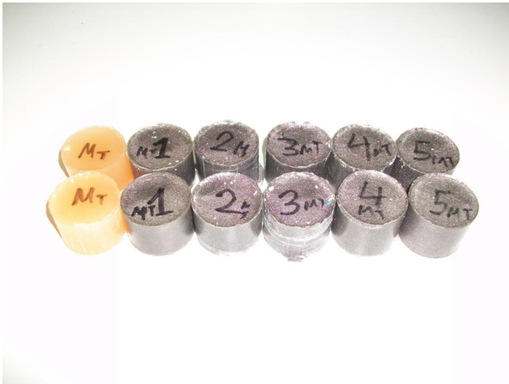
Εικόνα 4.39 Κυλινδρικά δοκίμια μεθακρυλικής ρητίνης με φολίδες ανοξείδωτου χάλυβα σε περιεκτικότητες 0,1,2,3,4 και 5%
