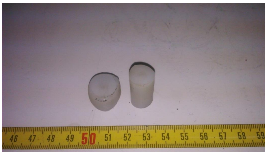
Εικόνα 5.66 Δοκίμο πολυαιθυλενίου πριν και μετά τη δοκιμή σε συμπίεση
