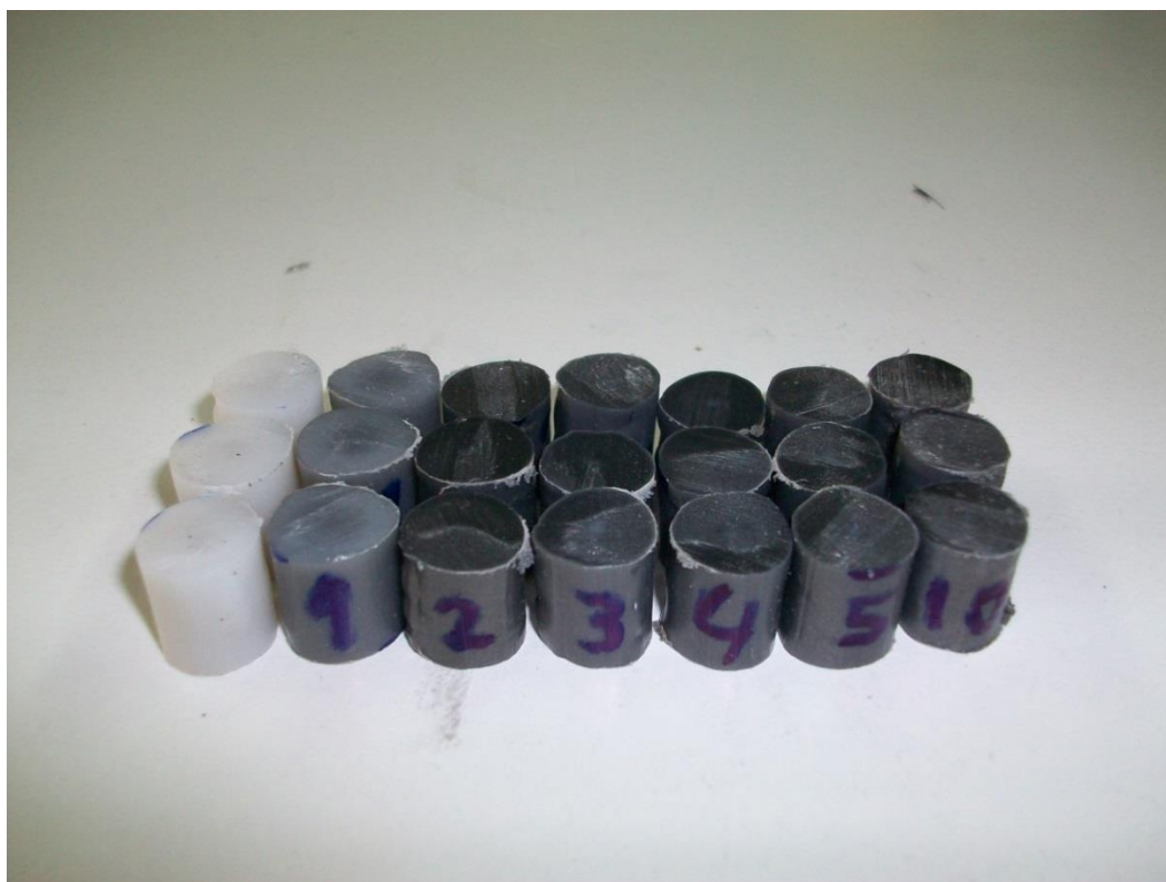
Εικόνα 4.21 Δοκίμια διαφορετικών περιεκτικότητων σε φολίδες χάλυβα, για την μικροσκοπική απεικόνιση
