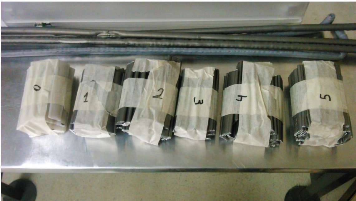
Εικόνα 4.23 Δοκίμια πολυαιθυλενίου με περιεκτικότητες 0,1,2,3,4,5,10 % αντίστοιχα σε φολίδες ανοξείδωτου χάλυβα
