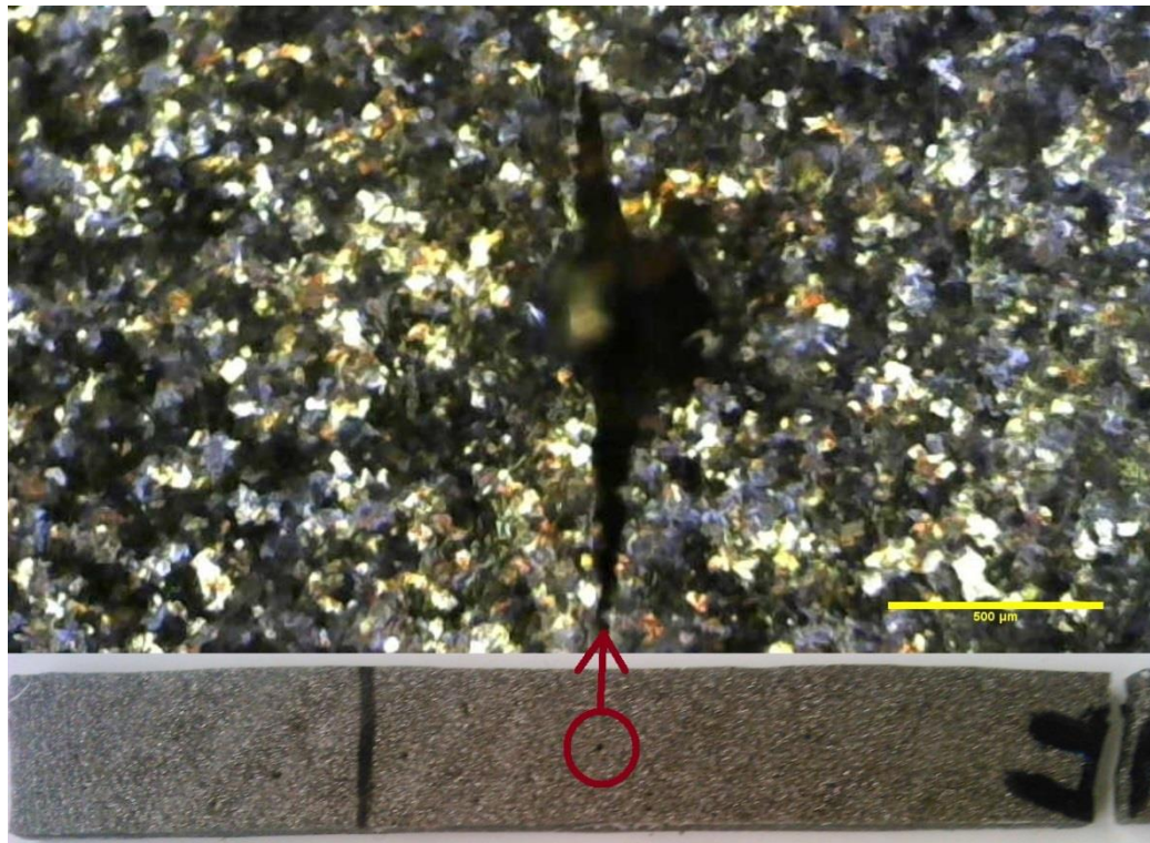
Εικόνα 5.44 Άποψη από οπτικό μικροσκόπιο (μεγέθυνση x5) δοκιμίου μεθακρυλικής ρητίνης περιεκτικότητας 4% σε φολίδες ανοξειδωτου χάλυβα, κατόπιν εφελκυστικής καταπόνησης. Παρατηρείται διάδοση ρωγμών από πόρο του υλικού.
