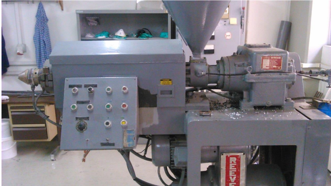
Εικόνα 4.1 Ο extruder του εργαστηρίου όπου έγινε η Διέλαση του πολυαιθυλενίου
