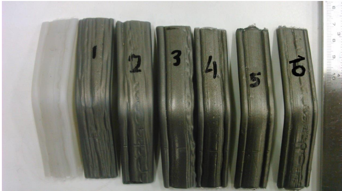
Εικόνα 5.60 Δοκίμια πολυαιθυλενικής μήτρας με ποσοστό φολίδων χάλυβα 0,1,2,3,4,5 και 10% μετά την κάμψη τριών σημείων
