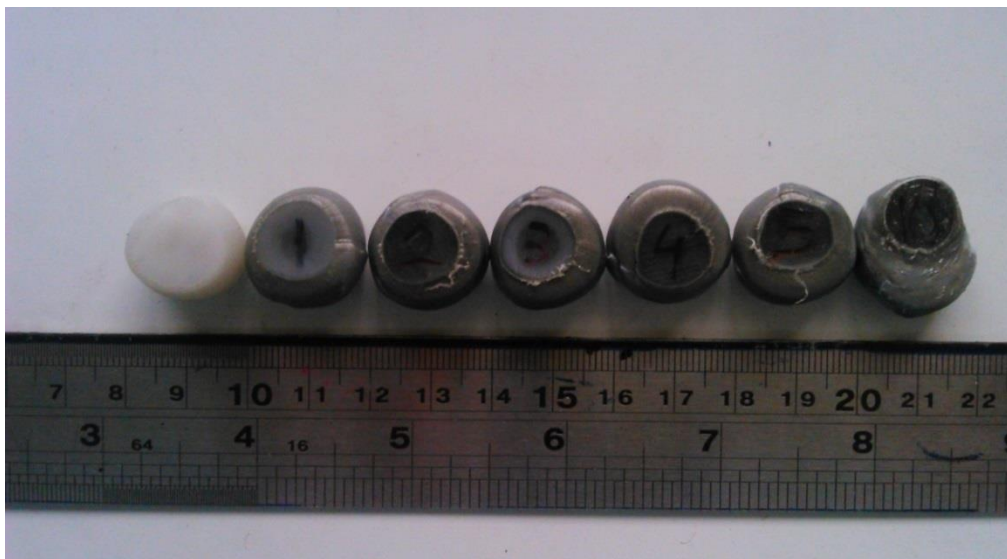
Εικόνα 5.67 Δοκίμια πολυαιθυλενίου περιεκτικότητας 0,1,2,3,4,5 και 10% σε φολίδες χάλυβα μετά τη δοκιμή σε συμπίεση
