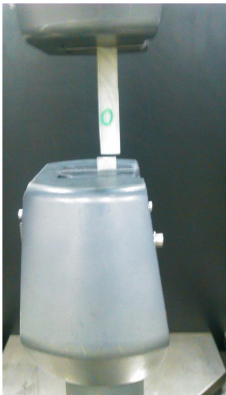
Εικόνα 5.47 Δοκίμιο εποξικής ρητίνης κατά την αστοχία σε δοκιμή εφελκυσμού
