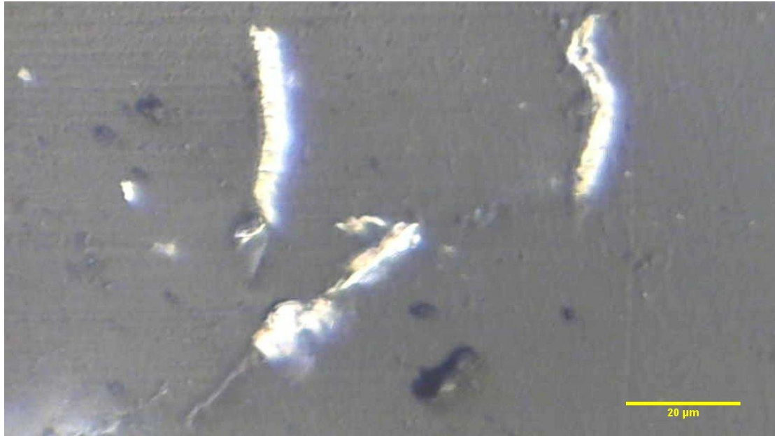
Εικόνα 5.38 Άποψη από οπτικό μικροσκόπιο (μεγέθυνση x100) δοκιμίου μεθακρυλικής ρητίνης περιεκτικότητας 3% σε φολίδες ανοξειδωτού χάλυβα
