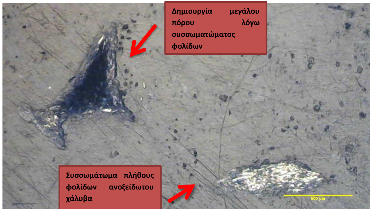
Εικόνα 5.3 Άποψη από οπτικό μικροσκόπιο (μεγέθυνση x5) δοκιμίου πολυαιθυλενίου περιεκτικότητας 10% σε φολίδες ανοξειδωτου χάλυβα
