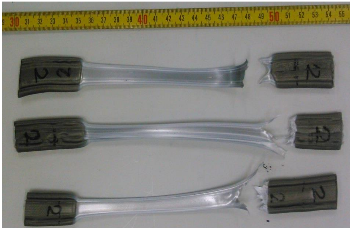
Εικόνα 5.55 Δοκίμια πολυαιθυλενίου (επαναλήψιμης συμπεριφοράς) περιεκτικότητας 2% σε φολίδες χάλυβα μετά τη δοκιμή σε εφελκυσμό
