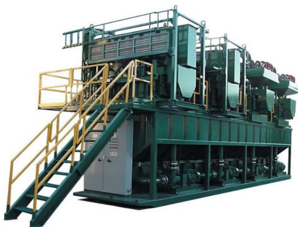
Εικόνα 2.19: Αριστερά εγκαταστάσεις διαχωρισμού του πολφού από το μεταφερόμενο εδαφικό υλικό (Derrick Corporation n.d.), Δεξιά πλάνο διαχωρισμού (Herrenknecht n.d.).
