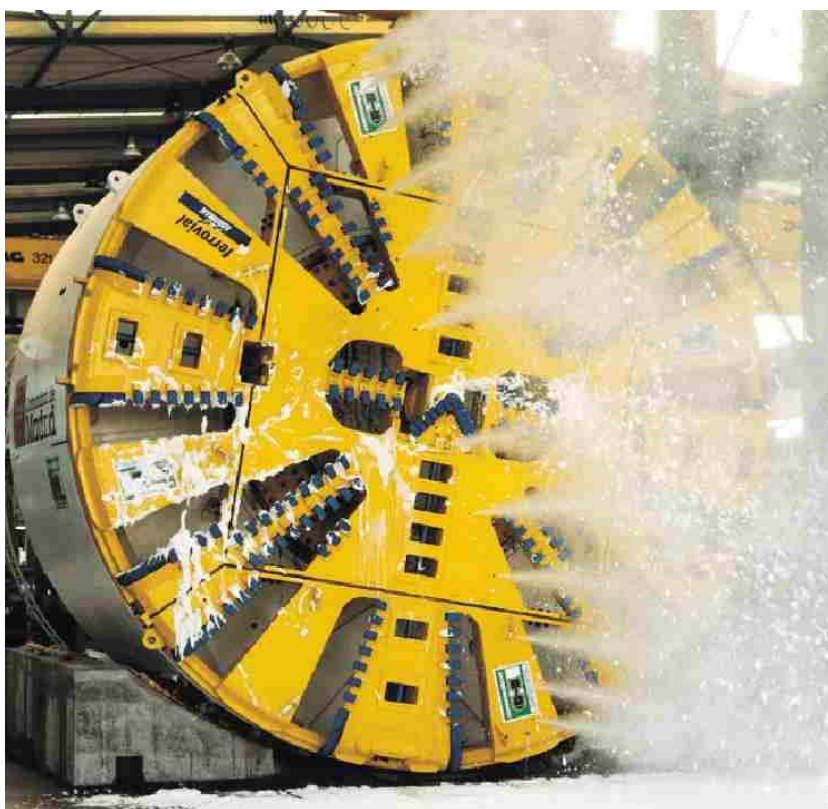
Εικόνα 2.16: Διαδικασία ελέγχου εισπίεσης αφρού στην κοπτική κεφαλή ενός μηχανήματος EPB (Tunnelseis n.d.).
