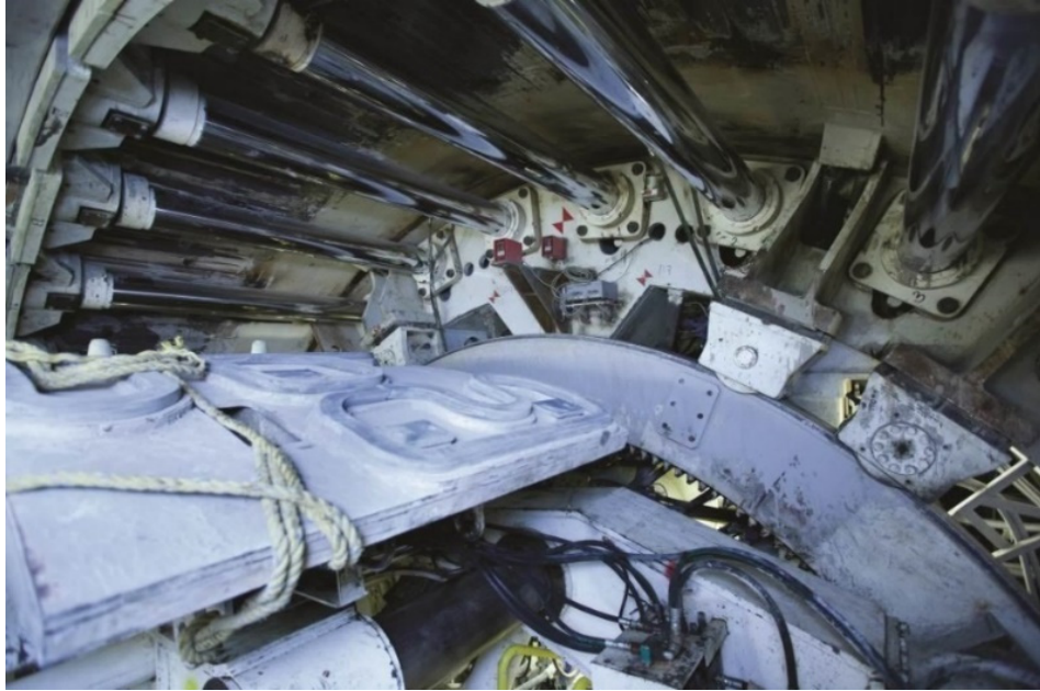
Σχήμα 2.11 Υδραυλικά έμβολα ώθησης σε μηχανήμα EPB διαμέτρου 8.9m της εταιρίας Robbins (Robbins n.d.)
