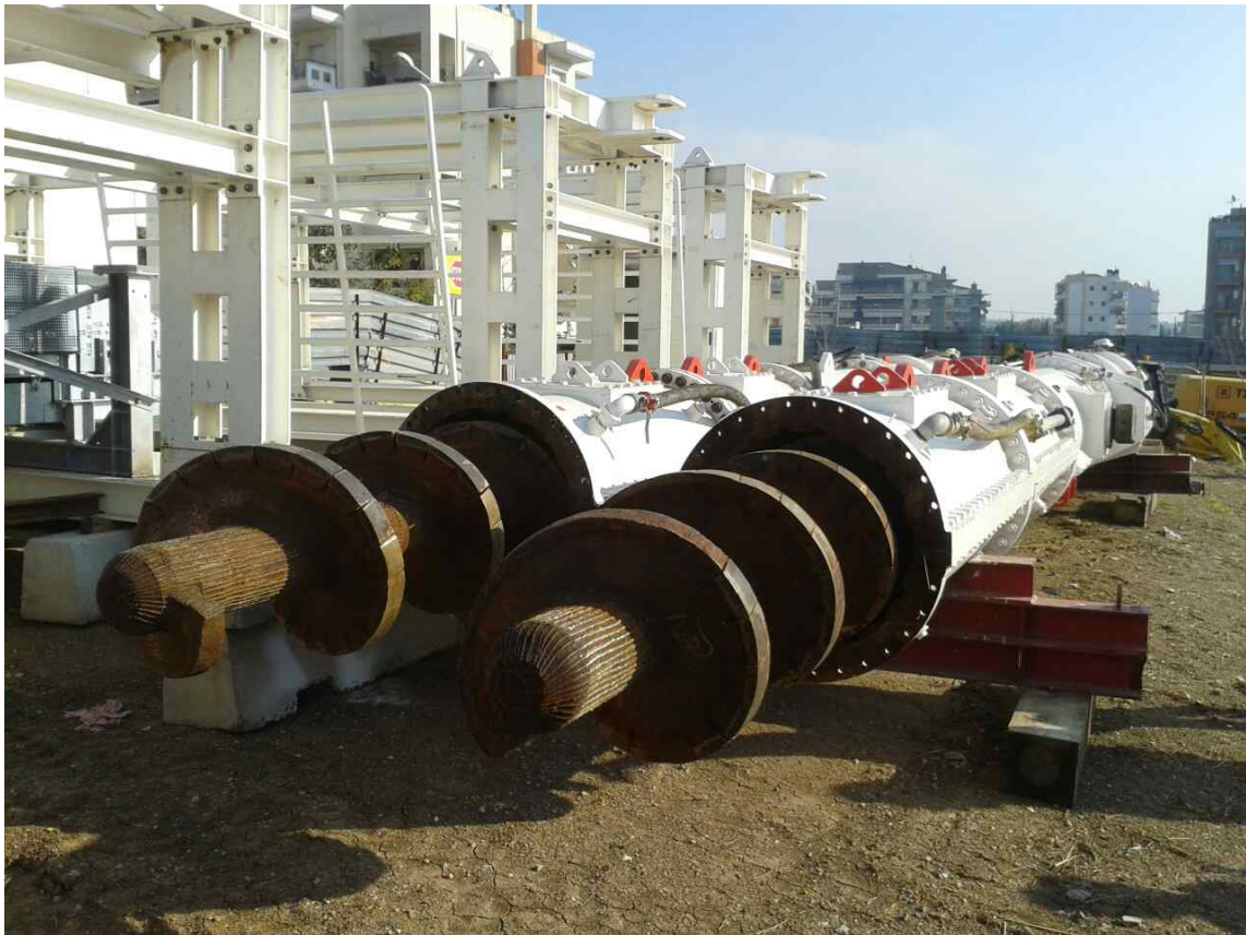
Σχήμα 2.10 Ατέρμονας κοχλίας με κεντρικό στέλεχος, ΜΕΤΡΟ Θεσσαλονίκης.
