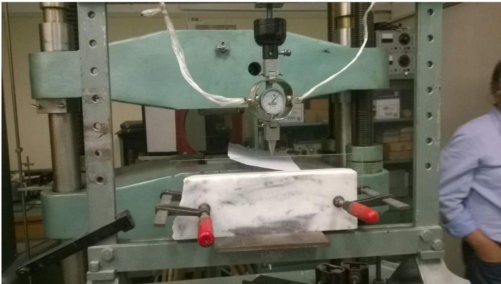
Εικόνα 4. Διάταξη φόρτισης του δοκιμίου.
