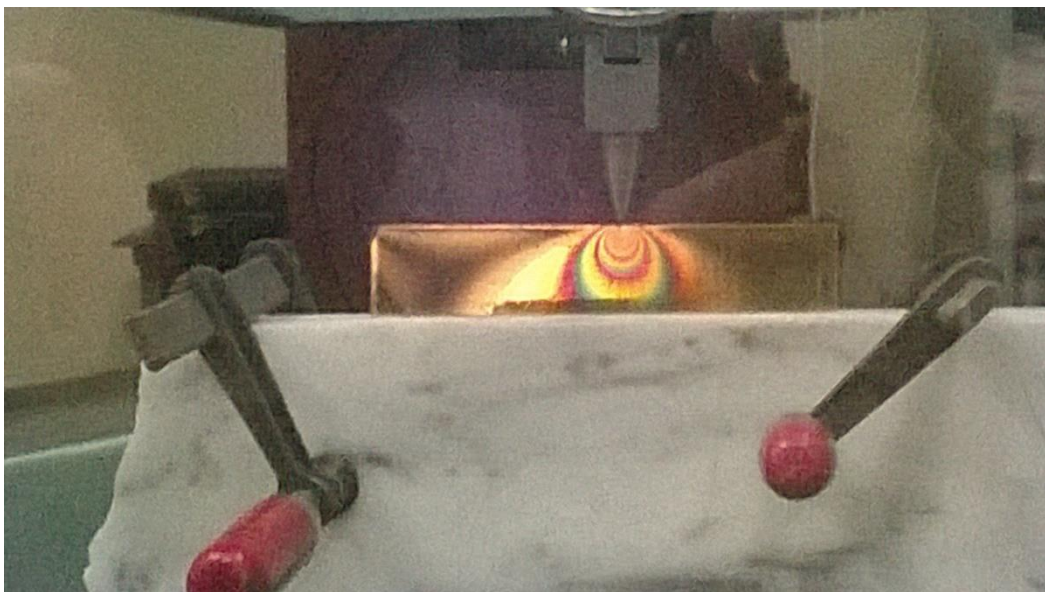
Εικόνα 8. Εμφάνιση έγχρωμων ισόχρωμων κροσσών κατά την φόρτιση του δοκιμίου λόγω φωτισμού με λευκό φως.
