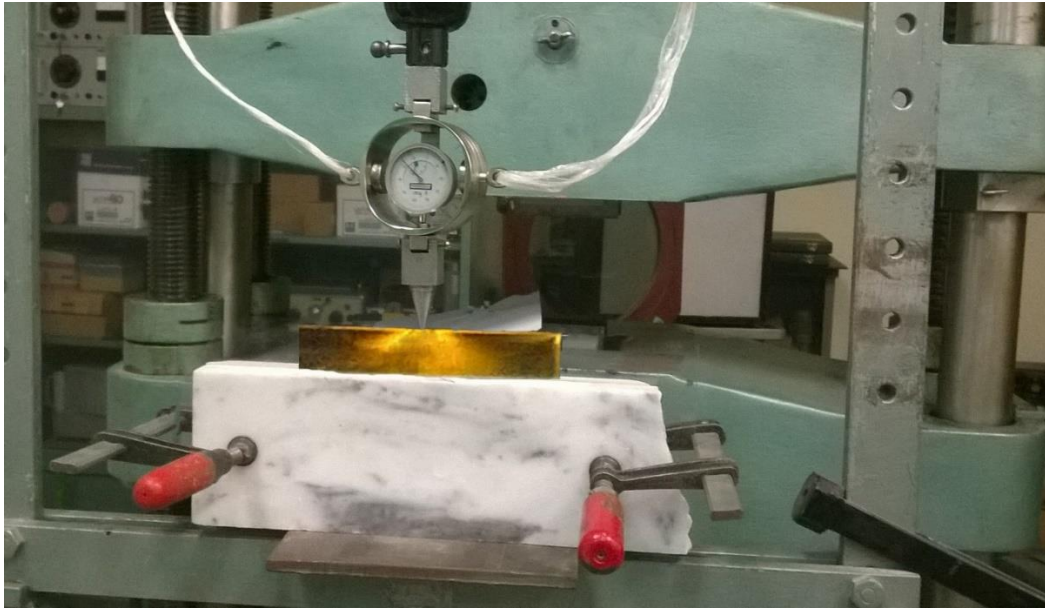
Εικόνα 7. Διάταξη φόρτισης του δοκιμίου από ρητίνη.
