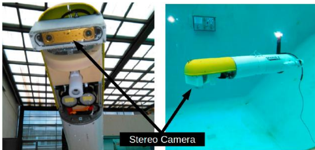
Εικόνα 6 :Το AUV και η τοποθετημένη στερεοσκοπική κάμερα [2].
