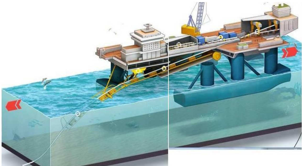
Σχήμα 20 Σκάφος πόντισης σωλήνων. Πηγή: [42]
