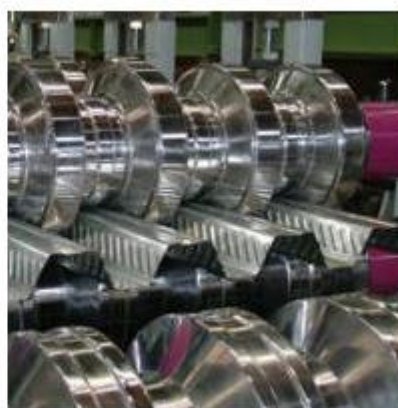
Σχήμα 1.9. Τελικό στάδιο θερμής έλασης διατομής I (αριστερά) και εν ψυχρώ έλαση χαλυβδόφυλλων για σύμμικτες πλάκες (δεξιά)
