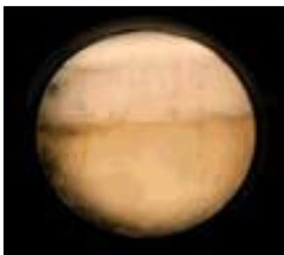
Εικ. 18. Αυξάνοντας περαιτέρω τη θερμοκρασία, οι πυκνότητες του αερίου και του υγρού τείνουν να εξομοιωθούν. Ο μηνίσκος εξασθενεί αν και παραμένει ορατός.
