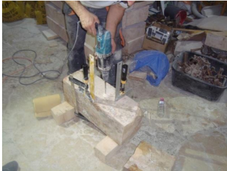
Εικόνα 43. Διαδικασία διάνοιξης της οπής κάθετα στην επιφάνεια του μαρμάρου
