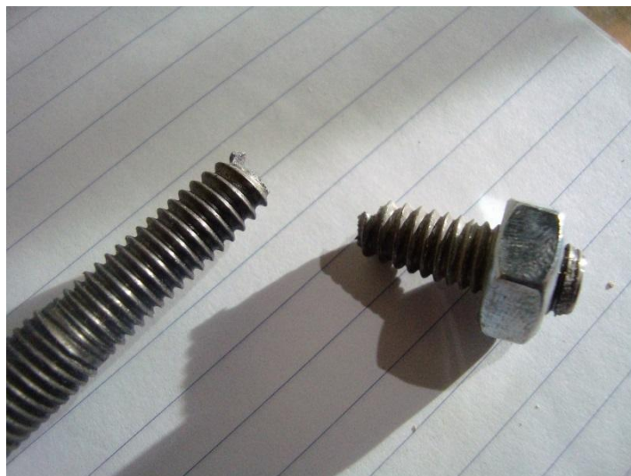
Εικόνα 46. Διαρροή της ράβδου στο κάτω σπείρωμα Πηγή: Προσωπικό αρχείο
