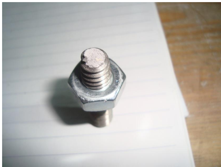
Εικόνα 44. Διαρροή της ράβδου στο άνω σπείρωμα Πηγή: Προσωπικό αρχείο
