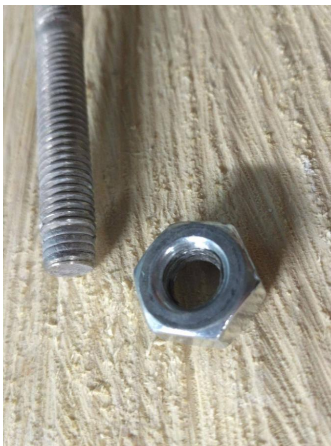
Εικόνα 65 . Αστοχία των βολτών του σπειρώματος
