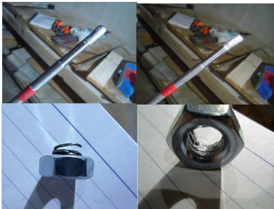
Εικόνα 42. Αστοχία σπειρώματος και περικοχλίου Πηγή: Προσωπικό Αρχείου
