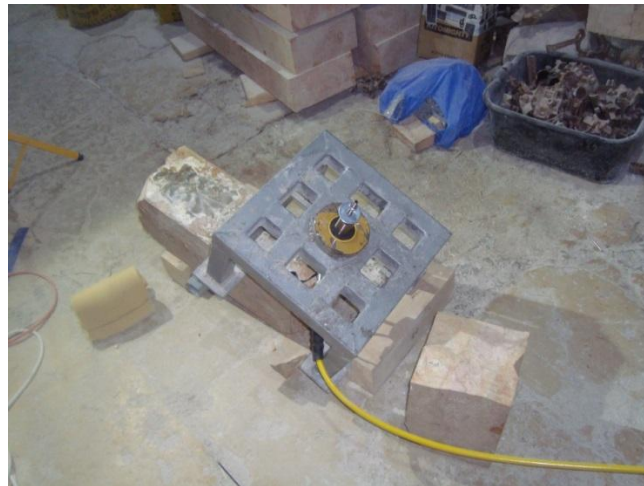
Εικόνα 39. Η διάταξη μετά τη θραύση του μαρμάρου Πηγή: Προσωπικό αρχείο
