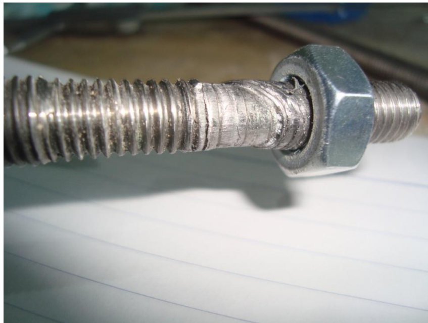
Εικόνα 48. Αστοχία του άνω σπειρώματος στη ράβδο Πηγή: Προσωπικό αρχείο
