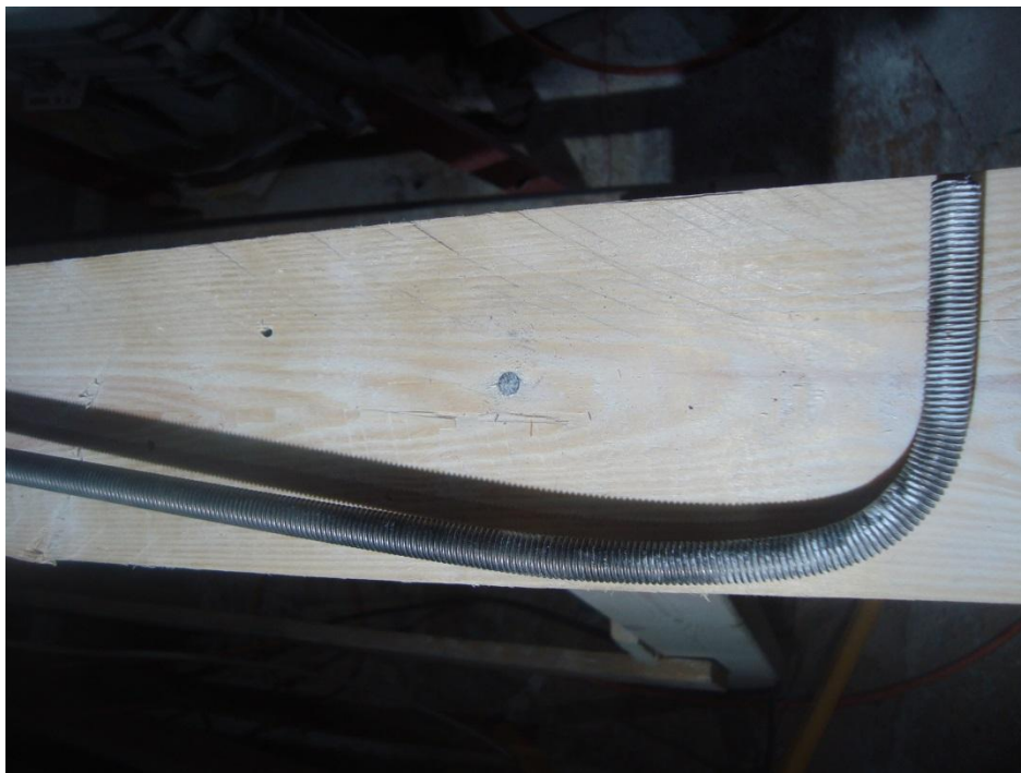
Εικόνα 55. Η μορφή της ράβδου μετά την εξόλκευση Πηγή: Προσωπικό αρχείο
