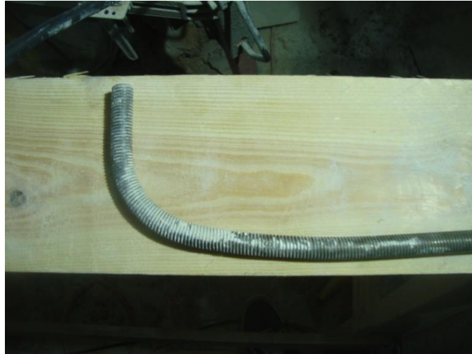
Εικόνα 50. Η μορφή της ράβδου μετά την εξόλκευση Πηγή: Προσωπικό αρχείο
