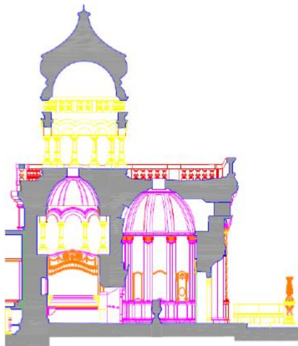
Εικόνα 13. Τομή Ιερού Κουβουκλίου κατά τη διεύθυνση Δύση-Ανατολή
