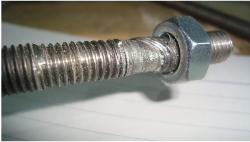
Εικόνα 47. Αστοχία του άνω σπειρώματος στη ράβδο Πηγή: Προσωπικό αρχείο
