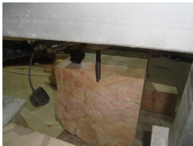
Εικόνα 40. Η επιφάνεια θραύσης του μαρμάρου Πηγή: Προσωπικό αρχείο
