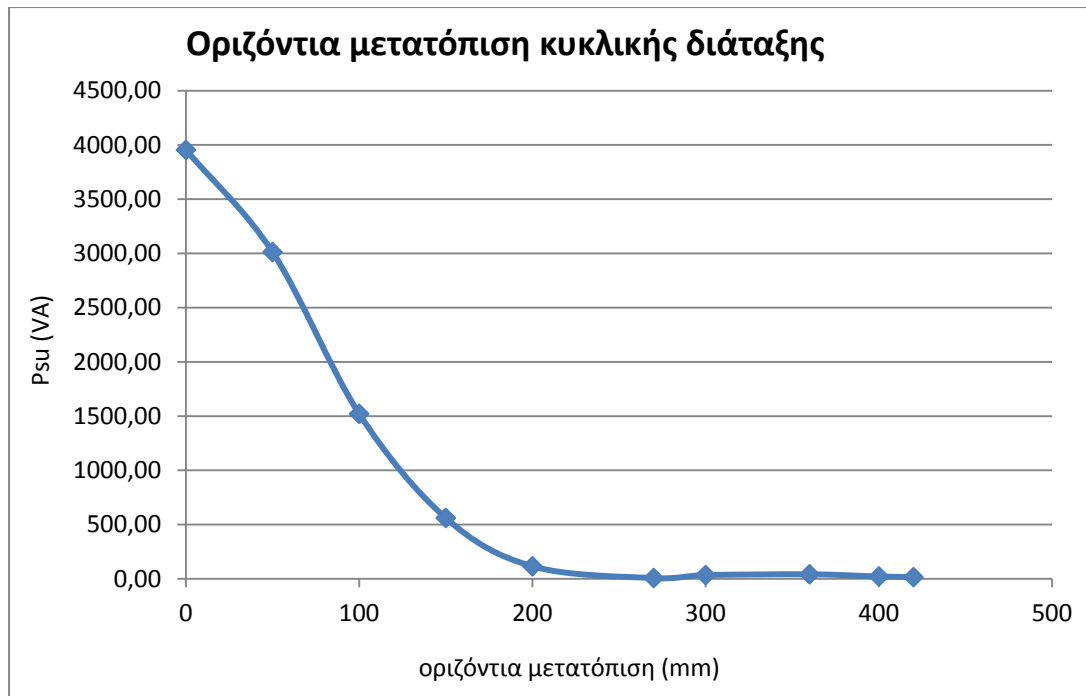
Διάγραμμα 3.5: Τιμές ισχύος για οριζόντιες αποκλίσεις της κυκλικής διάταξης με τυλίγματα-φerrίτη σε βέλτιστες θέσεις και διάκενο 5cm.
