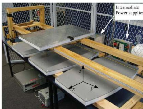
Σχήμα 1.17: Σταθμός δυναμικής φόρτισης με πολλά πρωτεύοντα.
