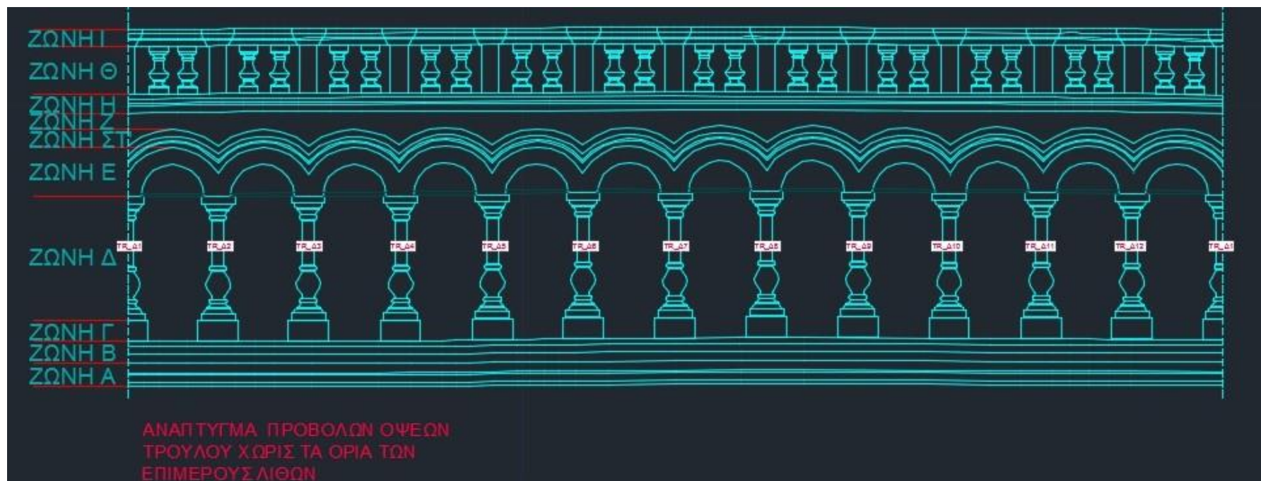
Εικόνα 3.5: Ανάπτυγμα προβολών όψεων Τρούλου χωρίς τα όρια των λίθων. 14
