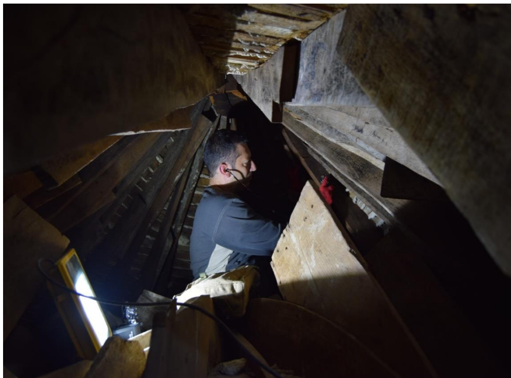
Εικόνα 6.16: Ο κ. Τσαγκαράκης κατά τη διαδικασία ακρόασης των ξυλοφάγων εντόμων με στηθοσκόπιο.
