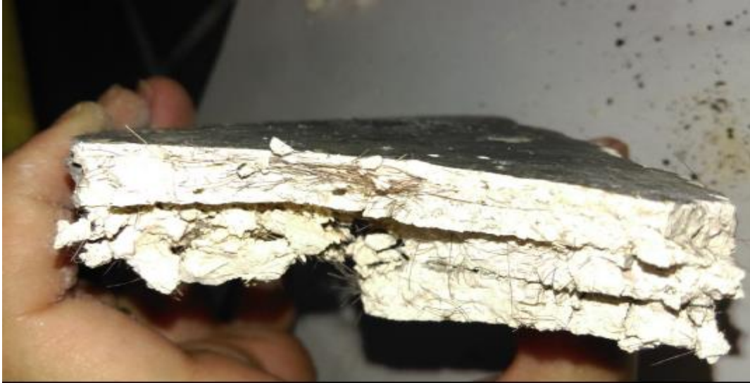
Εικόνα 4.3: Σοβάς τριών στρώσεων συνολικού πάχους 3cm.
