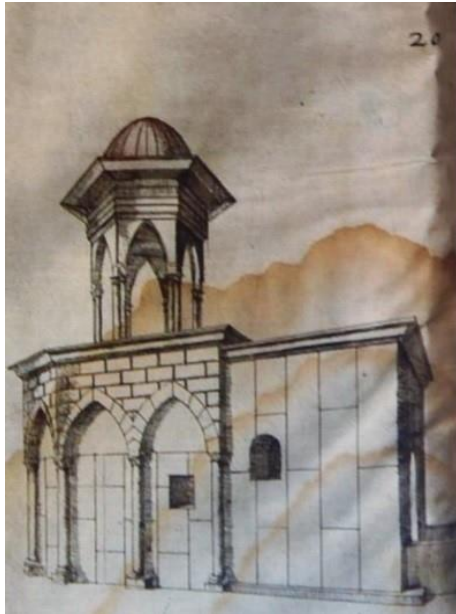
Εικόνα 2.15: Άποψη του Ιερού Κουβουκλίου και του τρούλου με έξι διπλά στηρίγματα. (Σχέδιο του Bernardino Amico, 1609).
