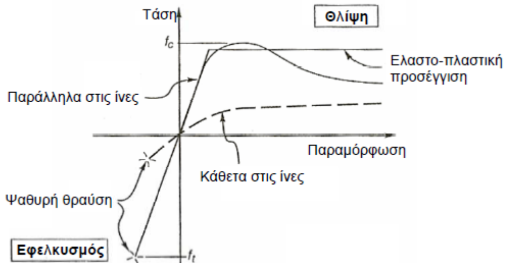
Σχηματικό διάγραμμα 4.3 τάσεων παραμορφώσεων ξύλου, για φόρτιση παράλληλα προς τις ίνες (συνεχής καμπύλη) και κάθετα στις ίνες (διακεκομμένη καμπύλη), υπό συνήθεις θερμοκρασίες.
