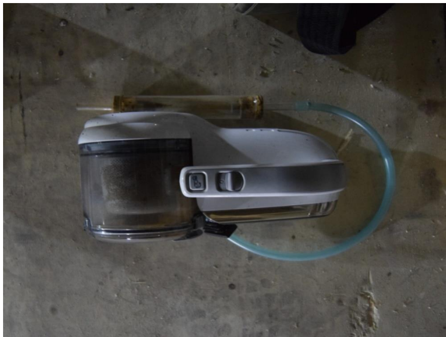
Εικόνα 6.15: Σκουπάκι μπαταρίας με αναρροφητήρα (ιδιοκατασκευή κ. Τσαγκαράκη).
