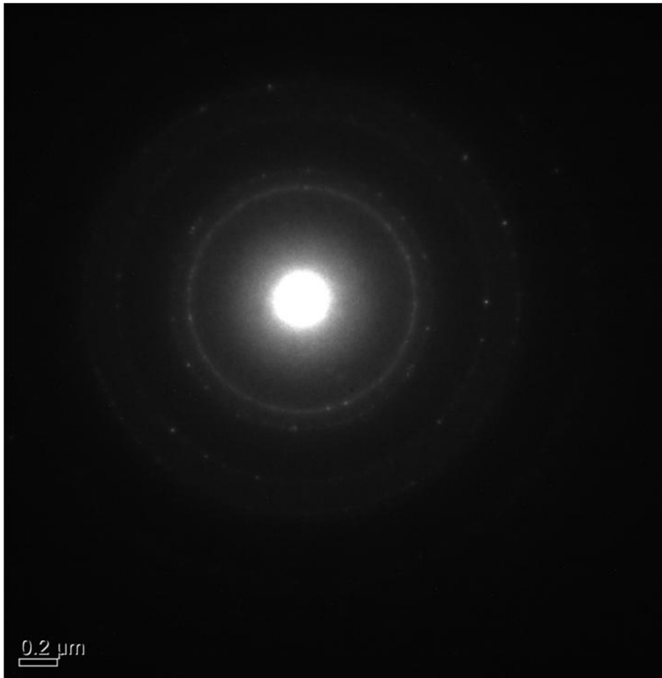
Σχήμα 24. Φάσμα περίθλασης ηλεκτρονίων με το ηλεκτρονικό μικροσκόπιο διέλευσης (TEM), το οποίο υποδεικνύει μικρή κρυσταλλικότητα και ασυνήθιστα στίγματα.
