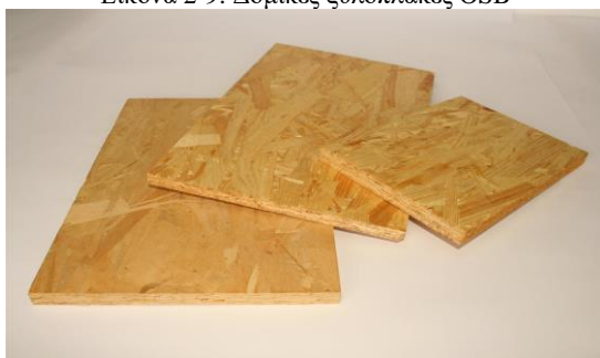
Εικόνα 2-10: Προσανατολισμός στρώσεων σε ξυλόπλακες OSB
