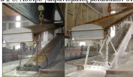
Εικόνα 2-8: Λουτρό γαλβανίσματος μεταλλικών στοιχείων
