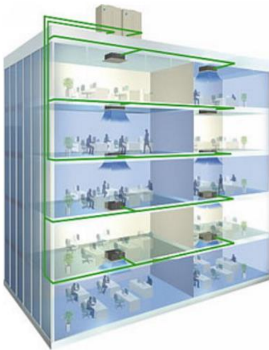
Σχήμα 6.3: Σχηματική απεικόνιση συστήματος VRF [51]
