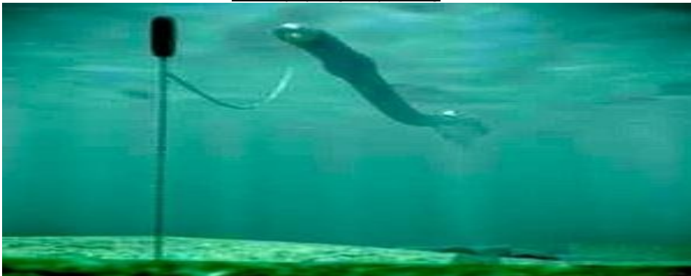
Εικόνα 4.21: Τεχνολογία Anasconda. Μακρόστενος εύκαμπτος σωλήνας που εκμεταλλεύεται τις παλινδρομικές Διογκώσεις [78]
