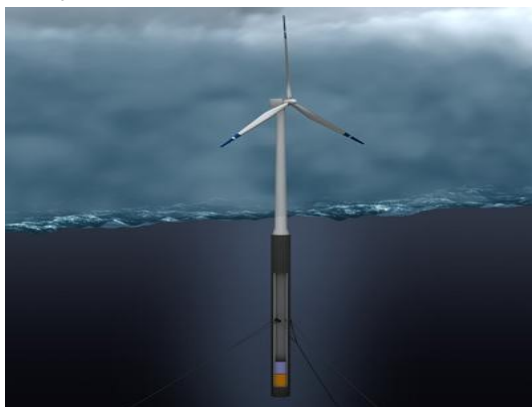
Εικόνα 3.3: Πλωτή κατασκευή τύπου Spar-buoy [46]
