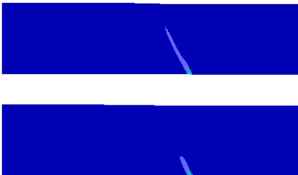
Σχήμα 6.17 Σχηματική απεικόνιση της συσσωρευμένης διατμητικής παραμόρφωσης σε αμμώδη στρώση σχετικής πυκνότητας D_r=50\% για διάρρηξη κανονικού ρήγματος γωνίας \beta=45^\circ με μετατόπιση h=0.2\text{m} για οριζόντια δομή (άνω) και κατακόρυφη δομή (κάτω) (Σχήματα A-2 και A-11, Παράρτημα A). Οι χρωματισμένες περιοχές αφορούν ζώνες με συσσωρευμένη διατμητική παραμόρφωση μεγαλύτερη από 5%.
