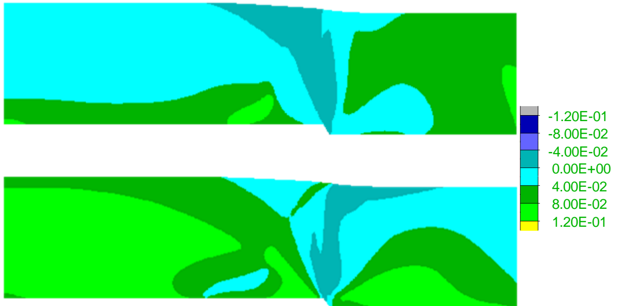
Σχήμα 6.14 Ανισοτροπική παράμετρος κατάστασης \zeta σε αμμώδη στρώση σχετικής πυκνότητας D_r=20\% , για οριζόντια δομή (άνω) και κατακόρυφη δομή (κάτω) για διάρρηξη «κατακόρυφου» ρήγματος γωνίας \beta=85^\circ για μετατόπιση h = 1.6m (Σχήματα A-25 και A-34, Παράρτημα Α).
