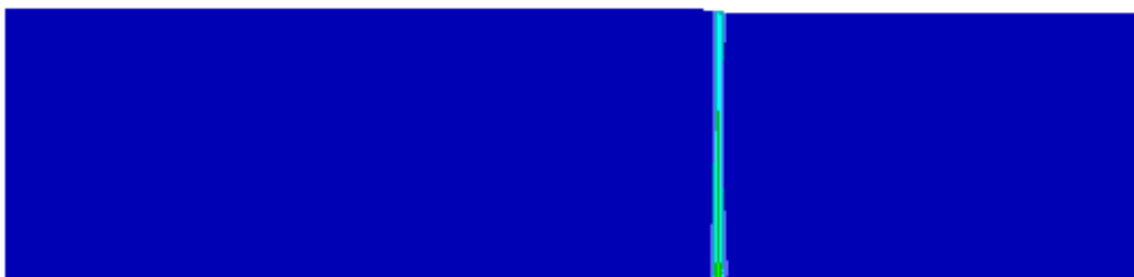
Σχήμα 6.43 Σχηματική απεικόνιση της συσσωρευμένης διατμητικής παραμόρφωσης σε αμμώδη στρώση σχετικής πυκνότητας D_r=80\% για διάρρηξη «κατακόρυφου» ρήγματος γωνίας \beta=85^\circ με μετατόπιση h=0.4\text{m} για οριζόντια δομή (άνω) και κατακόρυφη δομή (κάτω) (Σχήματα A-9 και A-18, Παράρτημα A). Οι χρωματισμένες περιοχές αφορούν ζώνες με συσσωρευμένη διατμητική παραμόρφωση μεγαλύτερη από 5%.
