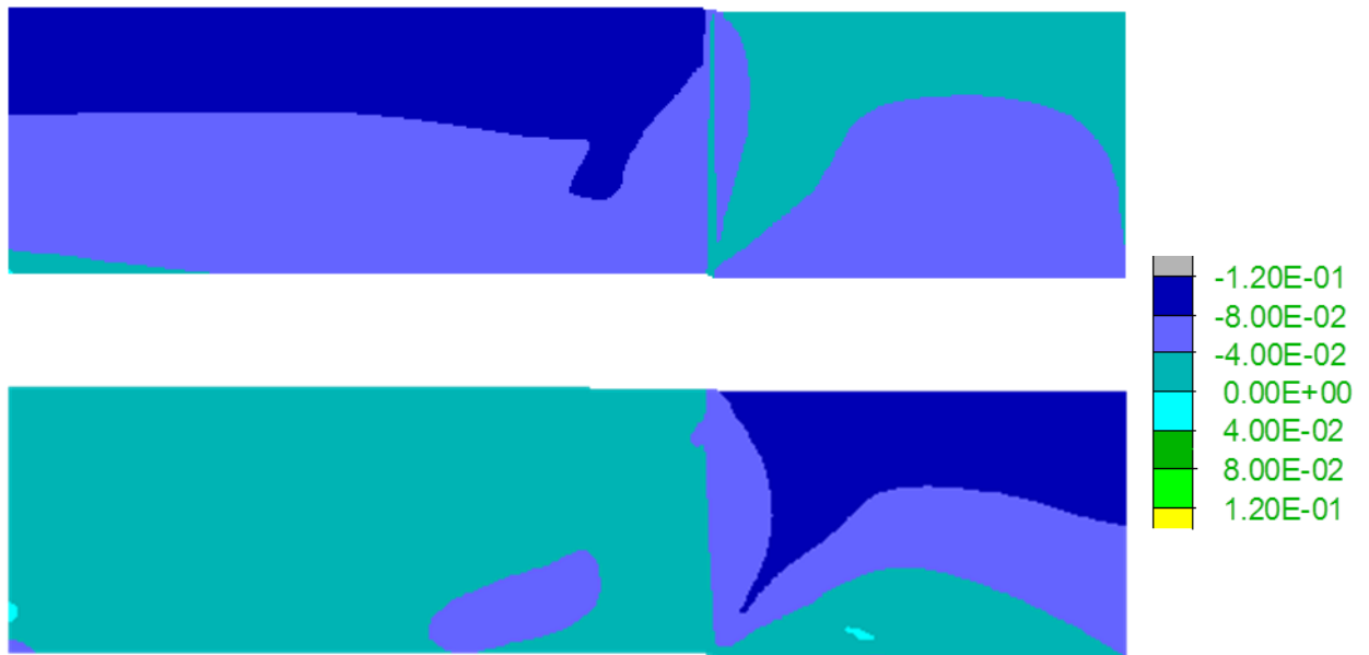
Σχήμα 6.29 Ανισοτροπική παράμετρος κατάστασης \zeta σε αμμώδη στρώση σχετικής πυκνότητας D_r=50\% , για οριζόντια δομή (άνω) και κατακόρυφη δομή (κάτω), για διάρρηξη «κατακόρυφου» ρήγματος γωνίας \beta=85^\circ για μετατόπιση h = 0.4\text{m} (Σχήματα A-26 και A-35, Παράρτημα Α).
