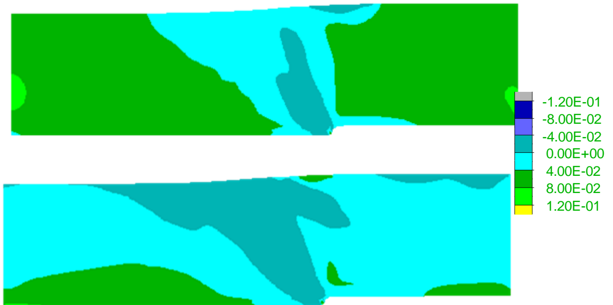
Σχήμα 6.9 Ανισοτροπική παράμετρος κατάστασης \zeta σε αμμώδη στρώση σχετικής πυκνότητας D_r=20\% , για οριζόντια δομή (άνω) και κατακόρυφη δομή (κάτω) για διάρρηξη ανάστροφου ρήγματος γωνίας \beta=135^\circ για μετατόπιση h = 1.6\text{m} (Σχήματα A-22 και A-31, Παράρτημα Α).
