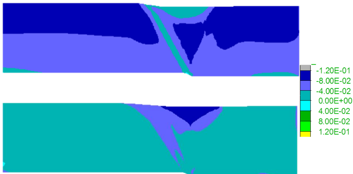
Σχήμα 6.19 Ανισοτροπική παράμετρος κατάστασης \zeta σε αμμώδη στρώση σχετικής πυκνότητας D_r=50\% , για οριζόντια δομή (άνω) και κατακόρυφη δομή (κάτω), για διάρρηξη κανονικού ρήγματος γωνίας \beta=45^\circ με μετατόπιση h = 0.8\text{m} (Σχήματα A-20 και A-29, Παράρτημα Α).
