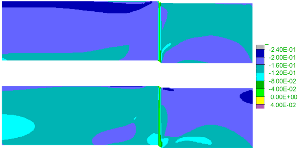
Σχήμα 6.44 Ανισοτροπική παράμετρος κατάστασης \zeta σε αμμώδη στρώση σχετικής πυκνότητας D_r=80\% , για οριζόντια δομή (άνω) και κατακόρυφη δομή (κάτω), για διάρρηξη «κατακόρυφου» ρήγματος γωνίας \beta=85^\circ για μετατόπιση h = 0.8m (Σχήματα A-27 και A-36, Παράρτημα Α).
