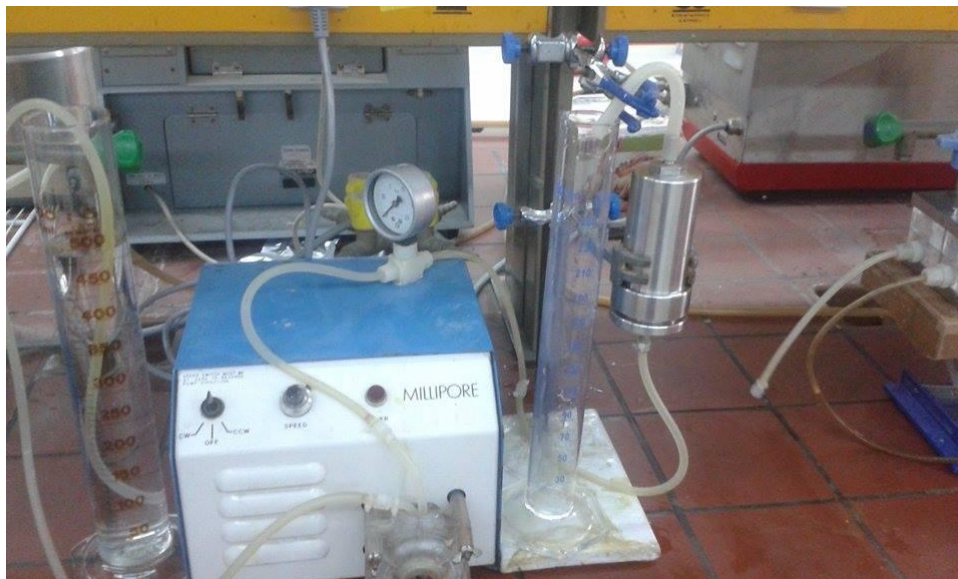
Εικόνα 3.3: Διάταξη εκχύλισης ημιδιαλείποντος έργου
