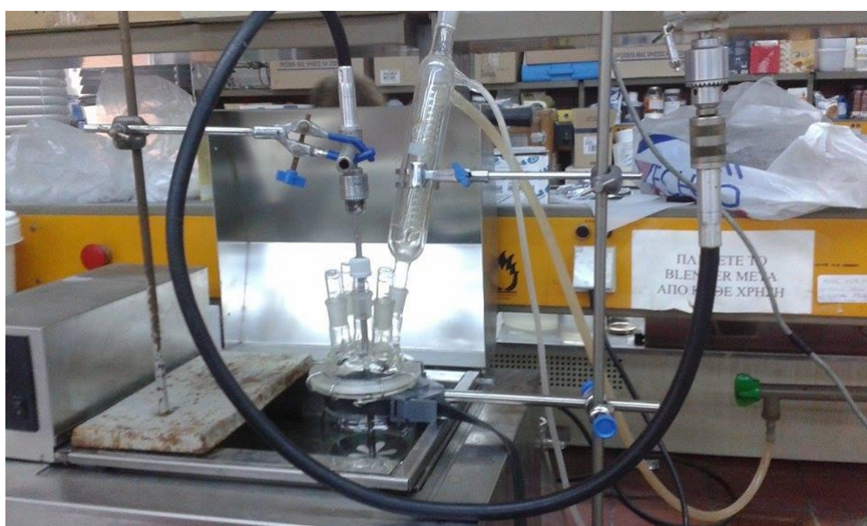
Εικόνα 3.2: Διάταξη εκχύλισης υπό ανάδευση
