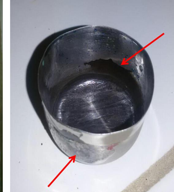
*Σχήμα 4.22 Υπολείμματα στο εσωτερικό και το εξωτερικό του χωνευτηρίου μετά τη σύντηξη δείγματος με CuO ευής*
