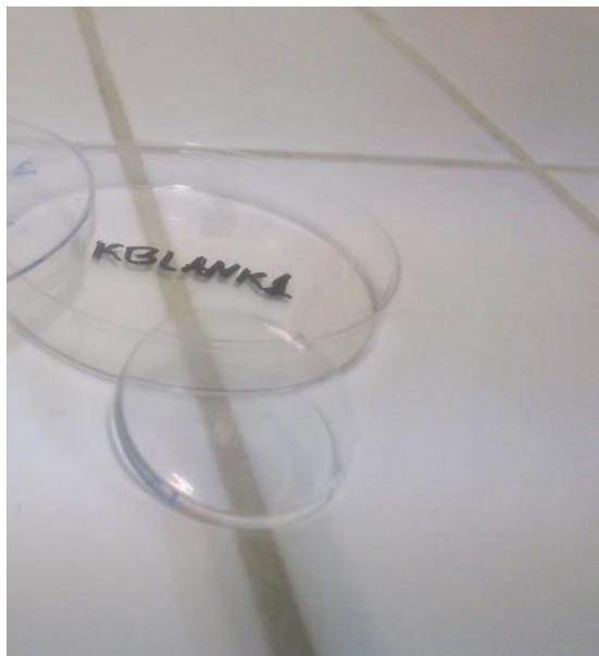
Σχήμα 4.24 Δείγμα «KBLANKI» παρασκευασμένο μόνο με βορικά άλατα
