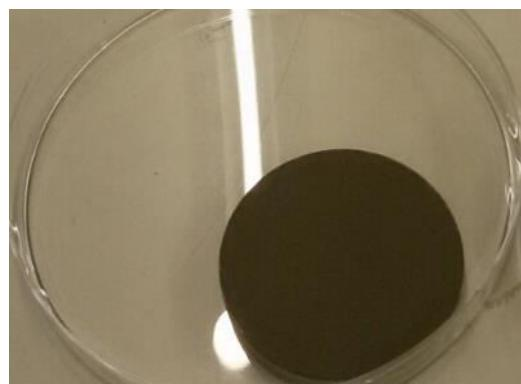
Σχήμα 2.11 Επιτυχής παρασκευή δείγματος ιπτάμενης τέφρας έπειτα από επαναπρεσάρισμα
