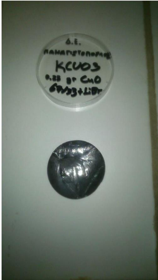
*Σχήμα 4.21 Αποτυχημένο δείγμα σύντηξης 0.25gr CuO*
