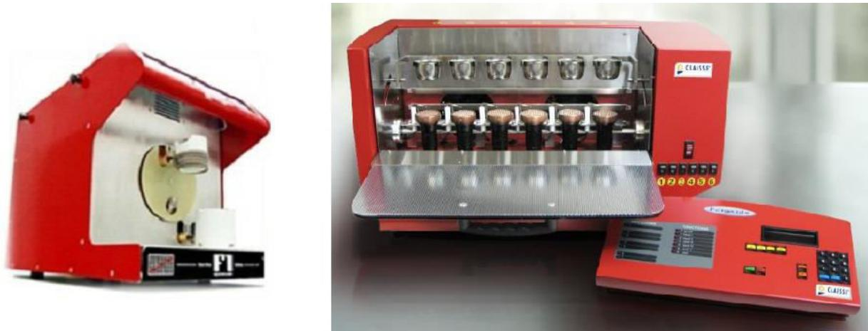
Σχήμα 3.6 (Αριστερά) Συσκευή σύντηξης μίας θέσης (Δεξιά) Συσκευή σύντηξης 6 θέσεων
