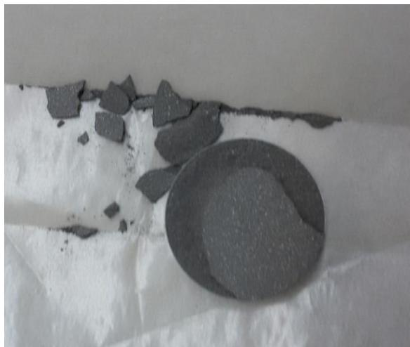
Σχήμα 2.10 Ελαττώματα παρασκευής δείγματος πρέσας
