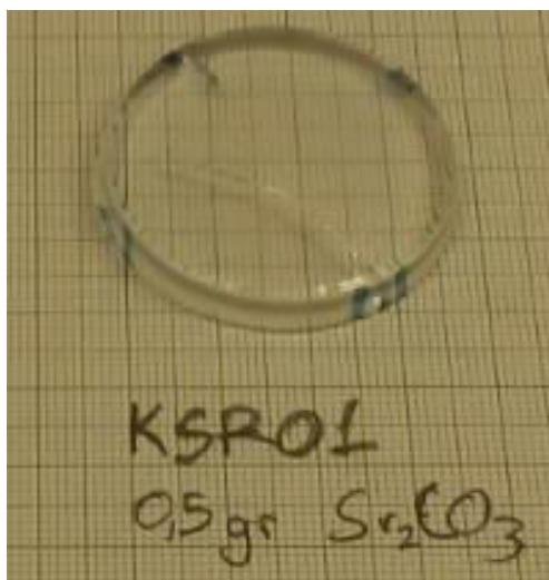
Σχήμα 4.17 Δείγμα σύντηξης με  $\text{SrCO}_3$
