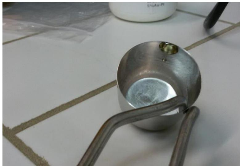
Σχήμα 4.5 Κατακράτηση σταγονιδίων στο χωνευτήριο του Katanax K1 Prime
