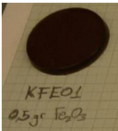
Σχήμα 4.16 Δείγμα σύντηξης με  $Fe_2O_3$
