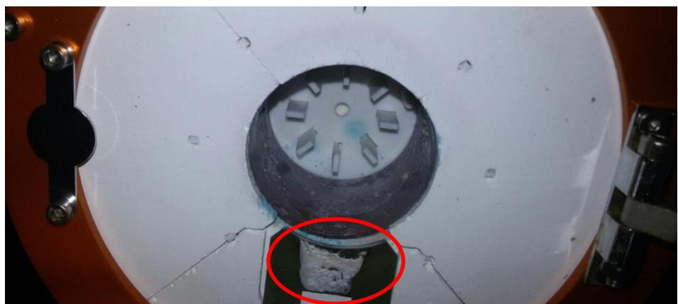
Σχήμα 4.19 συμπύκνωση τήγματος κατά τη σύντηξη δείγματος με ZnO
