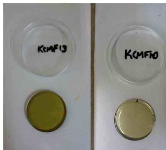
**Σχήμα 4.12:** (α) Δείγμα KCMF13 με 2gr Ιπτάμενης τέφρας και (β) Δείγμα KCMNF10 με 1.2gr Ιπτάμενης τέφρας
