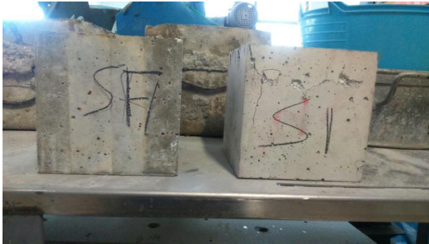
Εικόνα 3.15 Σύγκριση θραυόμενων κυβικών δοκιμών 28 ημερών των συνθέσεων SF1 (με ίνα) και S1 (χωρίς ίνα)
