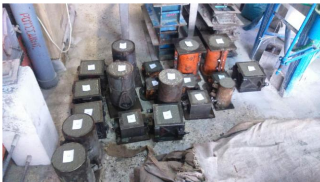
Εικόνα 2.15 Δοκίμα σκυροδέτησης ΣΚ2 μετά το πέρας της δόνησης τους (2/2)
