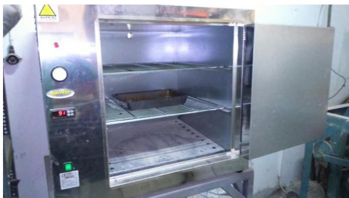
Εικόνα 2.4 Φούρνος ψήσιματος του ΕΟΣ ΕΜΠ που χρησιμοποιήθηκε κατά το ψήσιμο της κίσηρης για τις δοκιμές μέτρησης της υγρασίας
