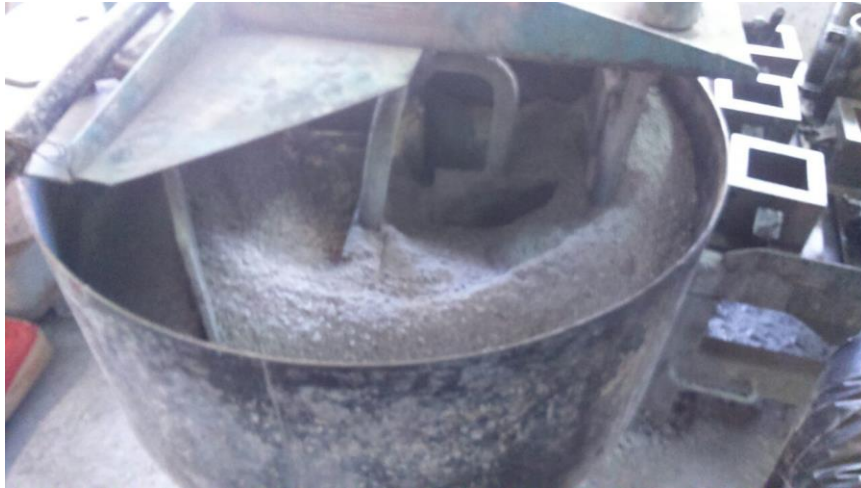
Εικόνα 2.6 Ανάμιξη των αδρανών και του τσιμέντου πριν την εισαγωγή του νερού και των ρευστοποιητών κατά τη ΣΚ1
