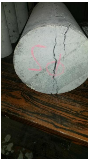
Εικόνες 3.22 και 3.23 Κυλινδρικό δοκίμιο της σύνθεσης S1 μετά τη δοκιμή της διάρρηξης
