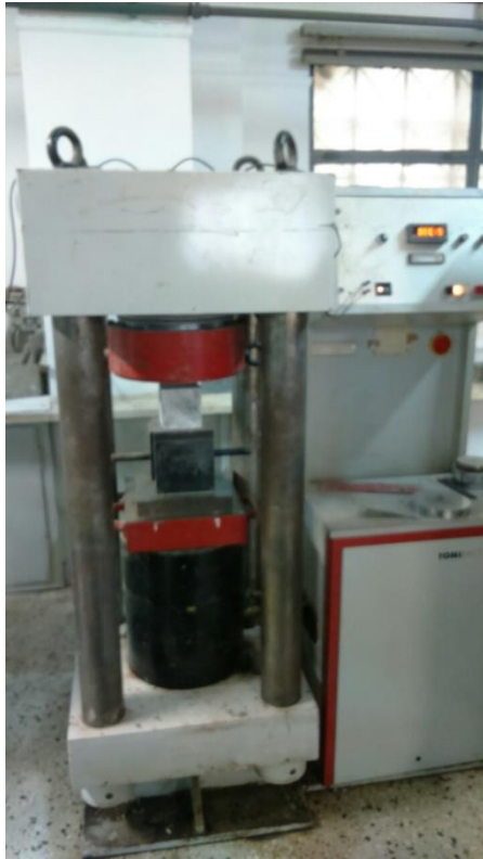
Εικόνες 3.1 και 3.2 Δοκιμές μονοαξονικής θλίψης σε κυβικό δοκίμιο ακμής 10 cm και σε κυλινδρικό δοκίμιο διαμέτρου \Phi 10 cm
