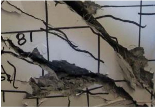
Εικόνα 1.23 Ίνες από χάλυβα οι οποίες εμποδίζουν το άνοιγμα ρωγμών κατά τη διάρκεια δοκιμής σε διάτμηση
