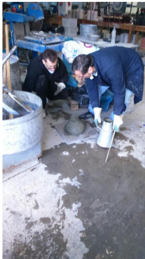
Εικόνες 2.9 και 2.10 Έλεγχος κάθισης του ελαφροσκυροδέματος που παράχθηκε με βάση τη σύνθεση NTUA S1
