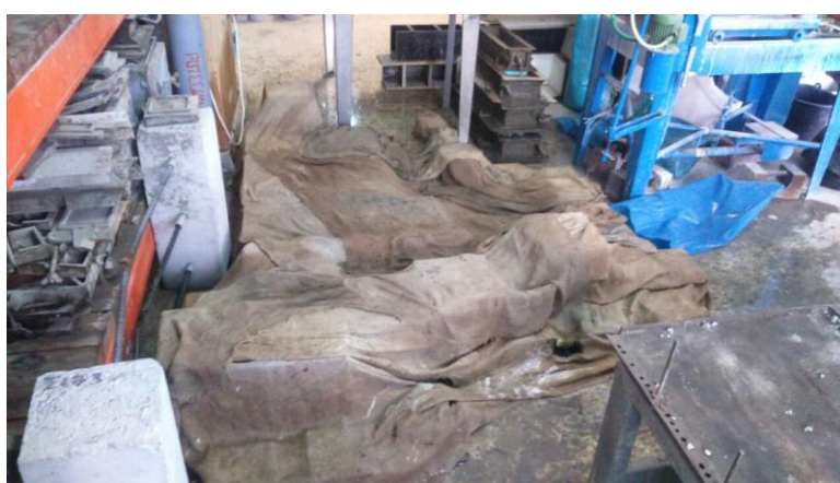
Εικόνα 2.23 Συντήρηση των δοκιμίων της ΣΚ3 πριν το ξεκαλούπωμα με βρεγμένες λινάτσες
