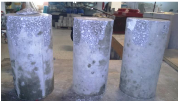
Εικόνες 3.6 και 3.7 Θραυόμενα κυβικά δοκίμια με ίνα 7 ημερών της σύνθεσης S1 και της σύνθεσης SF2 αντίστοιχα
