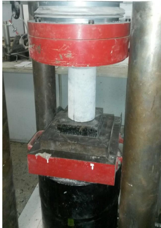
Εικόνες 3.1 και 3.2 Δοκιμές μονοαξονικής θλίψης σε κυβικό δοκίμιο ακμής 10 cm και σε κυλινδρικό δοκίμιο διαμέτρου \Phi 10 cm
