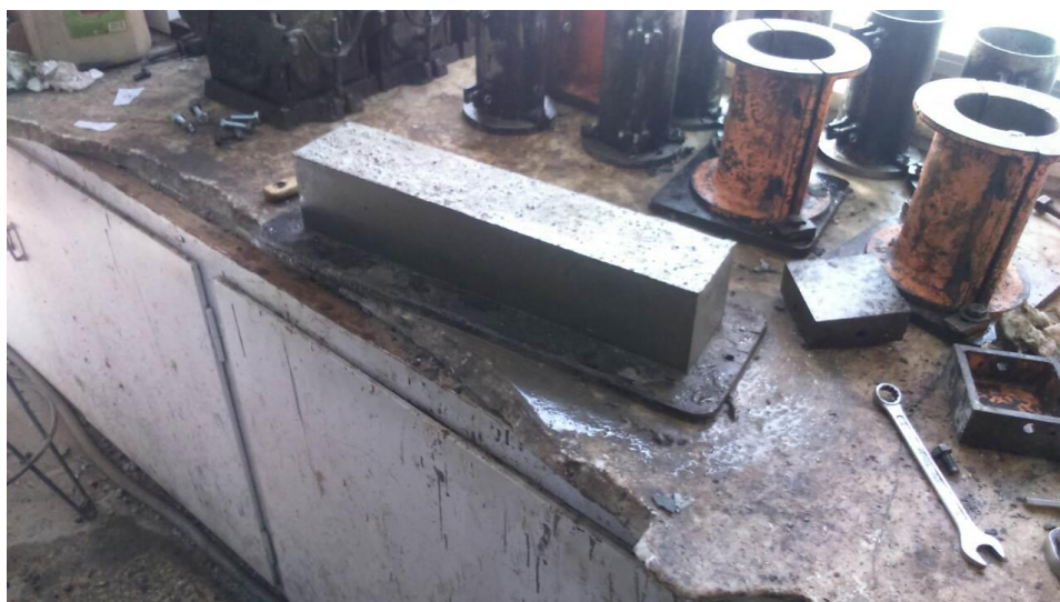
Εικόνα 2.17 Ξεκαλούπωμα πρίσματος σύνθεσης S1
