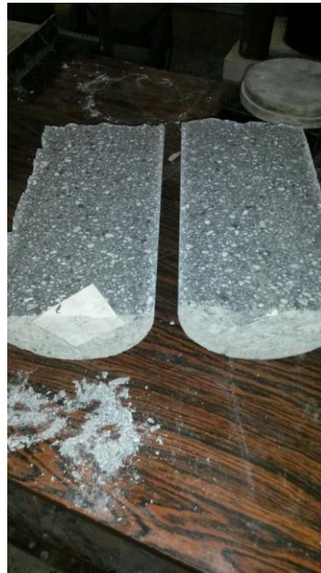
Εικόνες 3.22 και 3.23 Κυλινδρικό δοκίμιο της σύνθεσης S1 μετά τη δοκιμή της διάρρηξης
