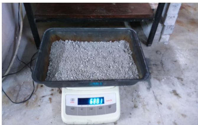
Εικόνα 2.3 Ζυγαριά ακριβείας του ΕΟΣ ΕΜΠ, με την οποία έγιναν οι μετρήσεις του βάρους της κίσηρης πριν και μετά το ψήσιμο για τις δοκιμές μέτρησης της υγρασίας.
