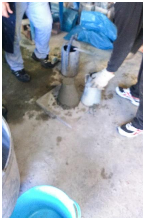
Εικόνες 2.11 και 2.12 Έλεγχος κάθισης του ελαφροσκυροδέματος που παράχθηκε με βάση τη σύνθεση NTUA S2
