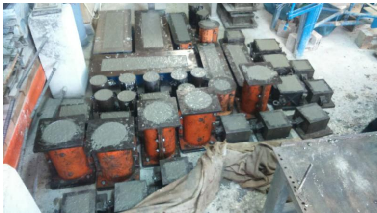
Εικόνα 2.22 Δοκίμια σκυροδέτησης ΣΚ3 μετά το πέρας της δόνησης τους
