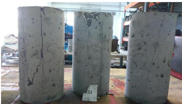
Εικόνες 3.12 και 3.13 Κυλινδρικό δοκίμιο της σύνθεσης S1 των 7 ημερών, ο οποίος παρουσίασε εκκεντρότητα κατά τη φόρτιση και κυλινδρικά δοκίμια της σύνθεσης 7 ημερών της S2 τα οποία παρουσίασαν σφάλμα λόγω τοποθέτησης καπακιού από μόλυβδο, αντίστοιχα.
