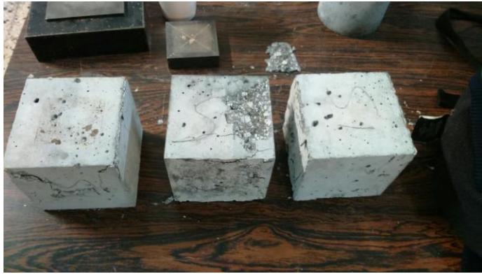
Εικόνα 3.5 Θραυόμενα κυβικά δοκίμια 7 ημερών της σύνθεσης S1
