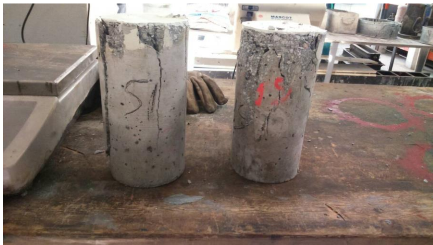
Εικόνα 3.43 Σύγκριση δοκιμών των συνθέσεων S1 και SF1 μετά τη δοκιμή εκτίμησης του μέτρου ελαστικότητας
