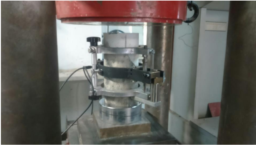
Εικόνα 3.40 Πειραματική διάταξη της δοκιμής εκτίμησης του Μέτρου Ελαστικότητας (πίσω όψη)
