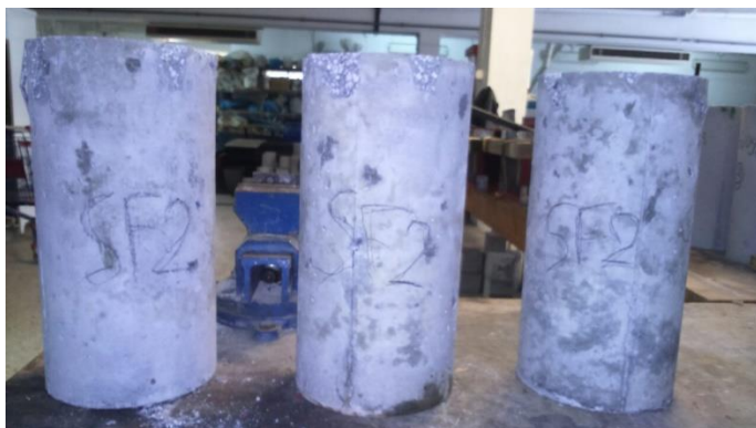
Εικόνες 3.8 και 3.9 Θραυόμενα κυλινδρικά δοκίμια 14 ημερών της σύνθεσης S2 και 7 ημερών της SF2
