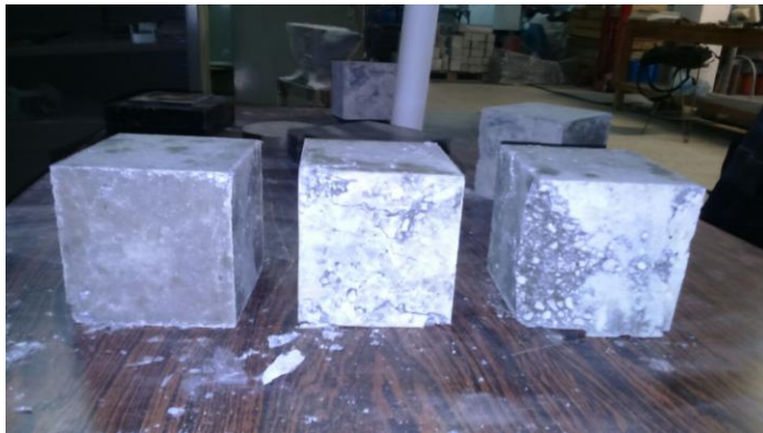
Εικόνες 3.6 και 3.7 Θραυόμενα κυβικά δοκίμια με ίνα 7 ημερών της σύνθεσης S1 και της σύνθεσης SF2 αντίστοιχα
