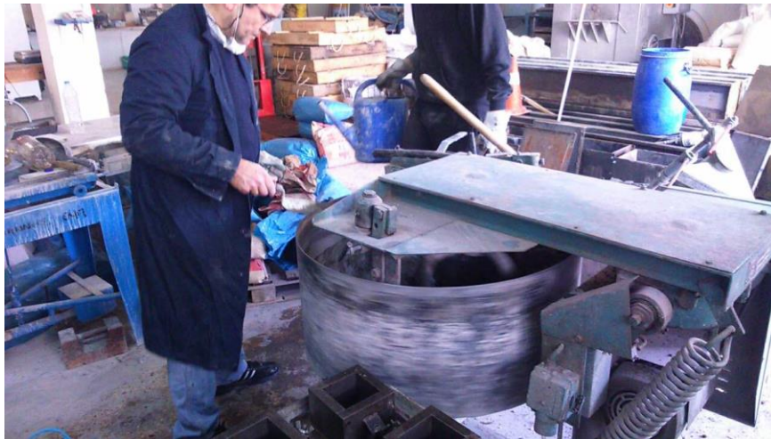
Εικόνα 2.7 Ανάμιξη του μίγματος κατά τη ΣΚ1
