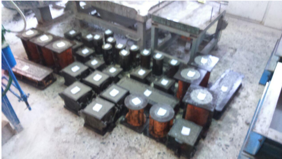
Εικόνα 2.13 Δοκίμα σκυροδέτησης ΣΚ1 μετά το πέρας της δόνησης τους
