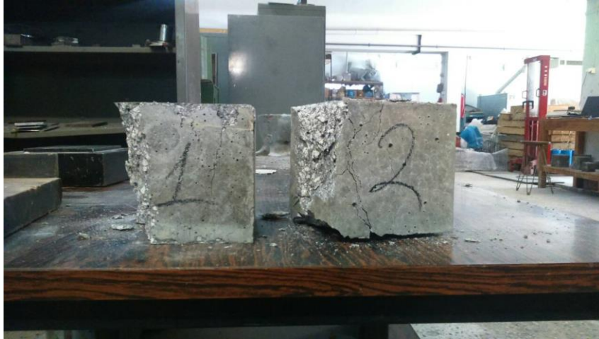
Εικόνα 3.14 Θραυόμενα κυβικά δοκίμια 28 ημερών της σύνθεσης S1, που παρουσίασαν αστοχία λοξότητας φορτίσεως
