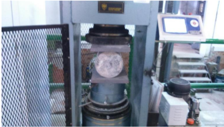
Εικόνα 3.21 Δοκιμή διάρρηξης κυλινδρικού δοκιμίου Φ15*30 cm της σύνθεσης S1
