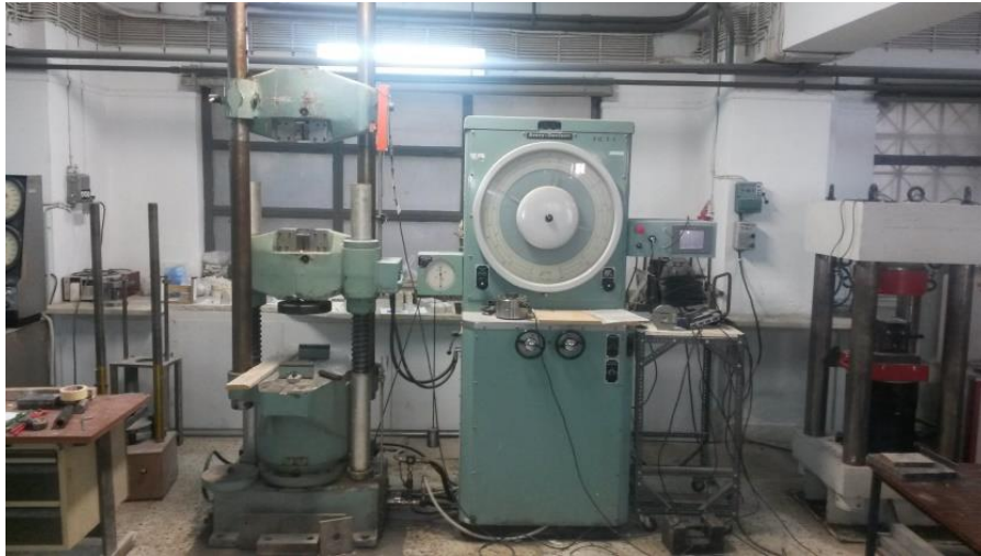
Εικόνα 3.27 Μηχανή θραύσης Avery-Denison αντοχής 600 KN, στην οποία πραγματοποιήθηκαν οι δοκιμές κάμψης 3 σημείων.
