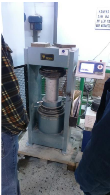
Εικόνες 3.3 και 3.4 Δοκιμές μονοαξονικής θλίψης σε κυλινδρικό δοκίμιο διαμέτρου \Phi 15 cm και σε κυβικό δοκίμιο ακμής 15 cm
