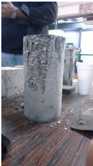
Εικόνες 3.12 και 3.13 Κυλινδρικό δοκίμιο της σύνθεσης S1 των 7 ημερών, ο οποίος παρουσίασε εκκεντρότητα κατά τη φόρτιση και κυλινδρικά δοκίμια της σύνθεσης 7 ημερών της S2 τα οποία παρουσίασαν σφάλμα λόγω τοποθέτησης καπακιού από μόλυβδο, αντίστοιχα.
