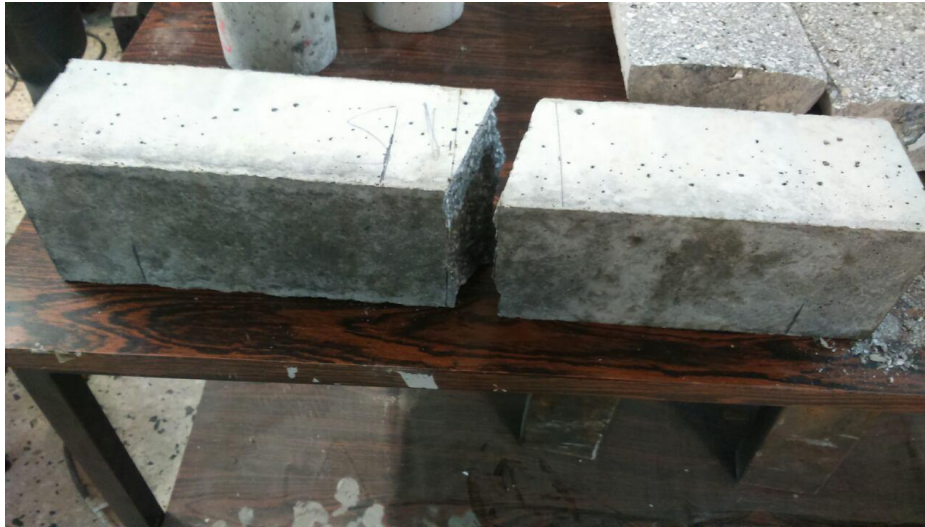
Εικόνα 3.35 Πρισματικό δοκίμιο 1 μετά τη δοκιμή διάρρηξης, όπου φαίνεται το σφάλμα κατά τη θραύση.
