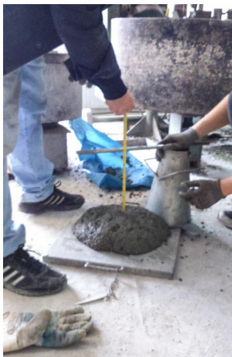
Εικόνα 2.21 Δοκιμή καθίσεως σύνθεσης ινοπλισμένου κισσηρόδεματος SF1
