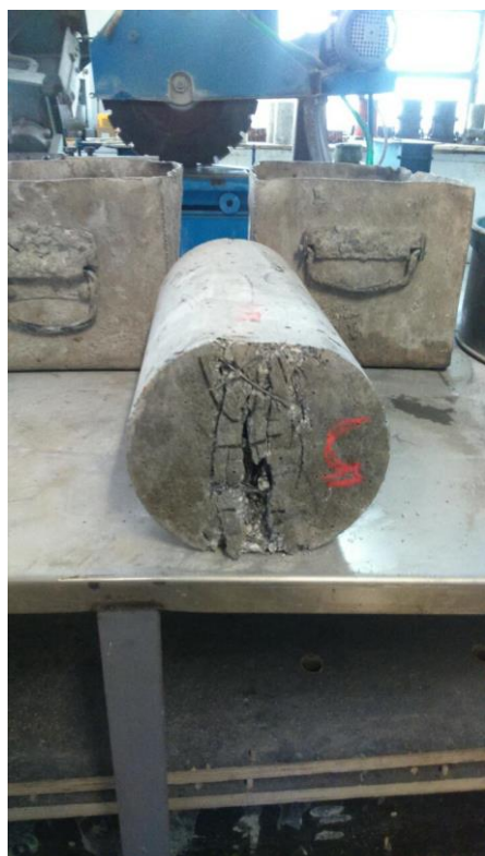
Εικόνα 3.25 Κυλινδρικό δοκίμιο της σύνθεσης SF1 μετά τη διατομή της διάρρηξης
