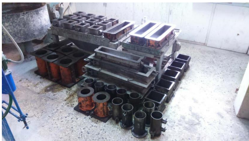
Εικόνα 2.1 Συναρμολογημένες και λαδωμένες μήτρες του ΕΟΣ ΕΜΠ που χρησιμοποιήθηκαν στα πειράματα
