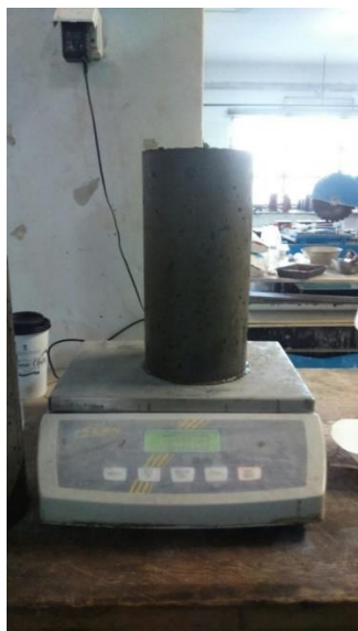
Εικόνα 2.18 Ζύγισμα νωπών κυλίνδρου μετά το ξεκαλούπωμα της σκυροδέτησης SK1
