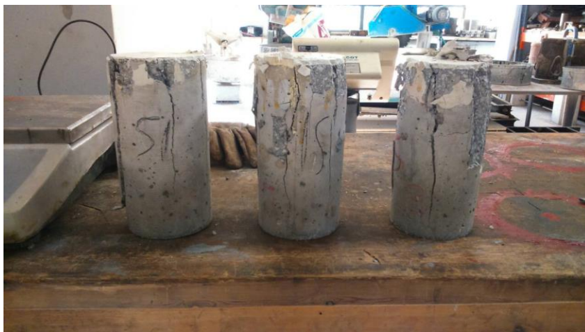
Εικόνα 3.42 Κυλινδρικά δοκίμια \Phi 10 \times 20 μετά τη δοκιμή για την εκτίμηση του Μέτρου Ελαστικότητας
