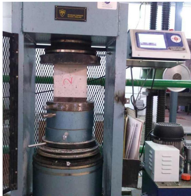
Εικόνες 3.3 και 3.4 Δοκιμές μονοαξονικής θλίψης σε κυλινδρικό δοκίμιο διαμέτρου \Phi 15 cm και σε κυβικό δοκίμιο ακμής 15 cm
