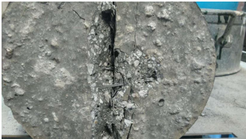
Εικόνα 3.24 Κυλινδρικό δοκίμιο της σύνθεσης SF2 μετά τη δοκιμή σε διάρρηξη
