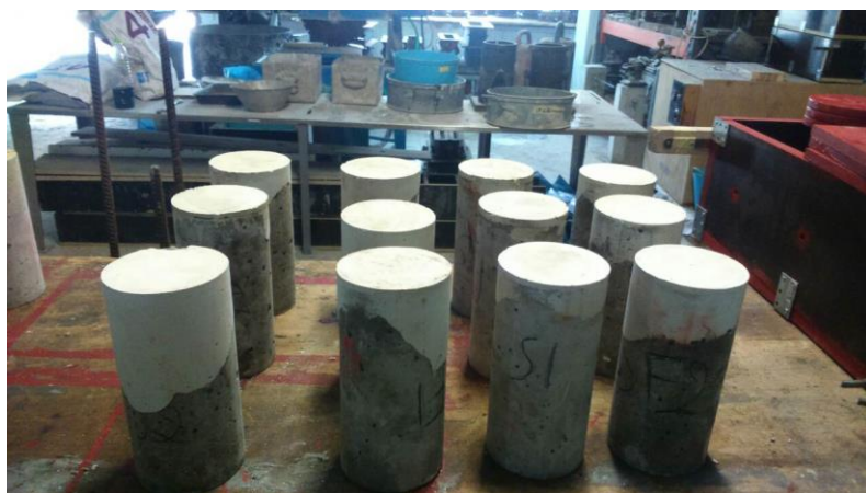
Εικόνα 3.38 «Καπέλωμα» δοκιμών στην επιφάνεια σκυροδέτησης
