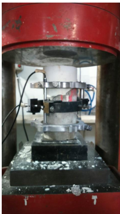
Εικόνα 3.71 Πειραματική διάταξη κατά τη δοκιμή αποτίμησης του λόγου Poisson
