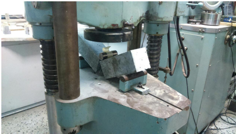
Εικόνα 3.28 Δοκιμή κάμψης 3 σημείων σε πρίσμα διαστάσεων 10*10*50 cm της σύνθεσης S1
