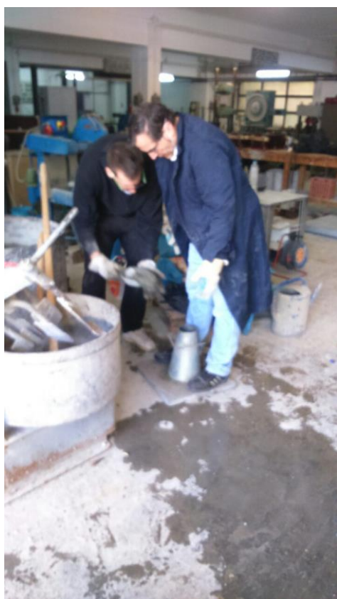
Εικόνες 2.9 και 2.10 Έλεγχος κάθισης του ελαφροσκυροδέματος που παράχθηκε με βάση τη σύνθεση NTUA S1
