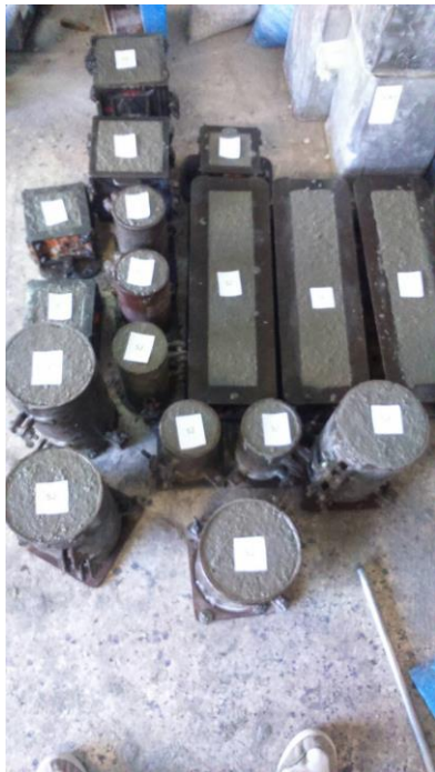
Εικόνα 2.14 Δοκίμα σκυροδέτησης ΣΚ2 μετά το πέρας της δόνησης τους (1/2)
