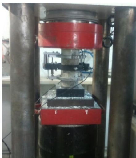
Εικόνα 3.39 Πειραματική διάταξη της δοκιμής εκτίμησης του Μέτρου Ελαστικότητας (πλάγια όψη)
