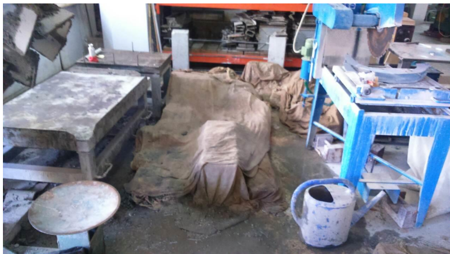
Εικόνα 2.16 Συντήρηση των δοκιμίων πριν το ξεκαλούπωμα με βρεγμένες λινάτσες
