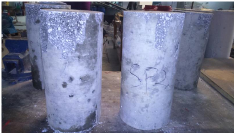
Εικόνες 3.10 και 3.11 Σύγκριση μεταξύ θραυόμενων κυβικών και κυλινδρικών δοκιμών με ή χωρίς ίνα.
