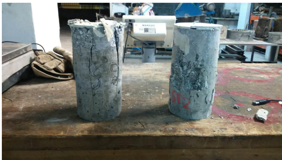
Εικόνα 3.44 Σύγκριση δοκιμών των συνθέσεων S2 και SF2 μετά τη δοκιμή εκτίμησης του μέτρου ελαστικότητας
