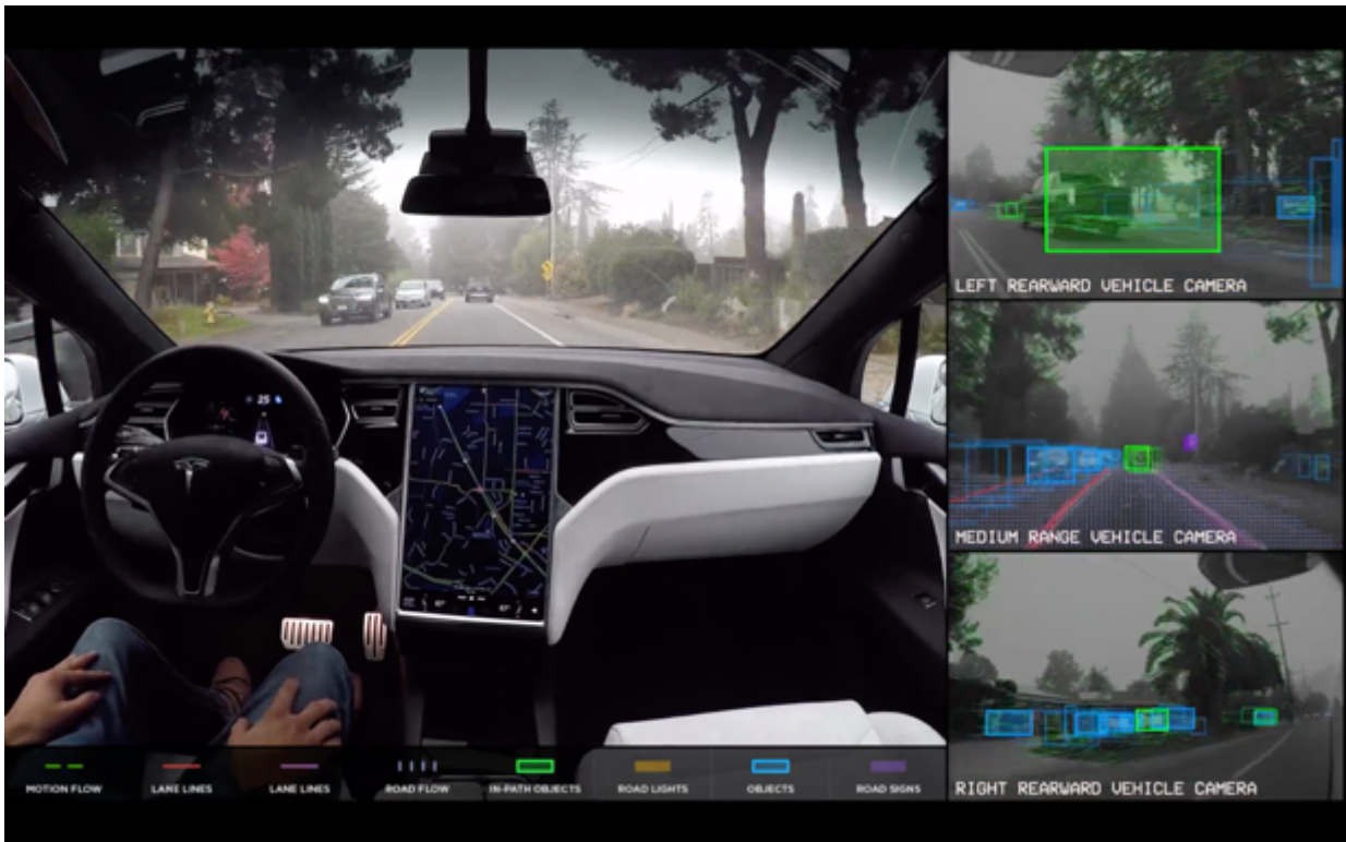
Εικόνα 1.3: Άποψη του εσωτερικού και των καμερών ενός Tesla κατά τη διάρκεια διαδρομής με σύστημα Auto Pilot (Tesla Motors, 2016).
