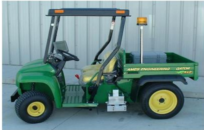
Εικόνα 2.6 Προφιλόμετρο ελαφρού τύπου [16]
