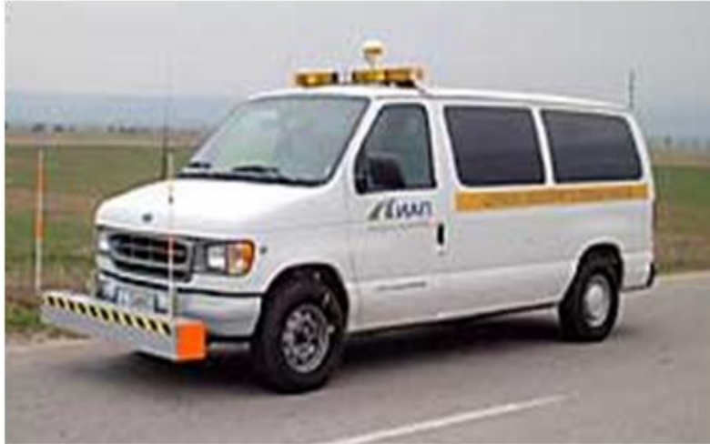
Εικόνα 2.5 Υψηλής ταχύτητας προφιλόμετρο [16]
