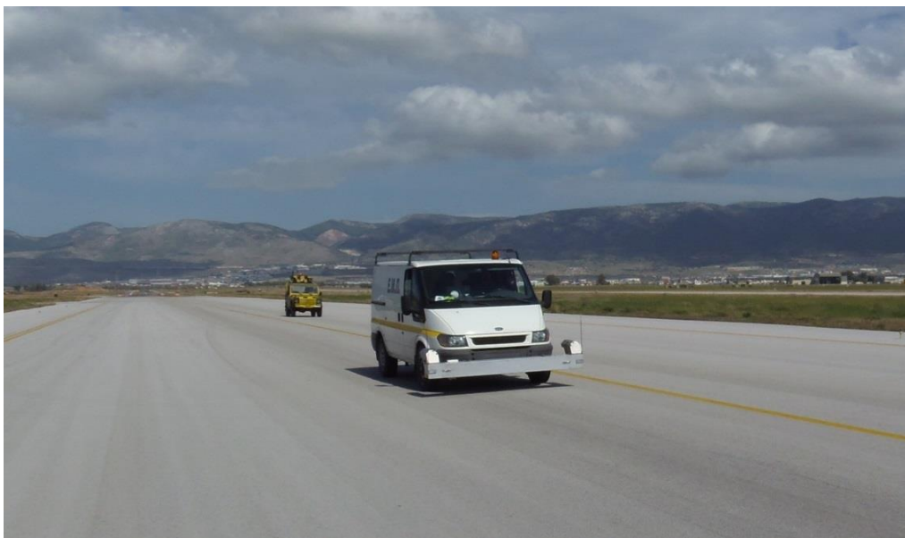
Εικόνα 3.1 Road Surface Profilometer του Εργαστηρίου Οδοποιΐας του ΕΜΠ
