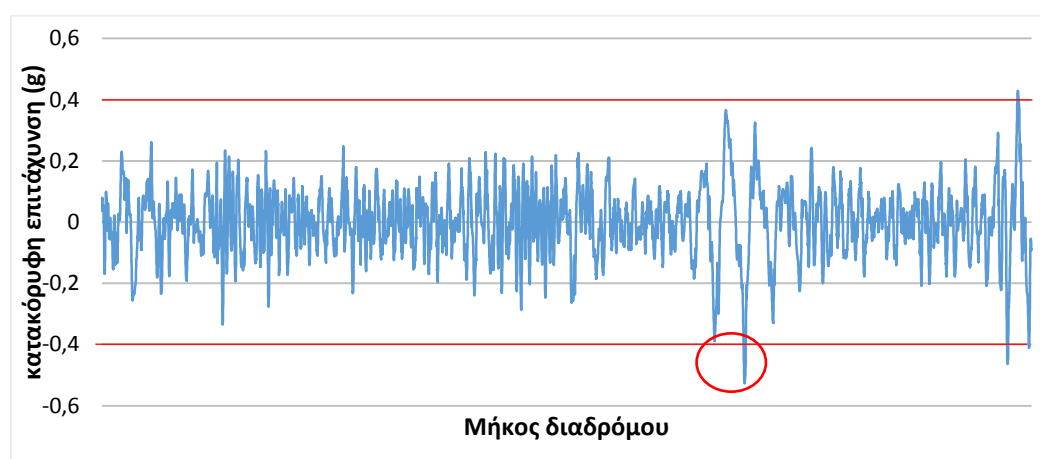
Εικόνα 4.12 Αποτελέσματα κατακόρυφης επιτάχυνσης στο πιλοτήριο του αεροσκάφους B727 για ταχύτητα 100 knots – δεξιό ίχνος
