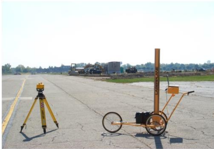
Εικόνα 2.8 Μέθοδος auto rod and level [16]
