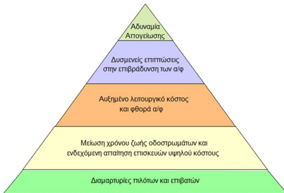
Εικόνα 2.3 Συνέπειες έλλειψης ομαλότητας στα οδοστρώματα αεροδρομίων [1]
