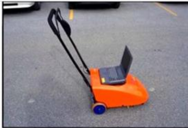
Εικόνα 2.10 Συσκευή Walking Profiler [23]
