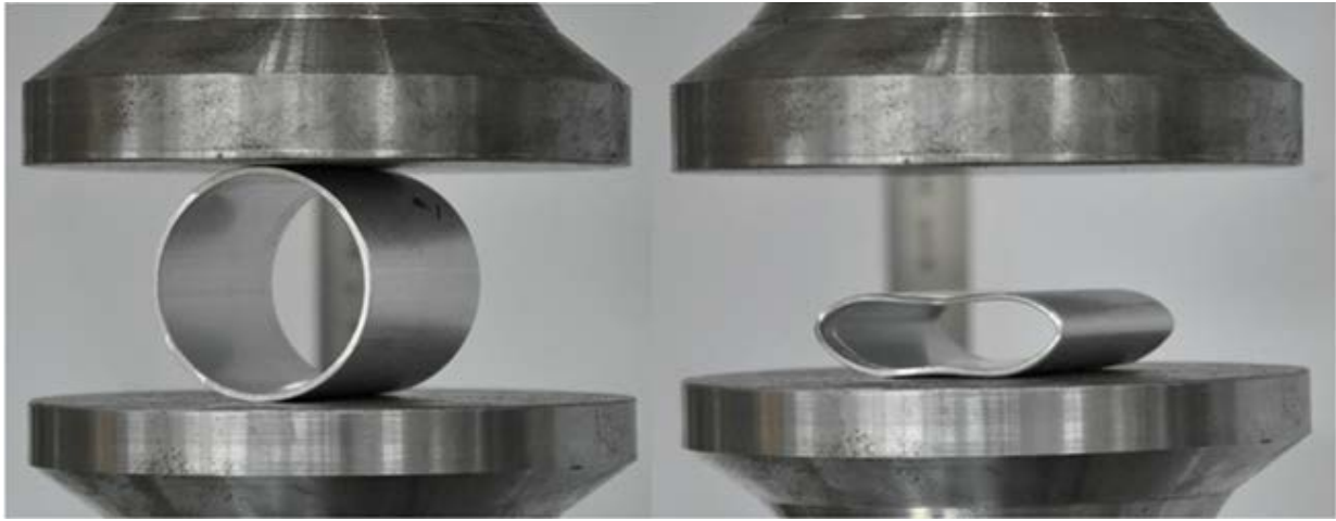
Εικόνα 1.8 Πειραματική δοκιμή πλευρικής φόρτισης κυκλικού σωλήνα πριν και μετά
