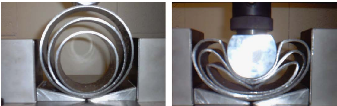
Εικόνα 2.6 Κατάρρευση ένθετων συστημάτων σωλήνων με πλευρικούς χωρικούς περιορισμούς.
