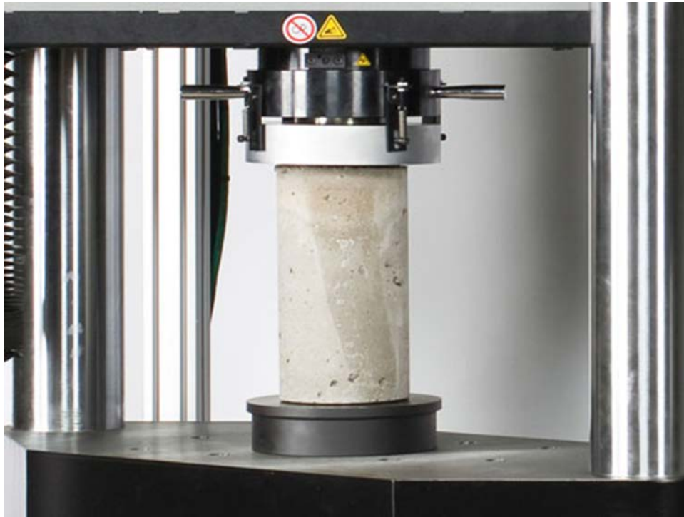
Εικόνα 1.7 Κυλινδρικό δοκίμιο φορτιζόμενο αξονικά
