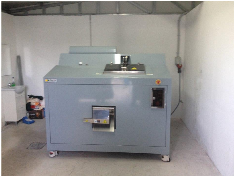
Εικόνα 6-1: Ο ξηραντήρας βιοαποβλήτων GC 300 που χρησιμοποιείται για την ξήρανση των οικιακών απορριμμάτων τροφίμων στον Δήμο Χαλανδρίου.
