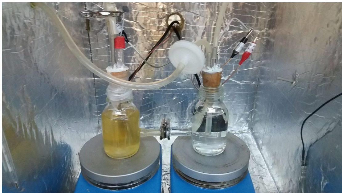
Εικόνα 7-1: : Φωτογραφία της MKK δύο θαλάμων (H – type) κατά την λειτουργία της με επεξεργασμένο και φιλτραρισμένο FORBI όπου φαίνονται ο ανοδικός και ο καθοδικός θάλαμος, η
