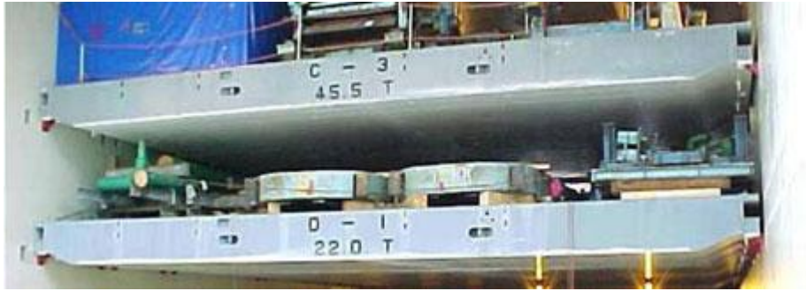
Εικόνα 2.9 - Καπάκια για τη δημιουργία καταστρωμάτων, όπου εξυπηρετούν φορτία που δεν μπορούν να στοιβαχτούν καθ' ύψος
