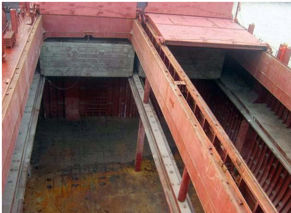
Εικόνα 2.13 - Πλοίο γενικού φορτίου, σχεδιασμένο με ανοιχτού τύπου στόμια διπλής διάταξης (twin hatch arrangement)
