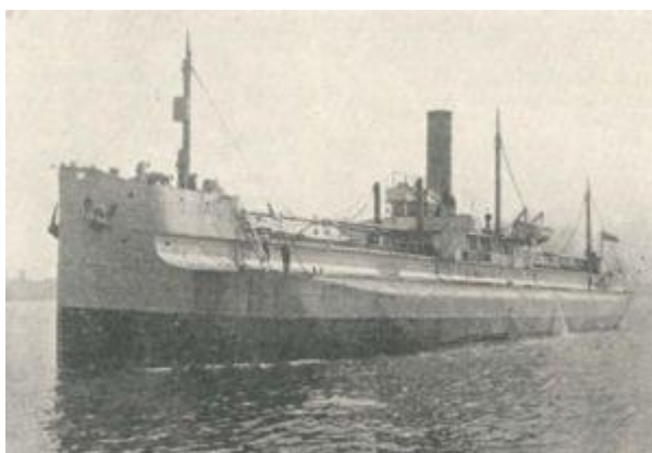
Εικόνα 2.26 - Χαρακτηριστική μορφή κάθετης πρόρας φορτηγού πλοίου που ναυπηγήθηκε τέλη του 19 ου αιώνα
