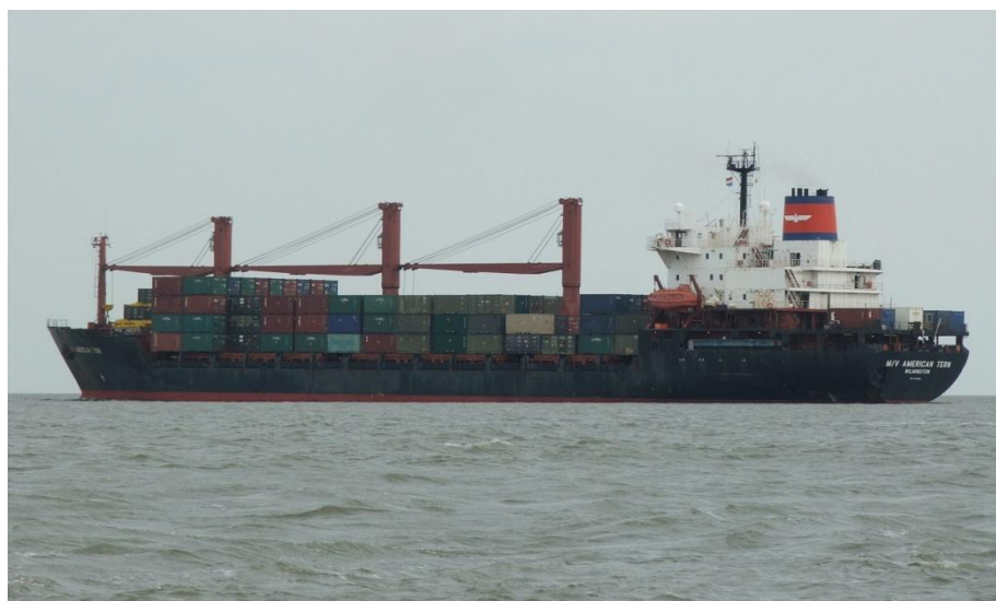
Εικόνα 1.3 - Πλοίο γενικού φορτίου με δεξαμενές και δυνατότητα παραλαβής εμπορευματοκιβωτίων
