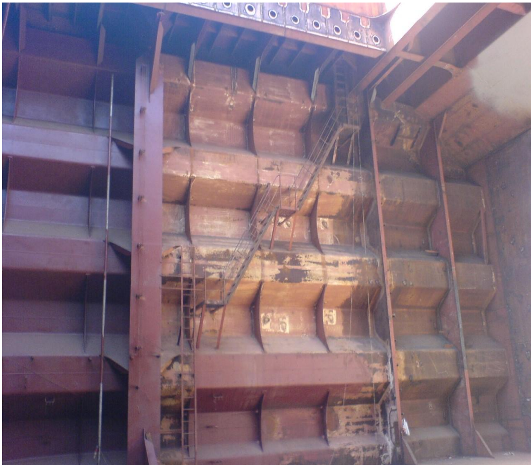
Εικόνα 5.20 - Φωτογραφία που απεικονίζει μη αποσπώμενες μεταλλικές σκάλες σε κύτος φορτηγού πλοίου
