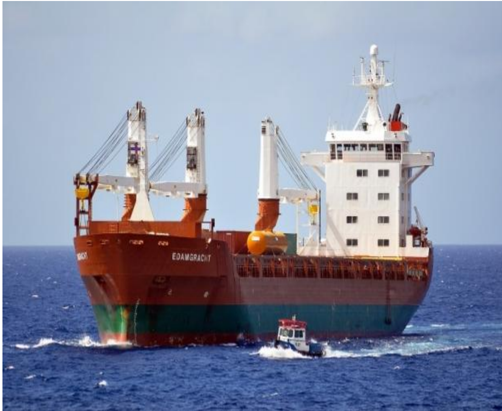
Εικόνα 1.4 - Πλοίο γενικού φορτίου με δεξαμενές για μεταφορά υγρών φορτίων
