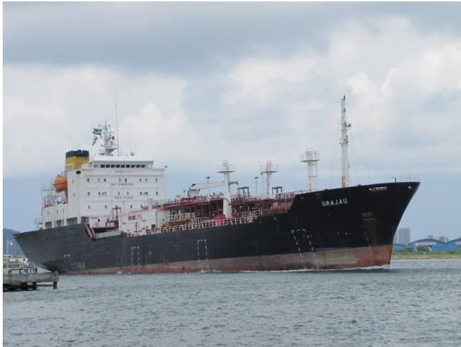
Εικόνα 2.27 - Πλοίο γενικού φορτίου με πλώρα μορφής άνωθεν της ισάλου προεξέχουσα ευθεία
