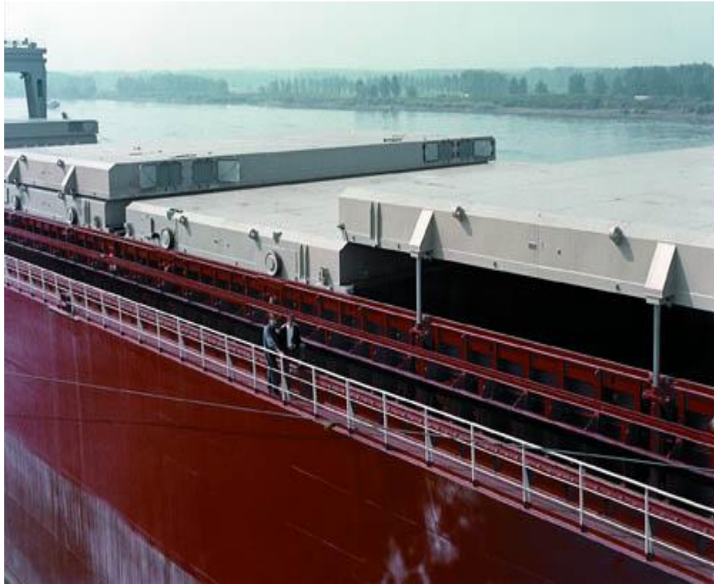
Εικόνα 5.11 - Κάλυμμα ανυψούμενο και κυλιόμενο (piggy-back)
