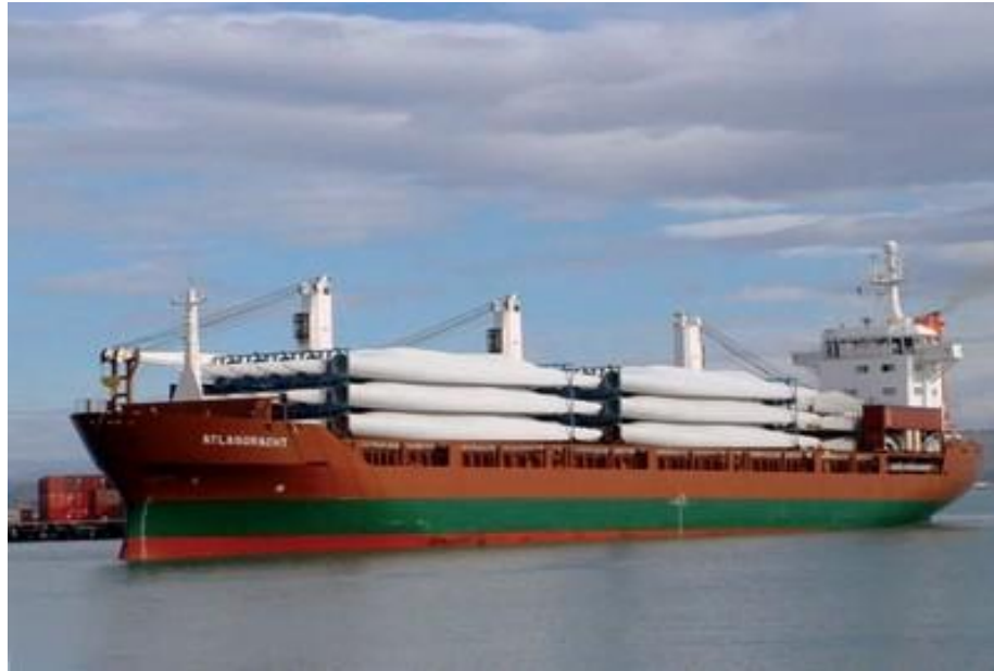
Εικόνα 1.7 - Πλοίο γενικού φορτίου για μεταφορά φορτίου στο κατάστρωμα
