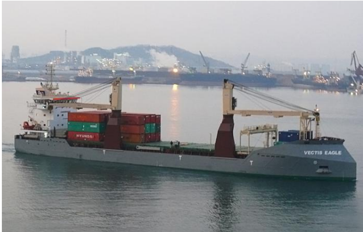
Εικόνα 2.10- Σύγχρονο πλοίο γενικού φορτίου με αδιαίρετο μονό κύτος 2 καταστρωμάτων 70μ, με συνολικό μήκος 110μ.
