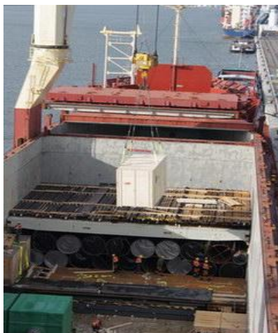
Εικόνα 2.11 - Κύτος πλοίου γενικού φορτίου με μέγιστο δυνατό πλάτος και μήκος.(open ship arrangement)
