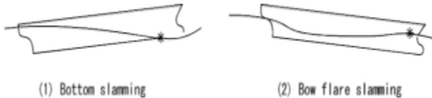
Εικόνα 4.6 - Είδη πρόσκρουσης slamming σε ένα πλοίο
