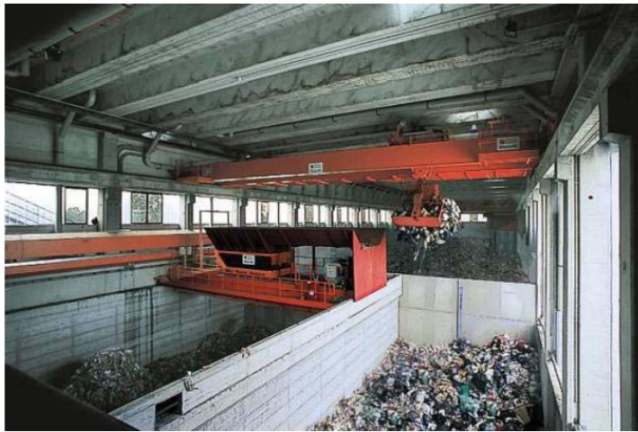
Εικόνα 3-1: Τμήμα Υποδοχής, Τεμαχισμού, Βιολογικής Ξήρανσης Απορριμμάτων (Πηγή: ΕΠΤΑ Ε.Π.Ε, 2010)
