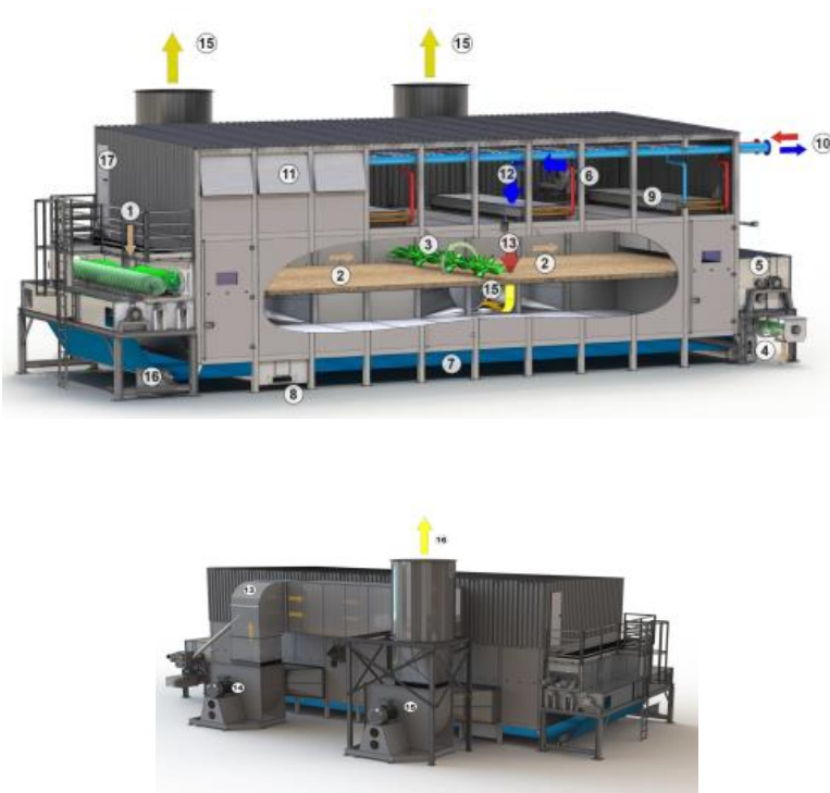
Σχήμα 4-4: Διάγραμμα Ροής Ξήρανσης με Ξηραντήρα Μεταφορικής Ταινίας (Πηγή: Stela)
