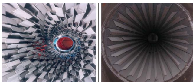
Εικόνα 3-6: Δύο διαφορετικές διαμορφώσεις των πτερυγίων που βρίσκονται εντός περιστρεφόμενου ξηραντήρα
