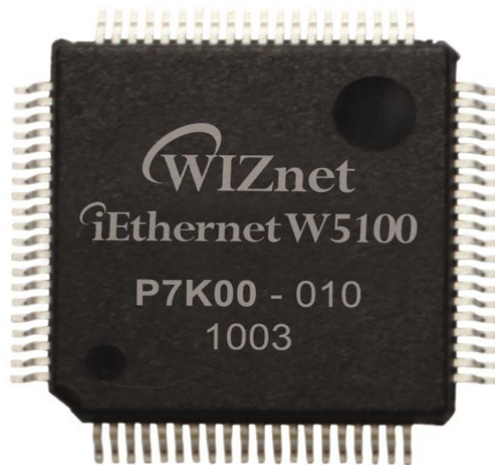
Εικόνα 2.7: Wiznet Ethernet W5100 chip
