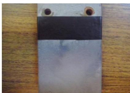
Σχήμα 5.7: Προετοιμασία επιφάνειας δοκιμίου πριν το πείραμα διάβρωσης
