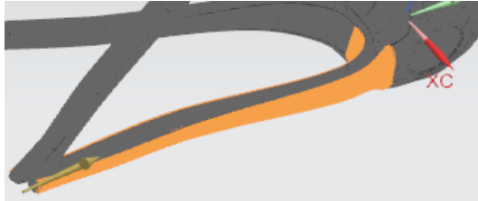
Εικόνα 100 τμήμα του chain stay που περιέχει και τις στρώσεις «αριστερά - δεξιά»
