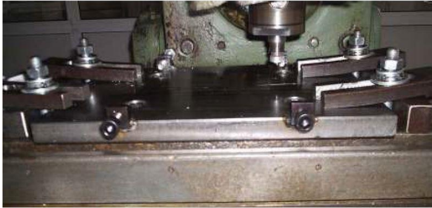
Εικόνα 9.1: (α) Διάταξη μηχανής FSP. (β) Τράπεζα της μηχανής FSP.
