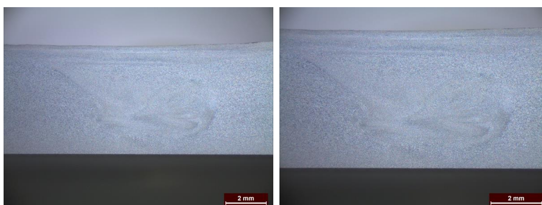
Εικ.10.1: Εικόνες στερεοσκοπικής ανάλυσης προδρόμου δοκιμίου παρασκευασμένου από FSPed κράμα AA5083 χωρίς διασπορά νανοκρυσταλλικής κεραμικής φάσης ενίσχυσης \gamma\text{-Al}_2\text{O}_3 και αφροποιοτικού παράγοντα \text{TiH}_2 . Πραγματοποιήθηκαν 2 περάσματα ενώ ταυτόχρονα επιβλήθηκε ρυθμός περιστροφής 1000 rpm και ταχύτητα πρόωσης 13 mm/min.
