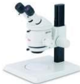
Εικ.9.7: Οπτικό στερεοσκόπιο Leica MZ6.
