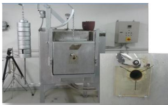
Εικ.9.6 : Επαγωγικός φούρνος με τερματικό πεδίο θερμοκρασιών στους 1200°C και μεγέθυνση στο πυρίμαχο γυαλί που είναι τοποθετημένο στη κεντρική οπή του φούρνου.
