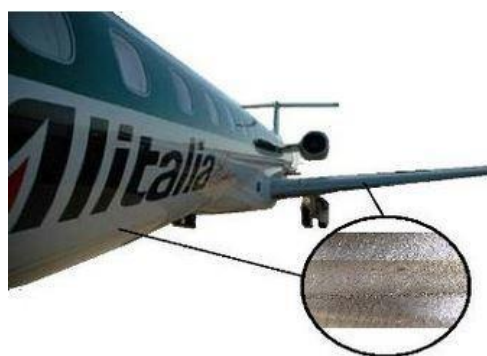
Εικ.4.26 Ανάπτυξη συγκόλλησης τύπου FSW προς κατασκευή κύριας δομικής ατράκτου και πλευρικών νευρώνων στήριξης σε φτερά επιβατικού αεροσκάφους [Gatwick Technologies].
