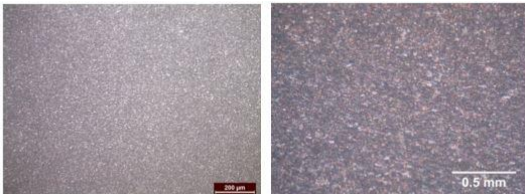
Εικ.10.44: Μικρογραφική δομή (a) Ζώνη ανάδευση , (b) Θερμομηχανικά επηρεασμένη ζώνη, σε πρόδρομο FSPed δοκίμιο, όπου έχει εισαχθεί μίγμα αφροποιητικού παράγοντα και ενισχυτικής φάσης παρένθεσης, έπειτα από την επενέργεια 3 περασμάτων.
