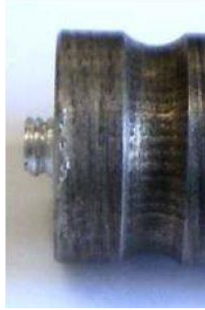
Εικ.9.5 : Περιαιχένιο και κυλινδρικός πείρος με σπείρωμα.
