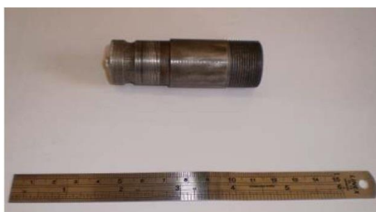
Εικ.9.4 : Εργαλείο με κυλινδρικό πείρο και δεξιόστροφο σπείρωμα.
