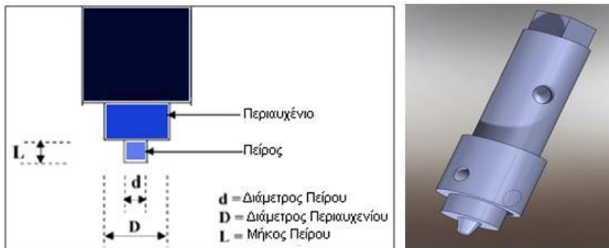
Εικ.4.4 Σχηματική αναπαράσταση συστήματος εργαλειομηχανής FSW .
