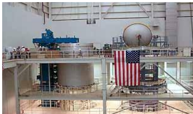
Εικ.4.2 Εφαρμογή της τεχνικής Friction Stir Welding σε πυρήνες δεξαμεμών καυσίμων (υδρογόνου-οξυγόνου σε υγρή φάση) που προορίζεται για τους προωθητικούς πυραύλους μήκους 42m της Boeing. [102]
