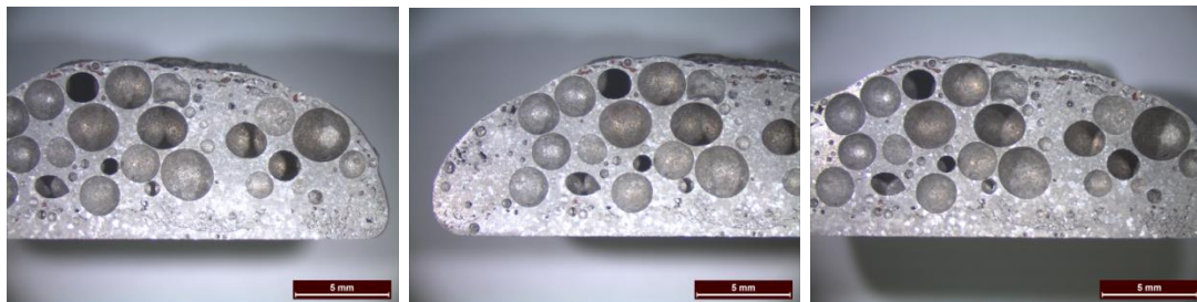
Εικ.10.27:Μεταλλικός αφρός παρασκευασμένος από πρόδρομο FSPed δοκίμιο κράματος AA5083 με διασπορά νανοκρυσταλλικής κεραμικής φάσης παρένθεσης \gamma\text{-Al}_2\text{O}_3 και ανάπτυξη 3 περασμάτων. Ακολούθησε επενέργεια θερμικής κατεργασίας αφροποίησης στους 750°C με χρονική διάρκεια παραμονής 3.5 min σε προθερμασμένη πλάκα έδρασης στους 750°C.
