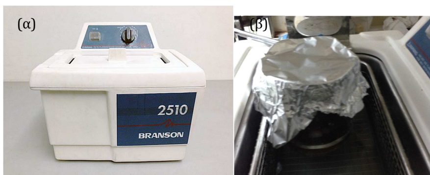
Σχήμα 7.6 (α) Συσκευή λουτρού υπερήχων (β) διασπορά περλίτη στο λουτρό υπερήχων
