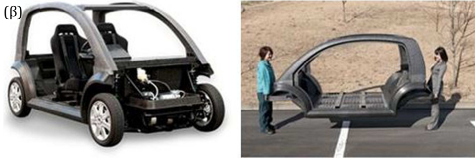
Σχήμα 2.19 Εφαρμογές ινών άνθρακα στην αυτοκινητοβιομηχανία (α) ζάντα αυτοκινήτου από ύφασμα ινών άνθρακα (β) σκελετός αυτοκινήτου από ίνες άνθρακα[40]
