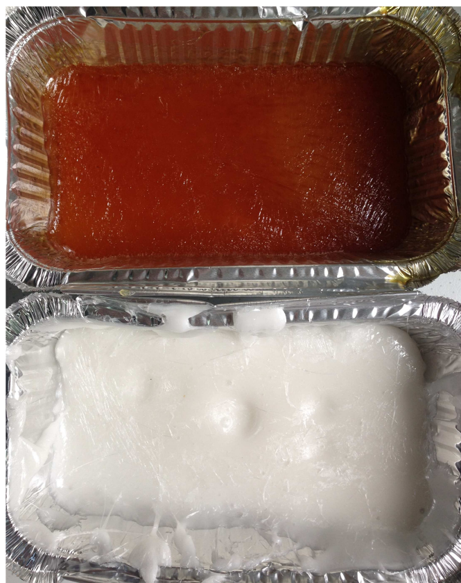
Σχήμα 6.10 Προϊόν όταν αποχύνεται από τον αντιδραστήρα πάνω ρεζόλη κάτω νεολάκη
