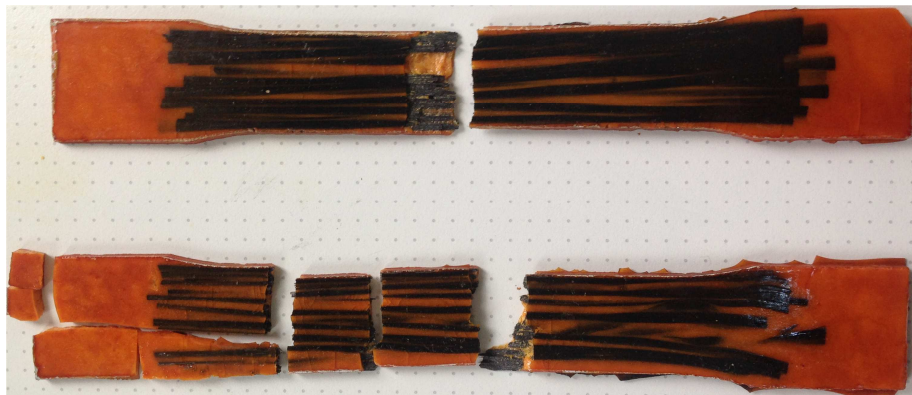
Σχήμα 9.7 Δοκίμια ρεζίτη με ίνες άνθρακα (R- CF7.5) μετά από δοκιμή σε κάμψη και διάτμηση
