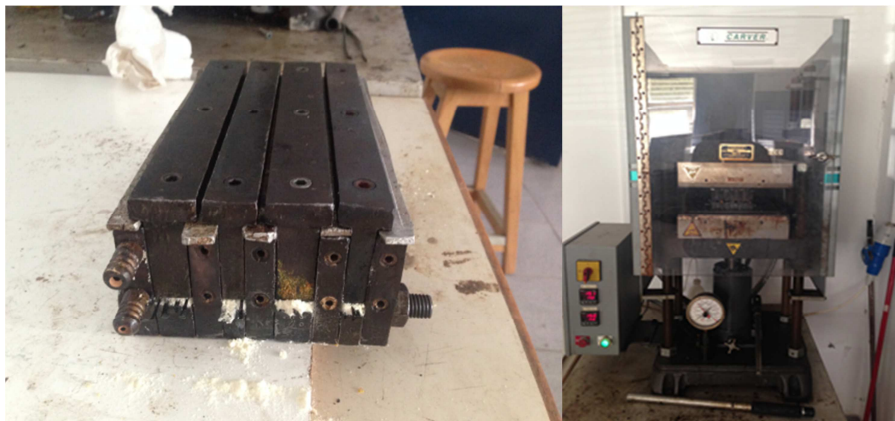
Σχήμα 7.3 Καλούπι ανοιχτού τύπου και θερμοπρέσσα, τα οποία χρησιμοποιήθηκαν για την κατασκευή των συνθέτων υλικών νεολάκης ινών - άνθρακα.
