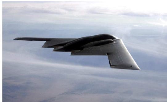
Σχήμα 2.20 Μαχητικό αεροπλάνο τύπου Stealth η δομή του είναι κατασκευασμένη από υφάσματα ινών άνθρακα[41]
