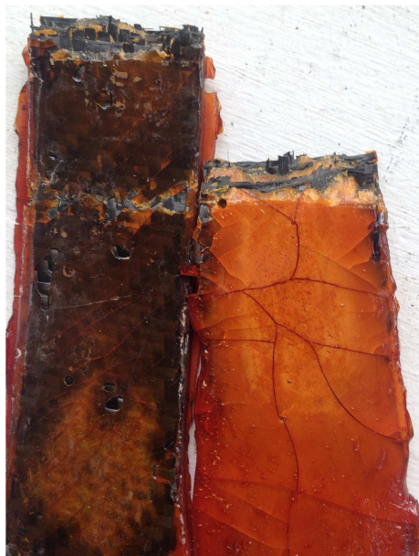
Σχήμα 9.9 Δοκίμιο ρεζίτη με ύφασμα ινών άνθρακα και περλίτη (R-P10-CFS) μετά από δοκιμή σε διάτμηση
