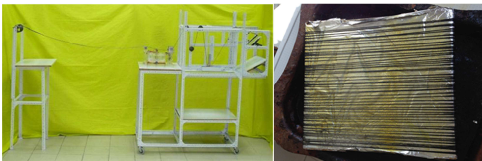
Σχήμα 7.1 Διάταξη προδιαπότισης των ινών άνθρακα με το υλικό της μήτρας (νεολάκη/σκληρυντή HEXA και ρεζόλη) και πλάκα περιτύλιξης των προδιαποτισμένων ινών άνθρακα
