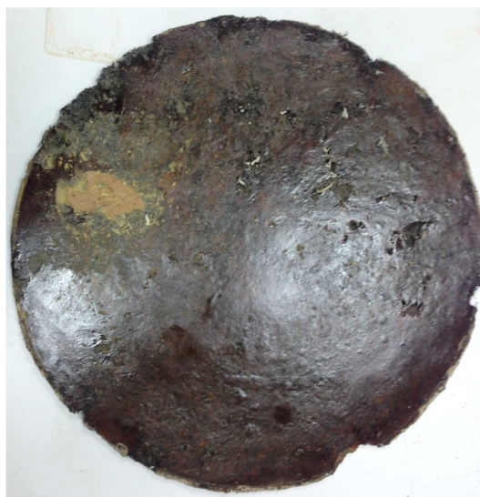
Σχήμα 7.10 Δοκίμιο συνθέτου υλικού ρεζίτη με κοντές ίνες άνθρακα και περλίτη για την μέτρηση της θερμικής αγωγιμότητάς του
