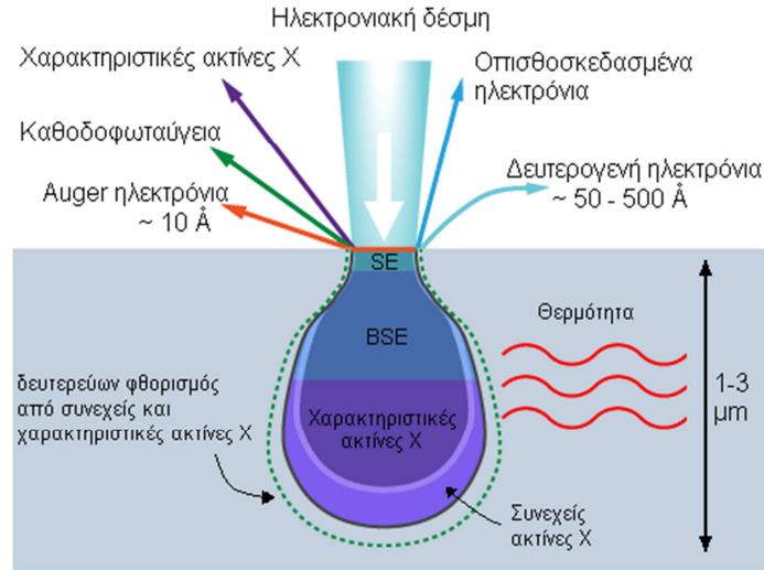
Σχήμα 8.5 Διάχυση δέσμης ηλεκτρονίων στην επιφάνεια υλικού
